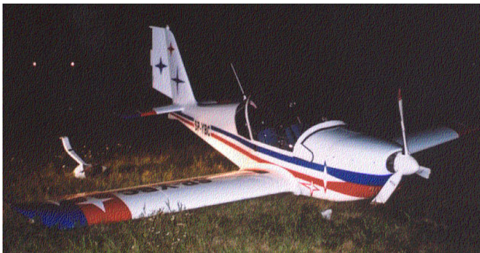
Fot.6 – Ogólny widok samolotu po wypadku, prawa strona; widać wyłamane podwozie główne.
