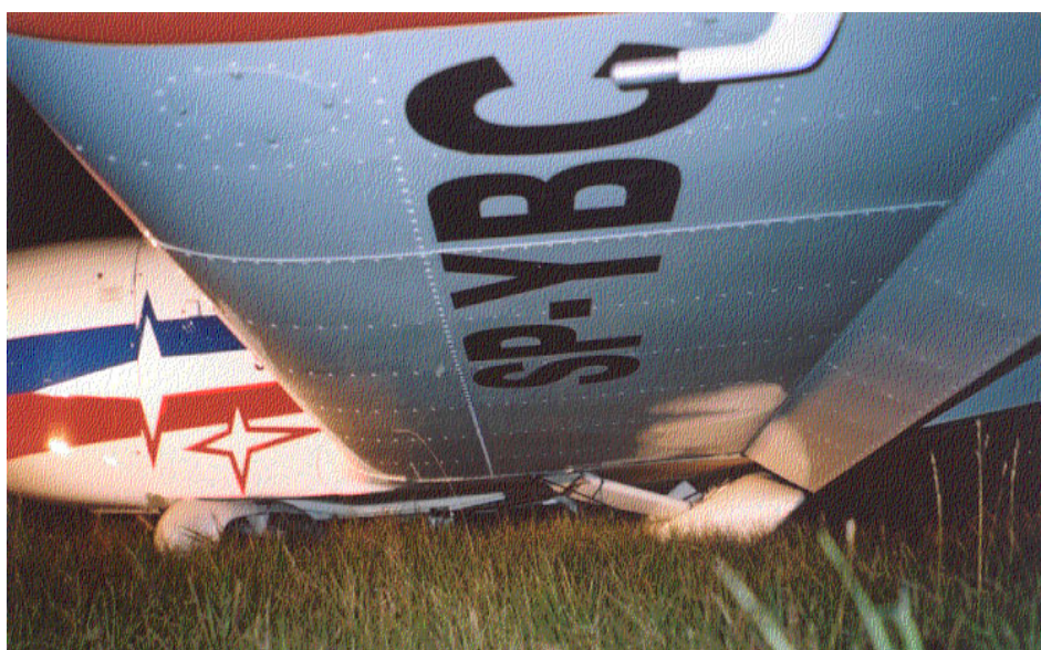
Fot.10 – Widok z lewej strony pod skrzydłem – widoczne wyłamane podwozie.
