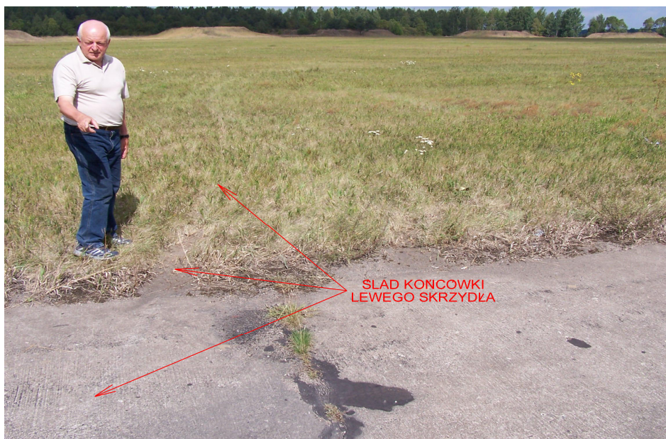
Fot.4 – Ślad końcówki lewego skrzydła na granicy beton-trawa (dzień po wypadku).
