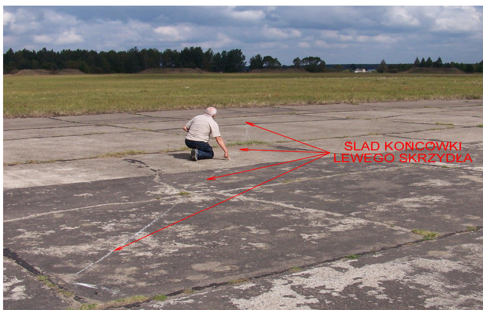
Fot.3 – Ślad końcówki lewego skrzydła na pasie startowym (dzień po wypadku).
