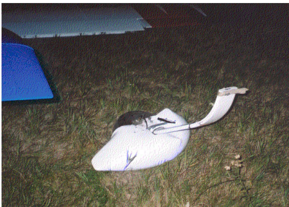
Fot.13 – Zbliżenie na wyłamane prawe podwozie główne.
