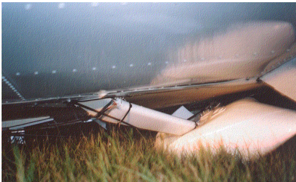
Fot.12 – Zbliżenie na wyłamane lewe podwozie główne.
