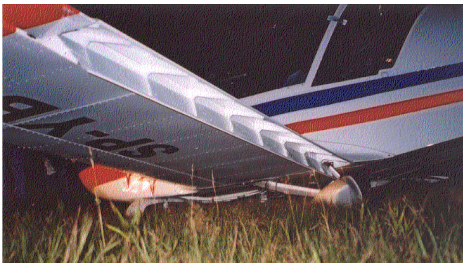
Fot.8 – Widok z lewej strony pod skrzydło – widoczne wyłamane podwozie.
