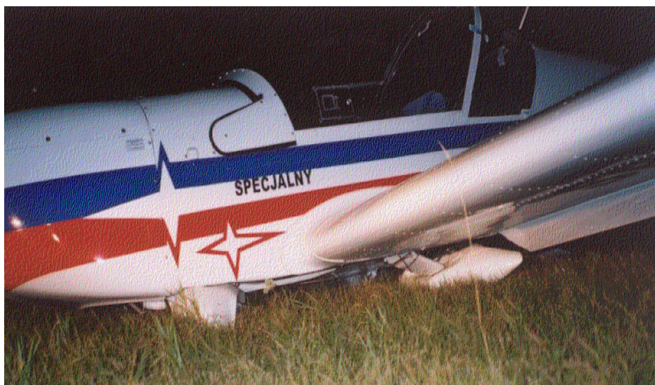
Fot.9 – Widok z lewej strony – widoczne wyłamane podwozie.
