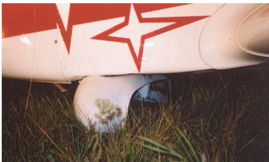
Fot.11 – Zbliżenie na wyłamane podwozie przednie.
