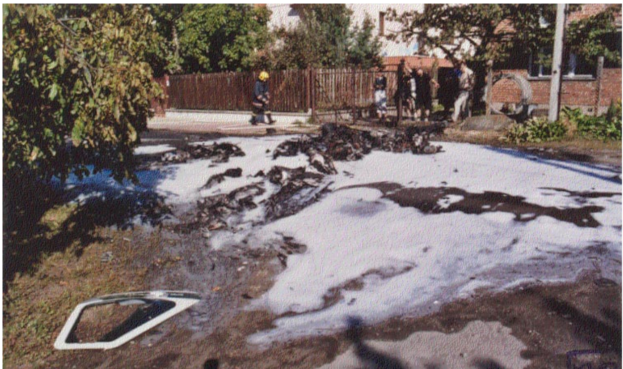
Fot.6 - Szczątki samolotu po ugaszeniu pożaru, widać oderwane lewe drzwi kabiny.
