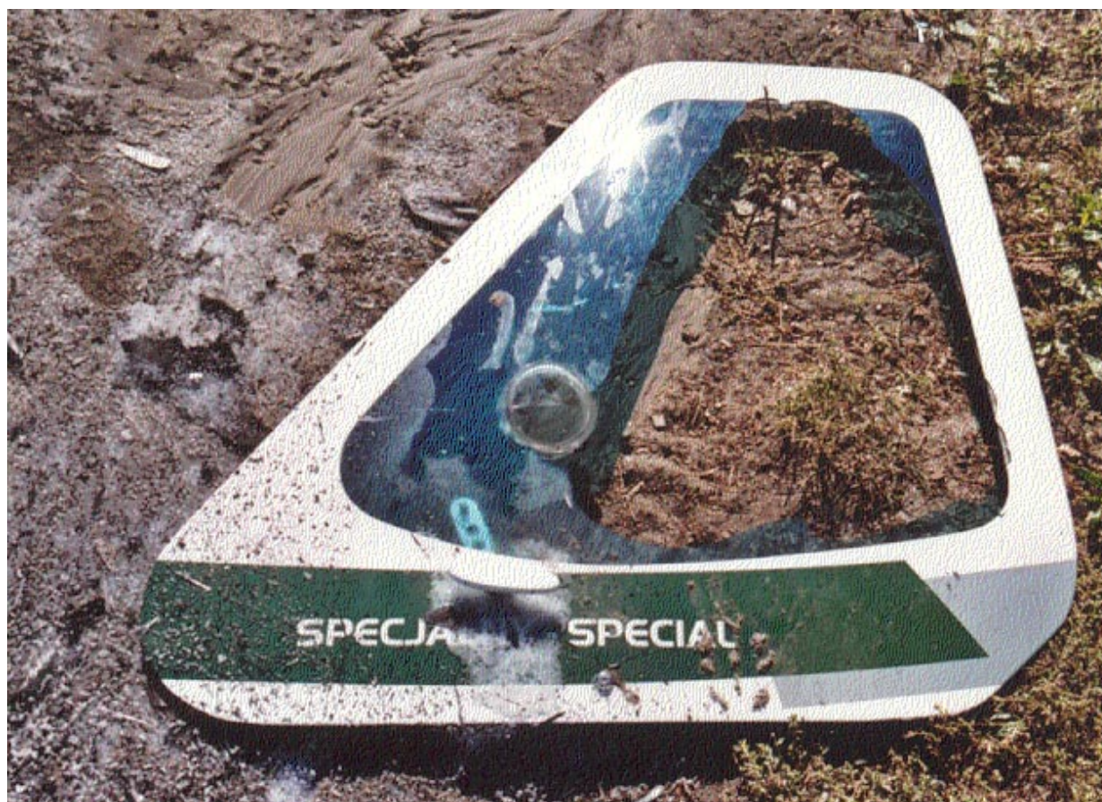
Fot.7 – Oderwane lewe drzwi kabiny.
