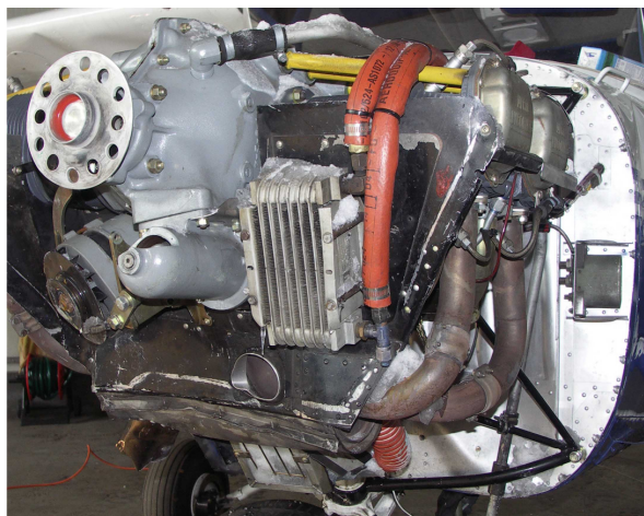
Fot.14 i 15 – Uszkodzenia zespołu napędowego (widoczne kolektory spalin i nagrzewnica, oderwany alternator, pognięte łożo silnika, zdeformowana ściana ogniowa kadłuba, brak śmigła i koła zębatego rozrusznika).
