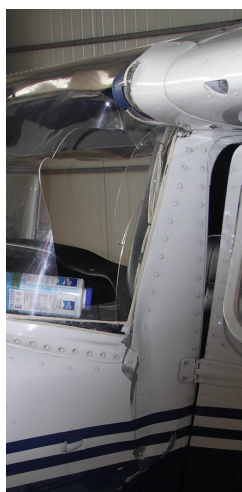
Fot.12 i 13 – Uszkodzenia (deformacje) struktury przedniej części kadłuba w rejonie wręgi mocowania dźwigara głównego i zastrzałów skrzydeł, zniszczone oszklenie wiatrochronu.
