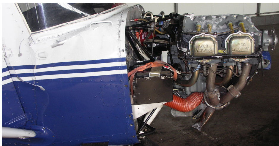
Fot.12 i 13 – Uszkodzenia (deformacje) struktury przedniej części kadłuba w rejonie wręgi mocowania dźwigara głównego i zastrzałów skrzydeł, zniszczone oszklenie wiatrochronu.
