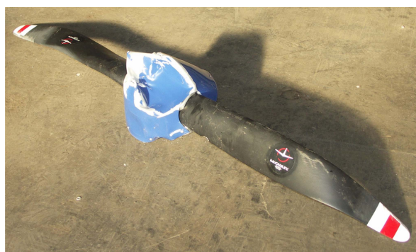
Fot.19 i 20 – Śmigło, wraz z kołpakiem oderwane i zniszczone w wyniku wypadku.
