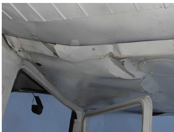
Fot.8 i 9 – Uszkodzenia prawej kłapy i dolnego pokrycia u nasady prawego skrzydła.
