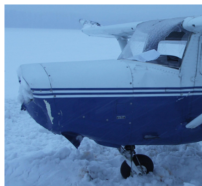
Fot.5, 6 i 7 – Uszkodzenia przedniej części kadłuba, osłon silnika i podwozia przedniego.
