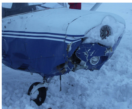
Fot.5, 6 i 7 – Uszkodzenia przedniej części kadłuba, osłon silnika i podwozia przedniego.
