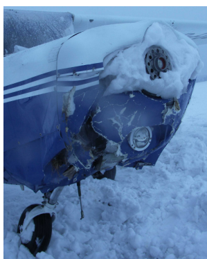
Fot.5, 6 i 7 – Uszkodzenia przedniej części kadłuba, osłon silnika i podwozia przedniego.
