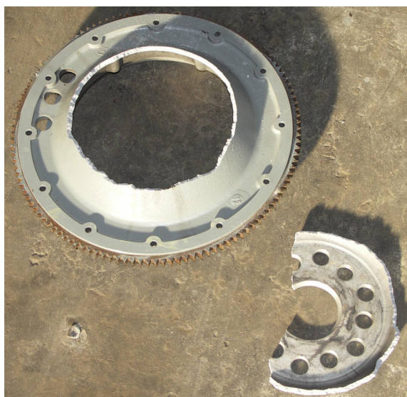
Fot.17 i 18 – Koło zębate rozrusznika, zniszczone w wyniku wyłamywania śmigła.
