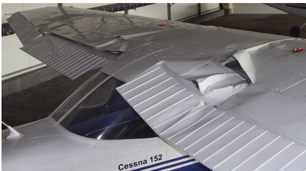
Fot.11 – Uszkodzenia górnego pokrycia skrzydeł u nasady; widoczna uszkodzona prawa kłapa.
