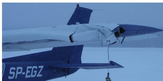
Fot.4 – Uszkodzona końcówka lewego skrzydła.
