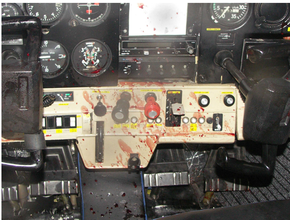
Fot.21 – Wnętrze kabiny – tablica przyrządów; na tablicy wyraźnie widoczne skutki nie zapięcia pasów barkowych przez załogę.
