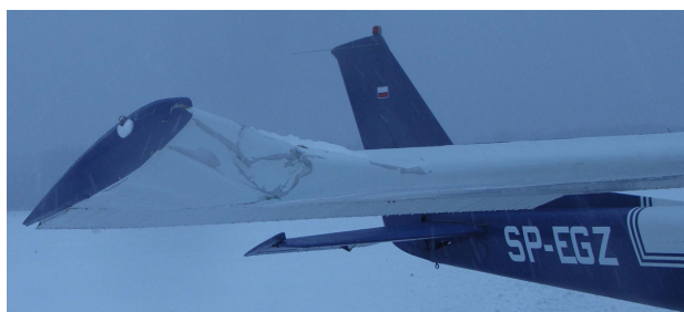
Fot.3 – Uszkodzona końcówka prawego skrzydła.
