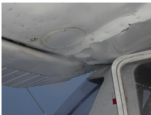
Fot.8 i 9 – Uszkodzenia prawej kłapy i dolnego pokrycia u nasady prawego skrzydła.
