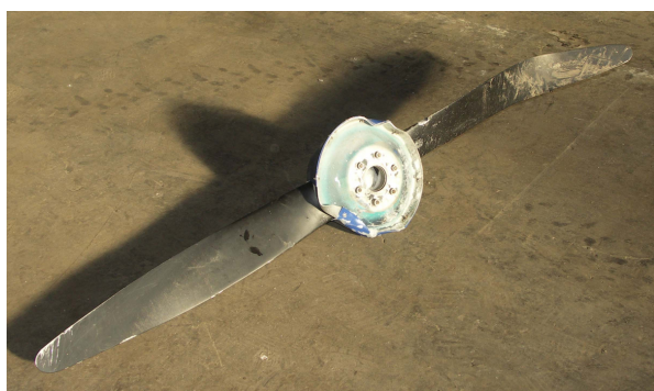
Fot.19 i 20 – Śmigło, wraz z kołpakiem oderwane i zniszczone w wyniku wypadku.
