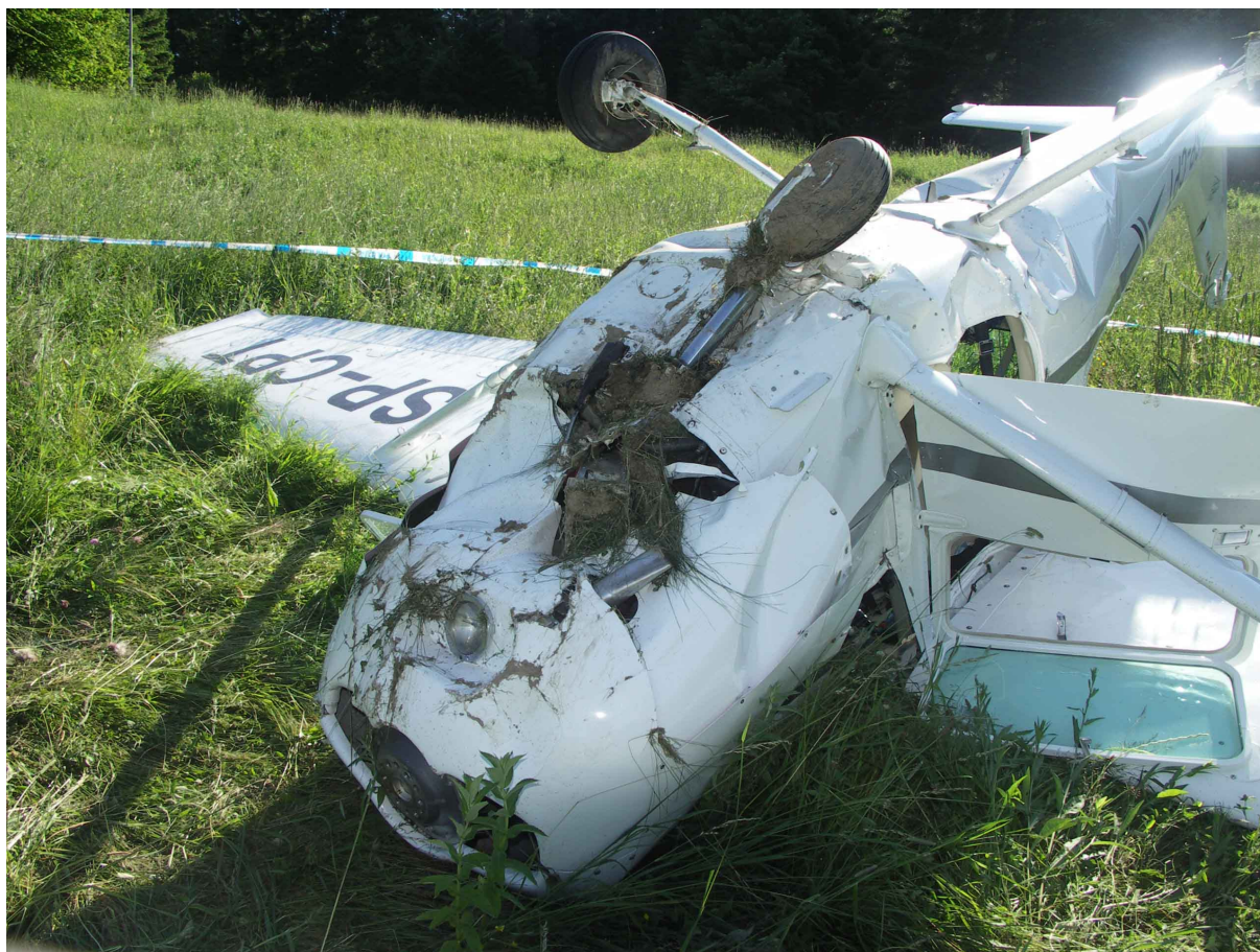
17 – Rozbity samolot – część przednia z prawej strony. Widoczne złamane podwozie przednie i uszkodzenia spodu kadłuba.
