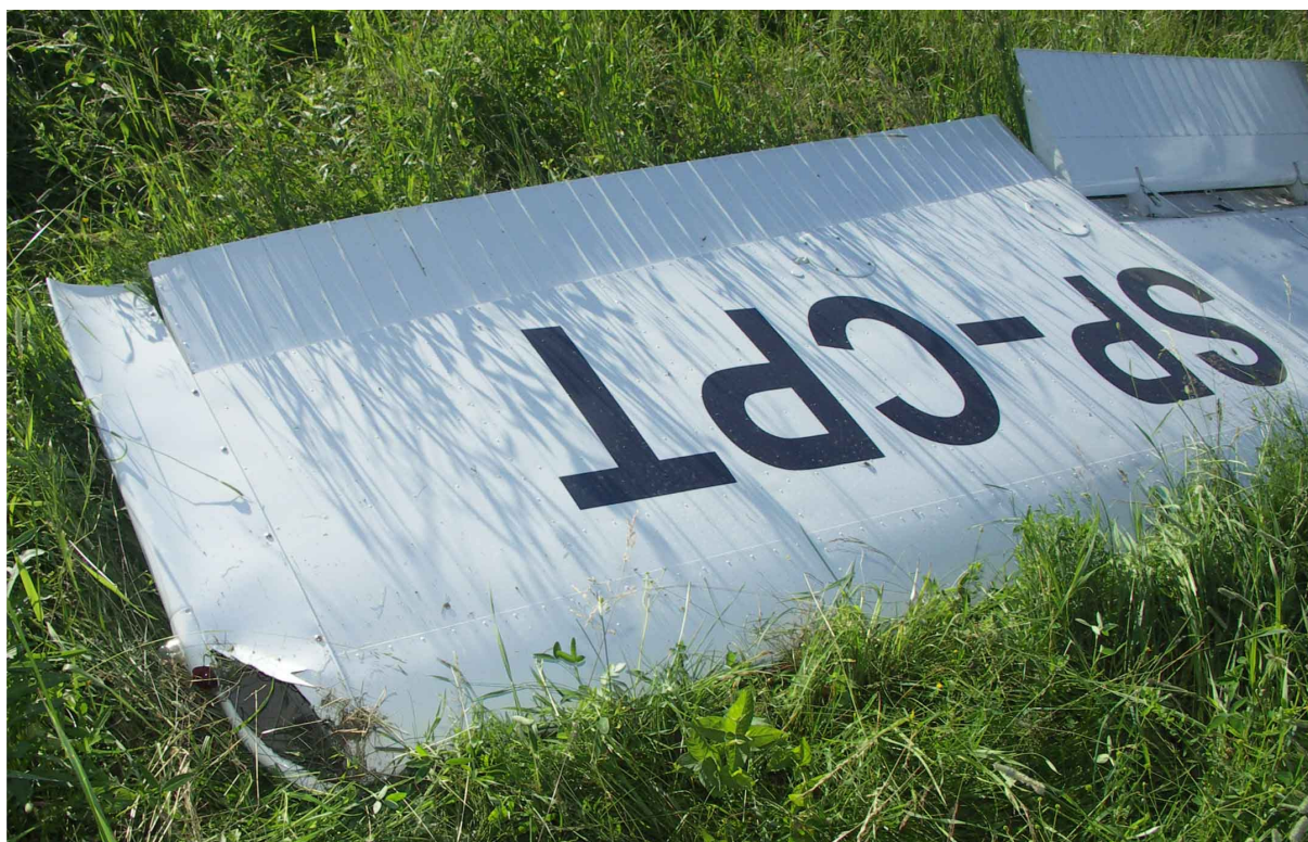
24 – Uszkodzenia końcówki lewego skrzydła.
