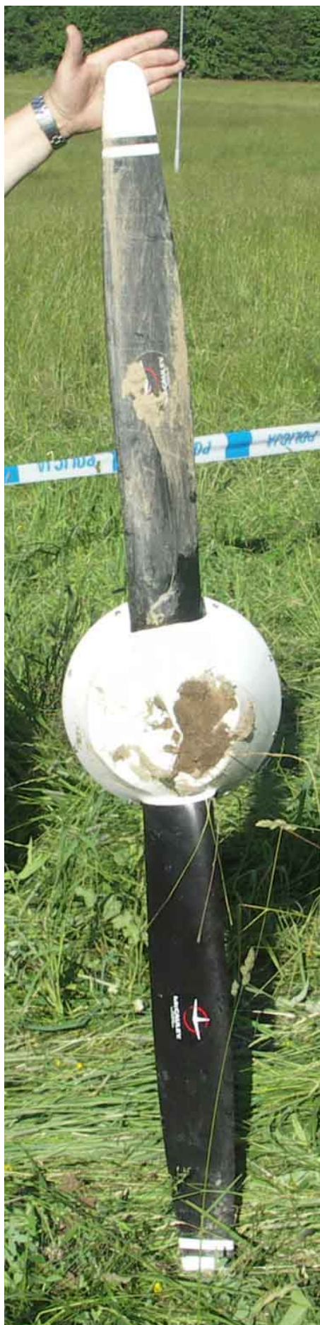
28 i 29 – Śmigło z kołpakiem oderwane od kołnierza wału silnika, widok od przodu (po lewej) i od tyłu (po prawej).
