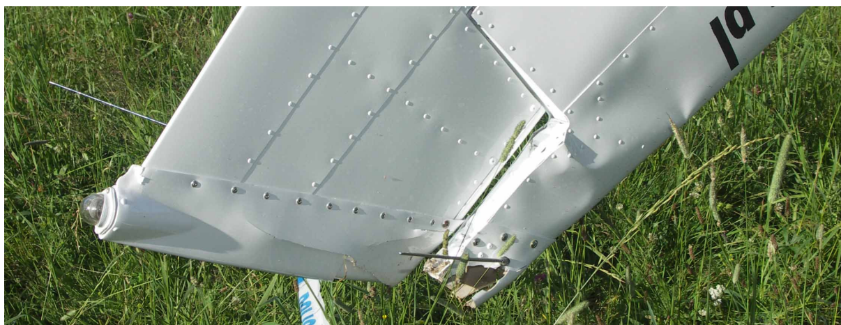
27 – Uszkodzona końcówka steru kierunku i statecznika pionowego.
