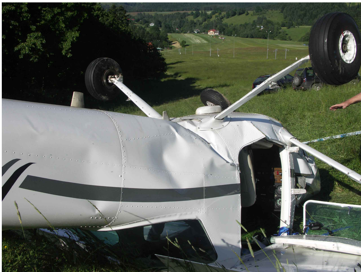
23 – Uszkodzenia kadłuba – widok \frac{3}{4} od tyłu z lewej strony.
