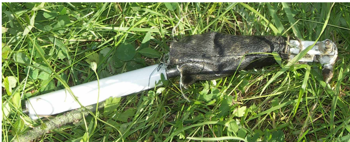
30 – Element sterowania podwoziem przednim, oderwany od samolotu.
