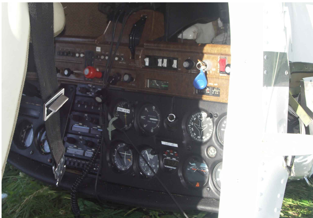
33 – Wnętrze kabiny – widoczne położenie kluczyka w stacyjce.
