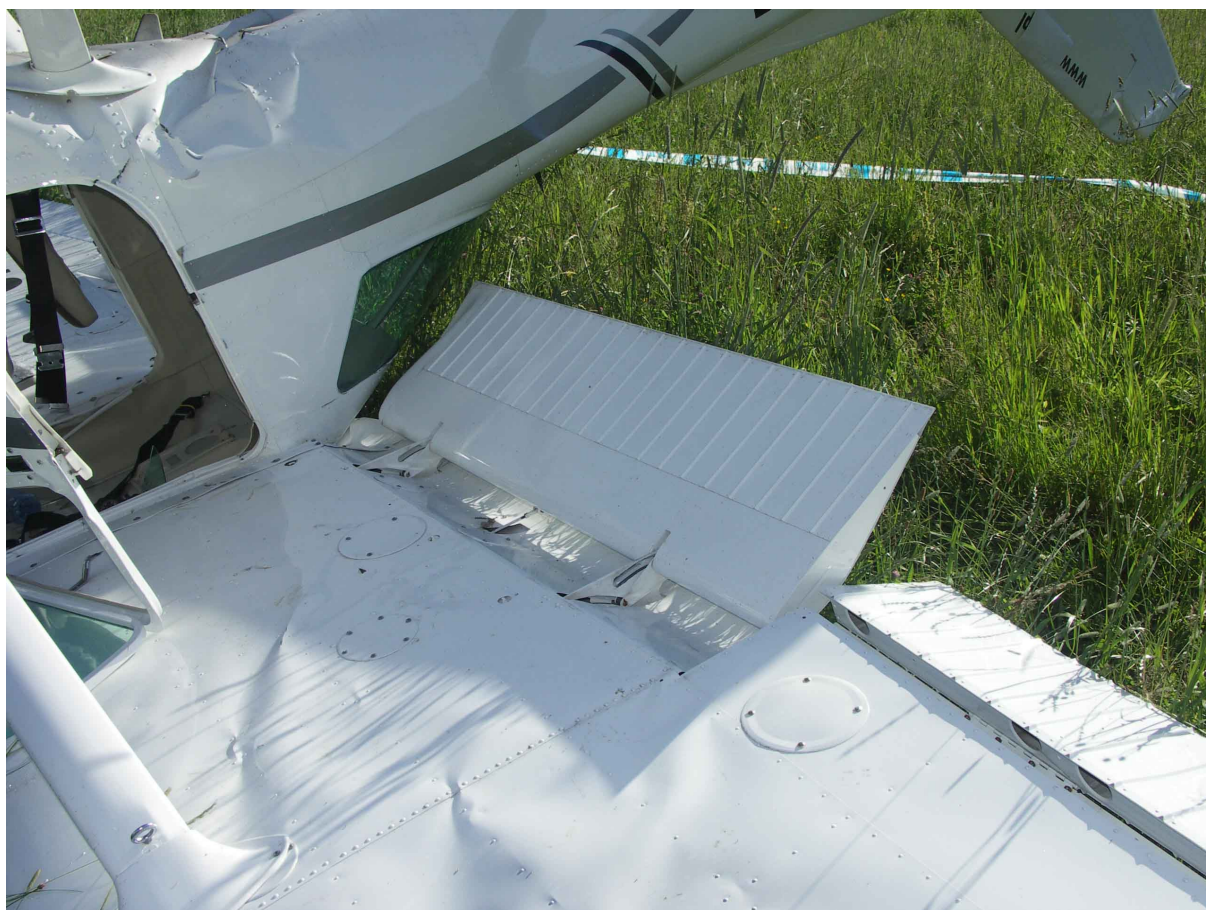
18 – Uszkodzenia kadłuba za kabiną z prawej strony i dolnej powierzchni prawego skrzydła.
