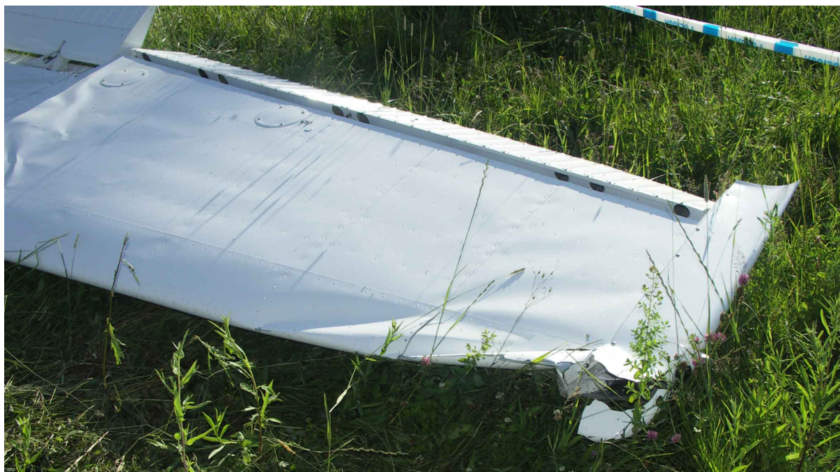
25 – Uszkodzenia końcówki prawego skrzydła.
