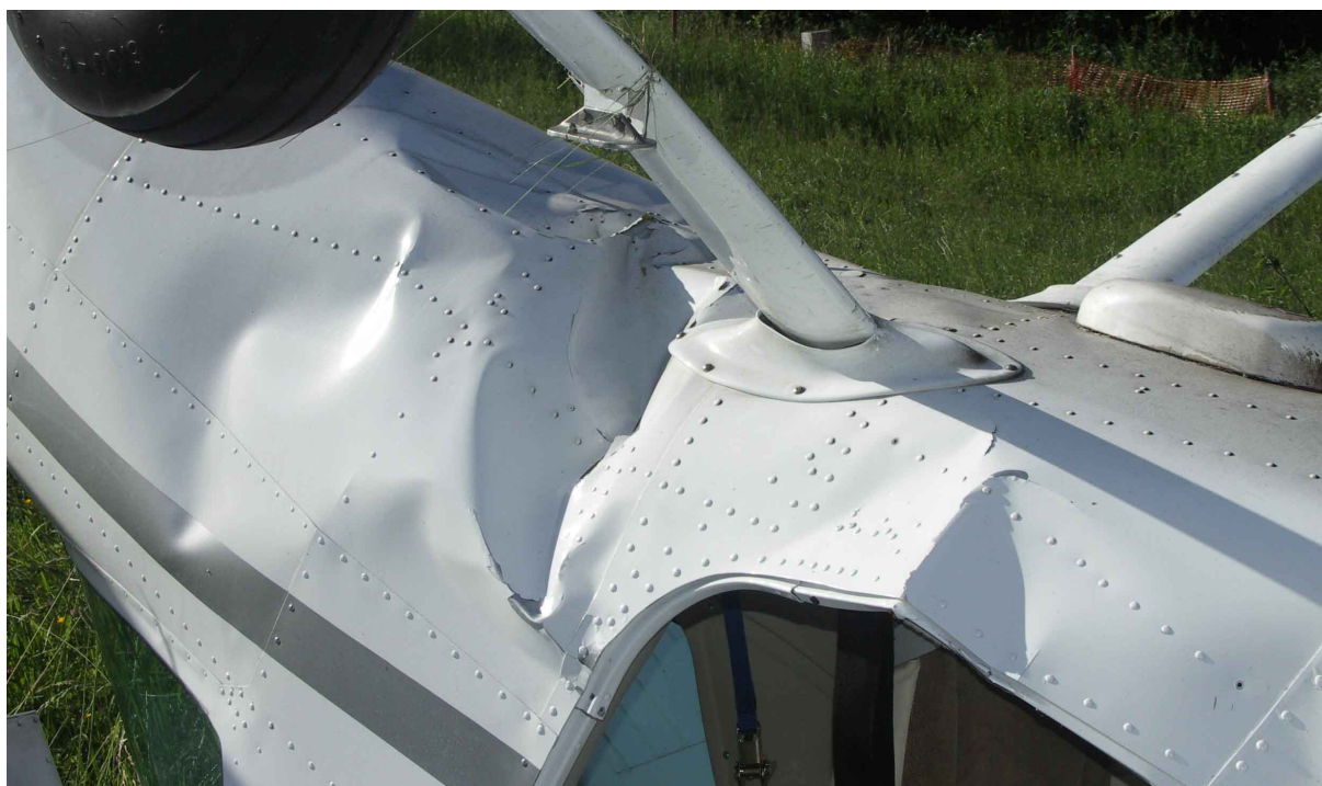
22 – Uszkodzenia spodu kadłuba za kabiną, widok z lewej strony.
