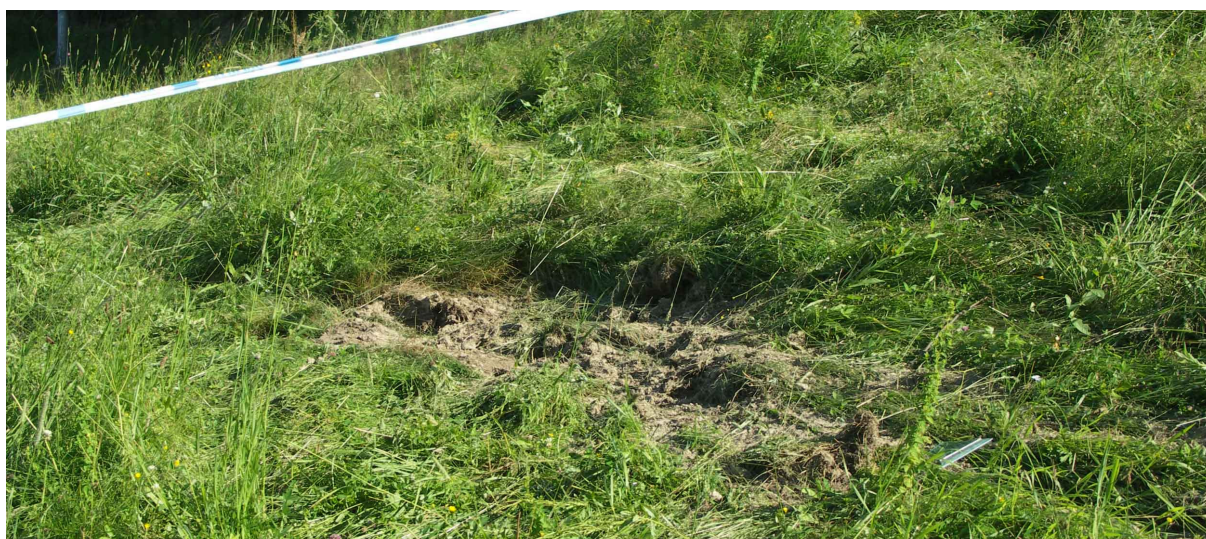
15 – Pierwszy ślad uderzenia przednim podwoziem o ziemię.
