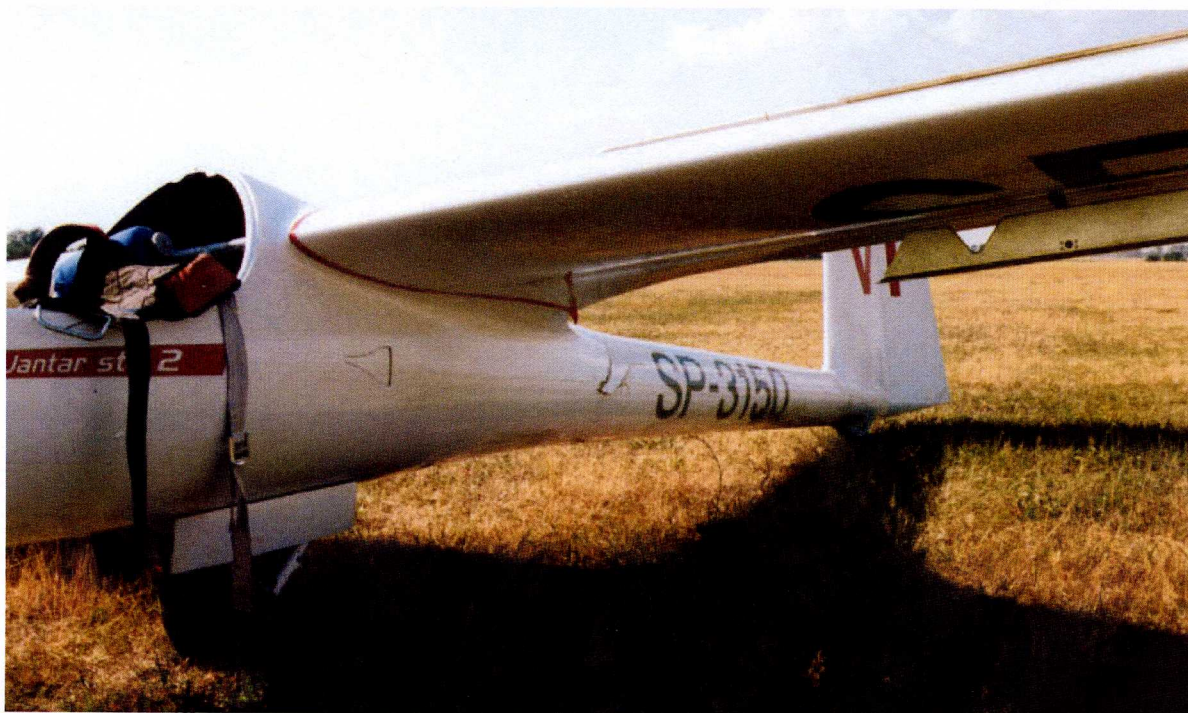
15 – Ogólny widok kadłuba z lewej strony, widoczne pęknięcie skorupy za skrzydłem.
