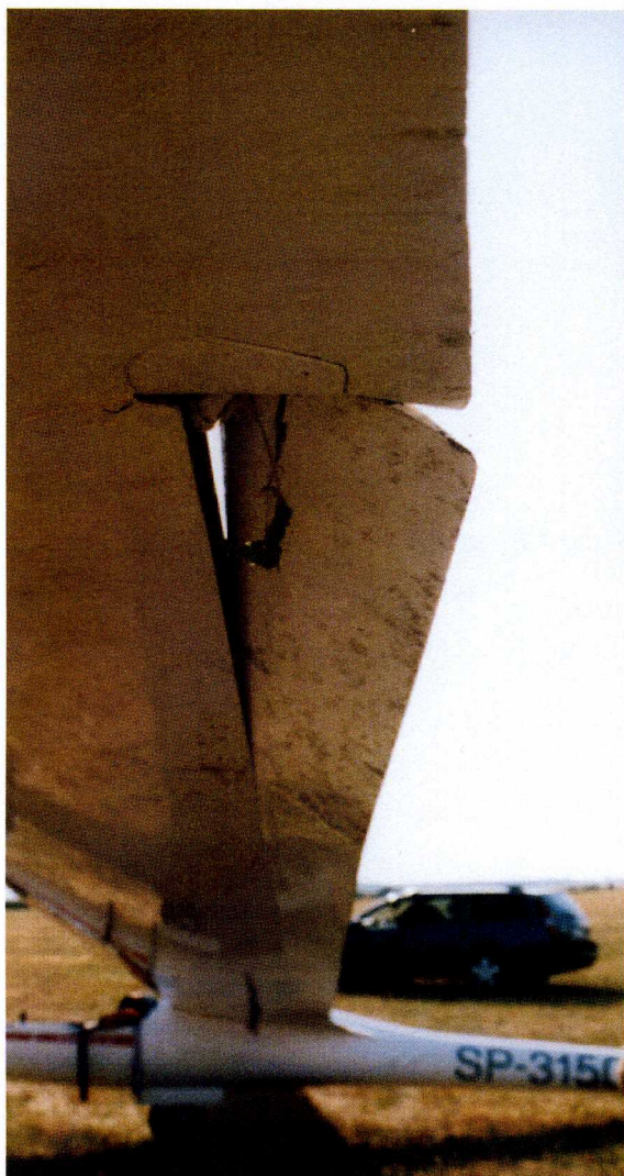
21 i 22 – Końcówka lewego skrzydła z dołu i z góry, widoczne uszkodzenia dolnego pokrycia i złamanie lotki.
