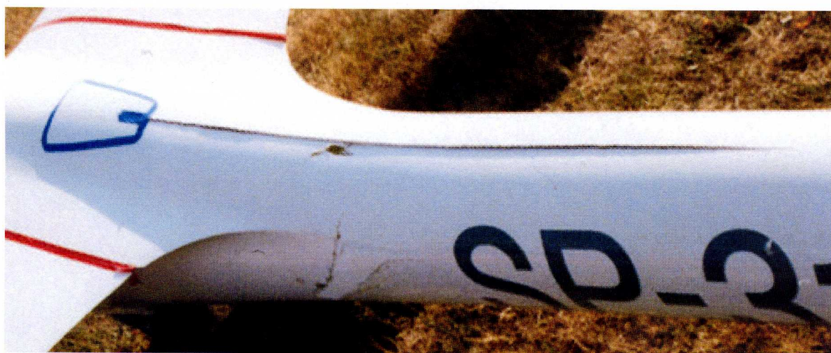
16 – Rozklejenie belki kadłuba na grzbiecie i pęknięcie lewej skorupy kadłuba za skrzydłem.
