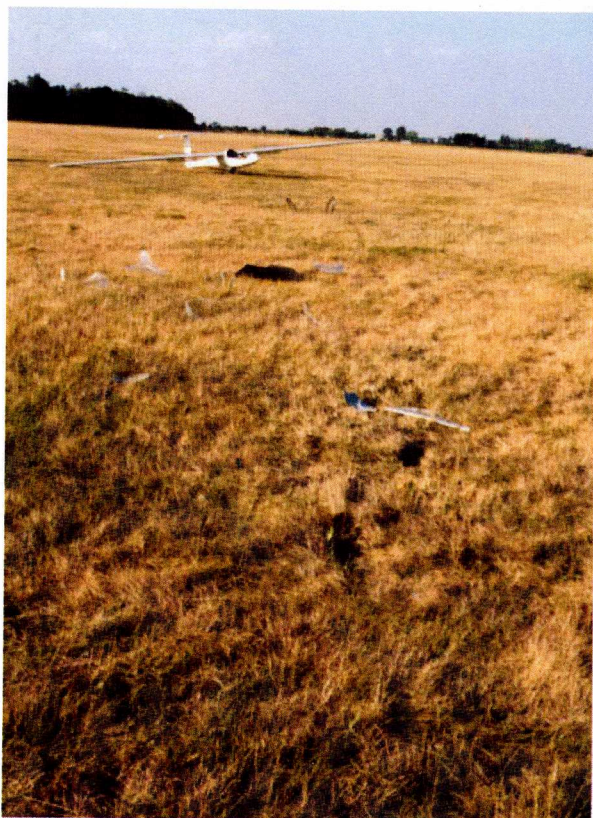
4 i 5 – Ślady przyziemienia i szlak szczątków rozbitego szybowca, na pierwszym planie ślad odbicia kadłuba, fragment oszklenia i odłamek skorupy kadłuba.
