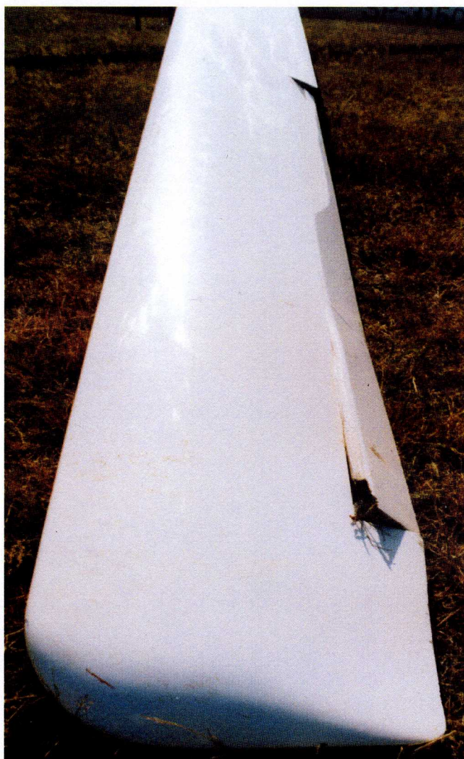
21 i 22 – Końcówka lewego skrzydła z dołu i z góry, widoczne uszkodzenia dolnego pokrycia i złamanie lotki.
