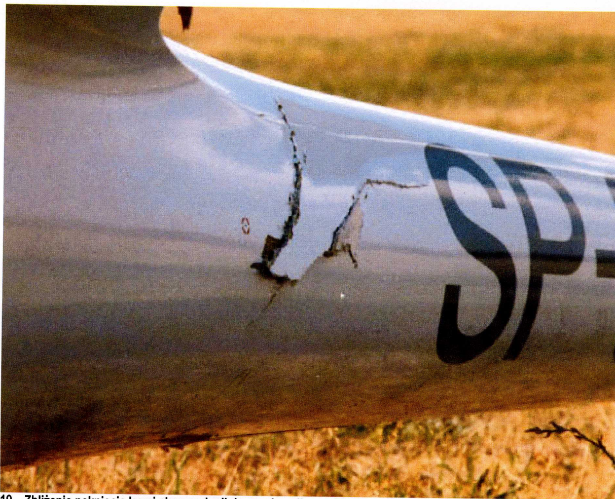
19 – Zbliżenie pęknięcia lewej skorupy kadłuba za skrzydłem, widoczne uszkodzenia na spodzie belki kadłubowej.
