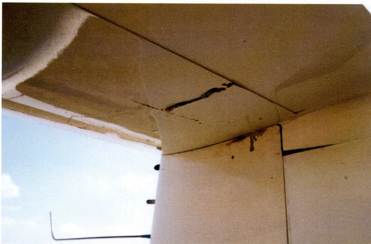
24 – Usterzenie z lewej strony od spodu – widoczne uszkodzenia stateczników poziomego i pionowego.
