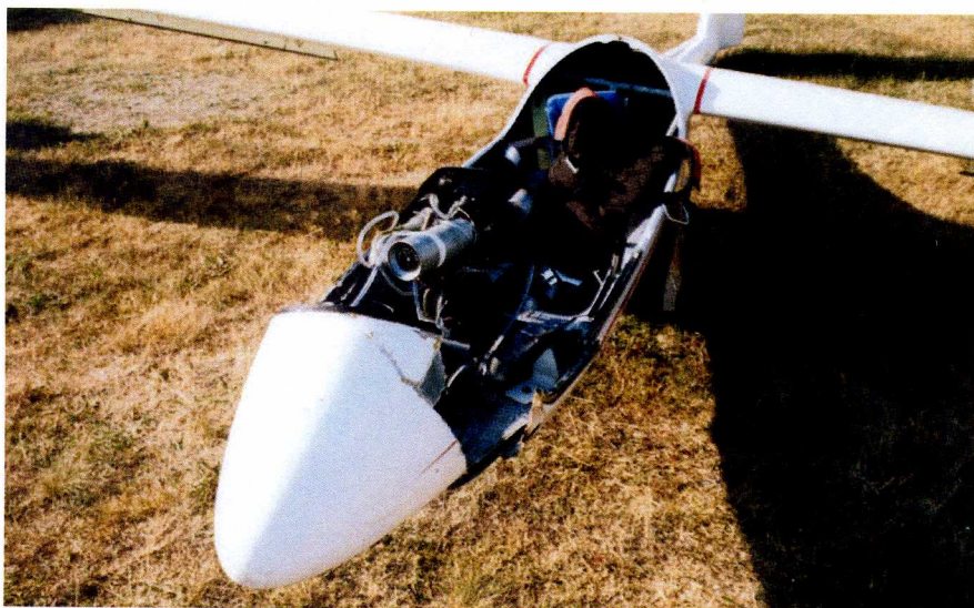
11 i 12 – Zniszczona struktura przedniej części kadłuba i ślad przyziemienia na jej skorupie.
