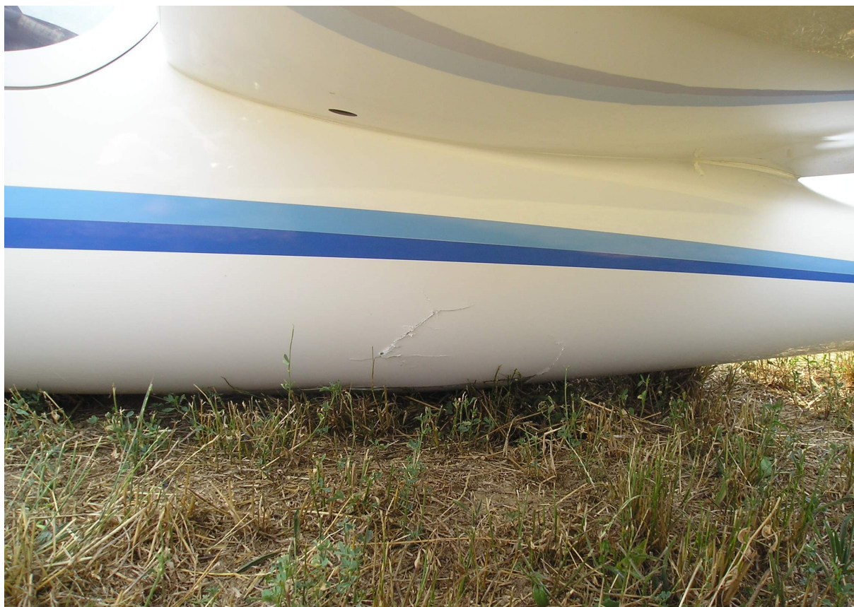
7 – Uszkodzenia kadłuba – lewa strona.
