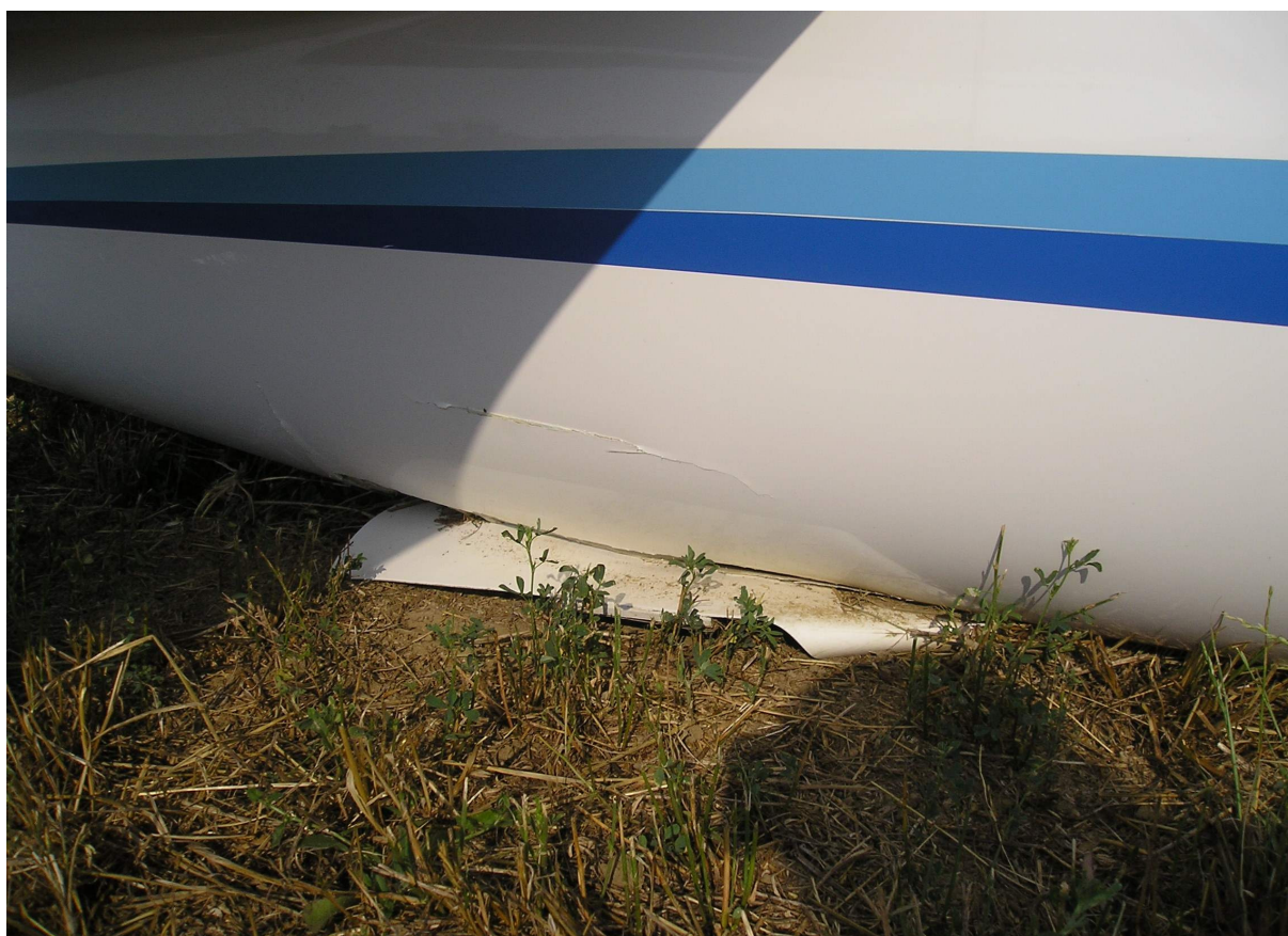
6 – Uszkodzenia kadłuba – prawa strona.
