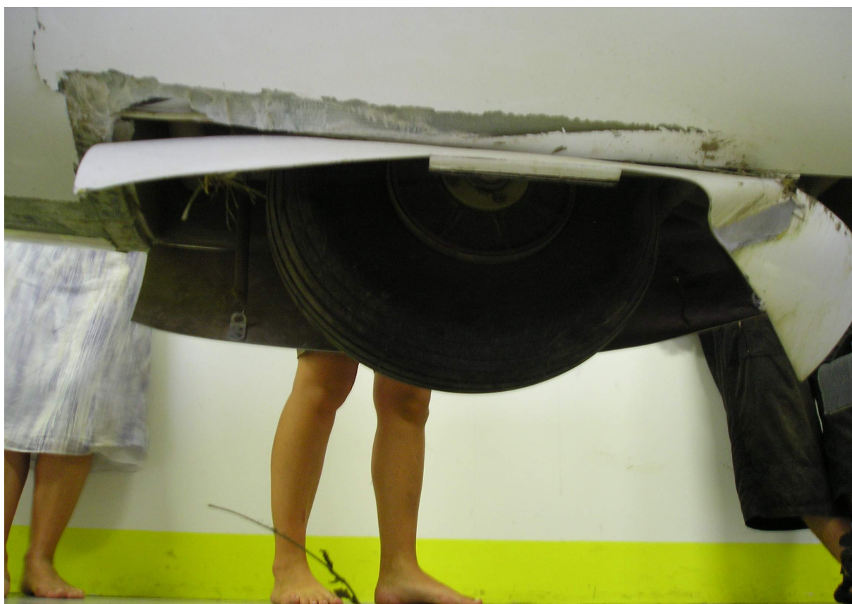
8 – Widok na koło i wnękę podwozia, widoczne uszkodzenia kadłuba i pokryw podwozia.
