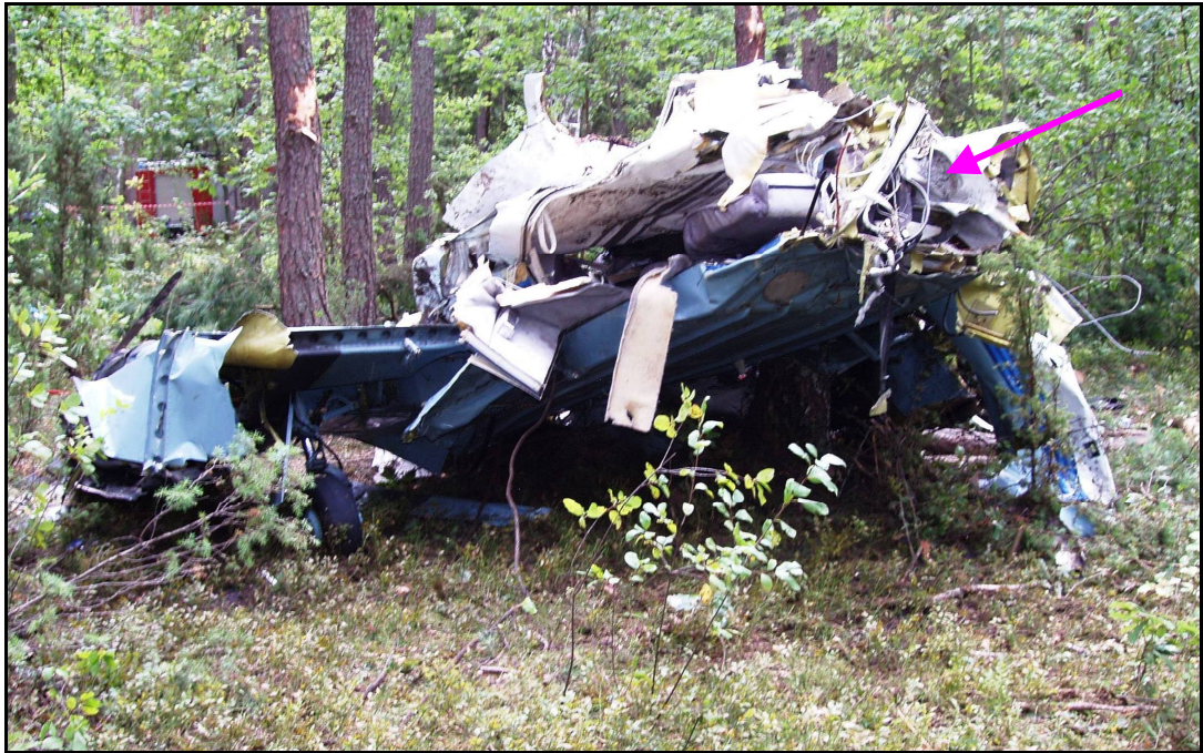
Fot. 9. Widok na wrak samolotu od tyłu; widoczny urwany (ukręcony) tył kadłuba (oznacz. strzałką)
