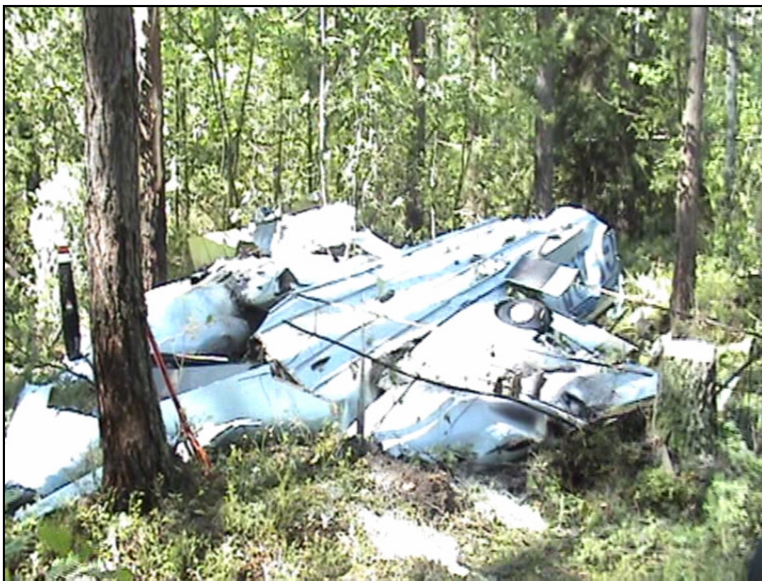
Fot. 3. Widok wraku na miejscu wypadku, pozycja odwrócona, podwozie schowane, konfiguracja gładka, brak części ogonowej i skrzydeł
