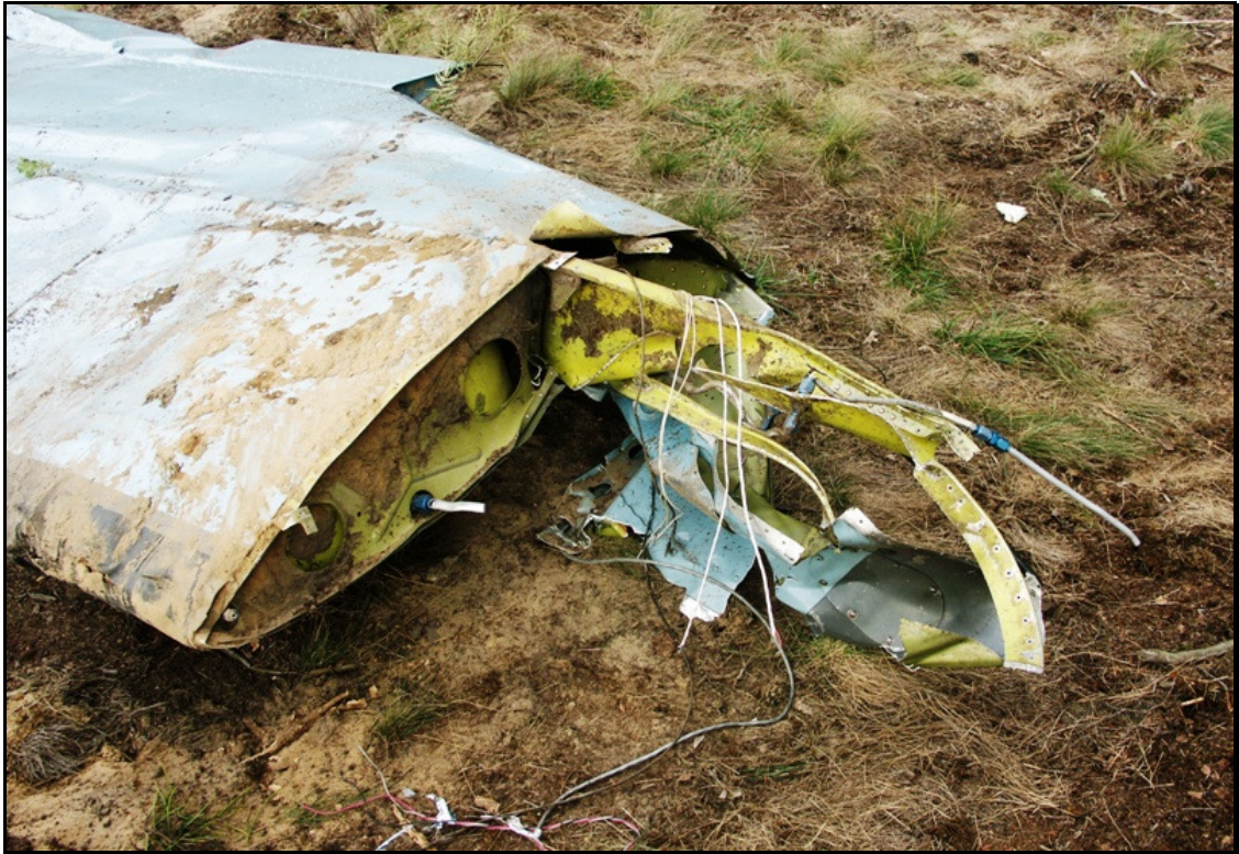
Fot. 25. Skrzydło prawe – widok dźwigara
