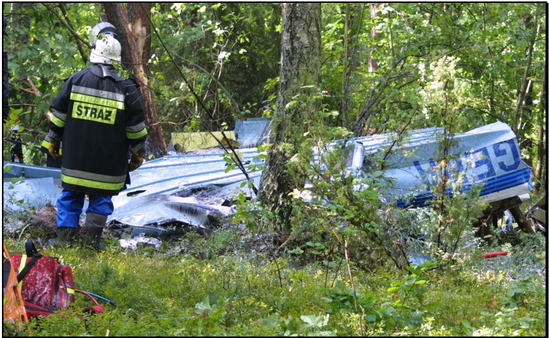
Fot. 5. Wrak samolotu w położeniu bezpośrednim po wypadku, tzn. kołami do góry –przed odwróceniem w celu dostania się do pilota; widok na prawą stronę samolotu (na fot. 2 oznacz. A)
