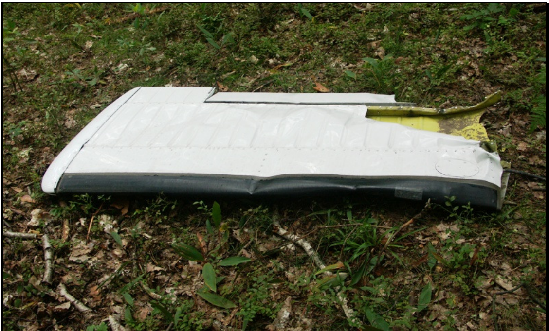
Fot. 26. Fragment usterzenia poziomego (oznacz. E na fot. 2); element ten został znaleziony przez przypadkową osobę w pobliżu słupa energetycznego o numerze 986; miejsce to pokazują dwa następne zdjęcia
