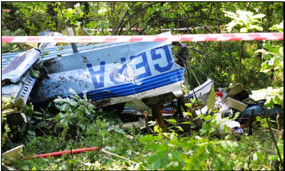
Fot. 6. Część ogonowa samolotu bez stateczników i usterzenia
