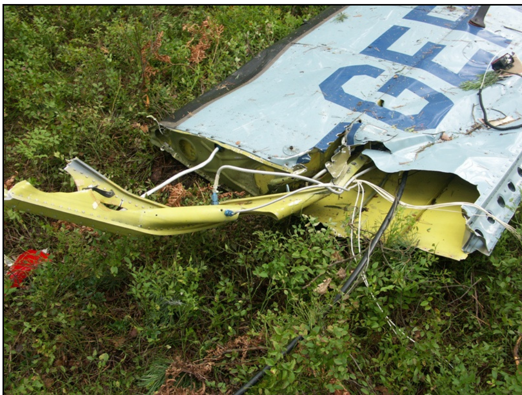
Fot. 19. Urwane skrzydło lewe – widok złamanego dźwigara
