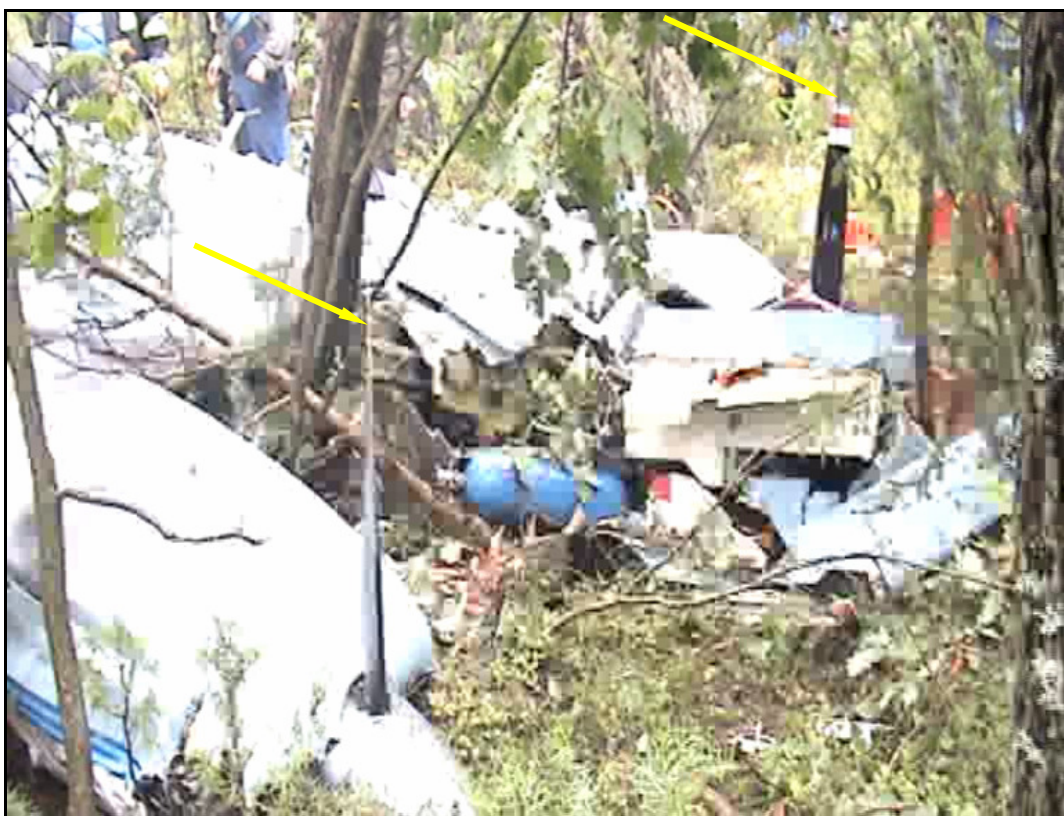
Fot. 4. Stan śmigieł samolotu po upadku, brak uszkodzeń powodowanych obrotami
