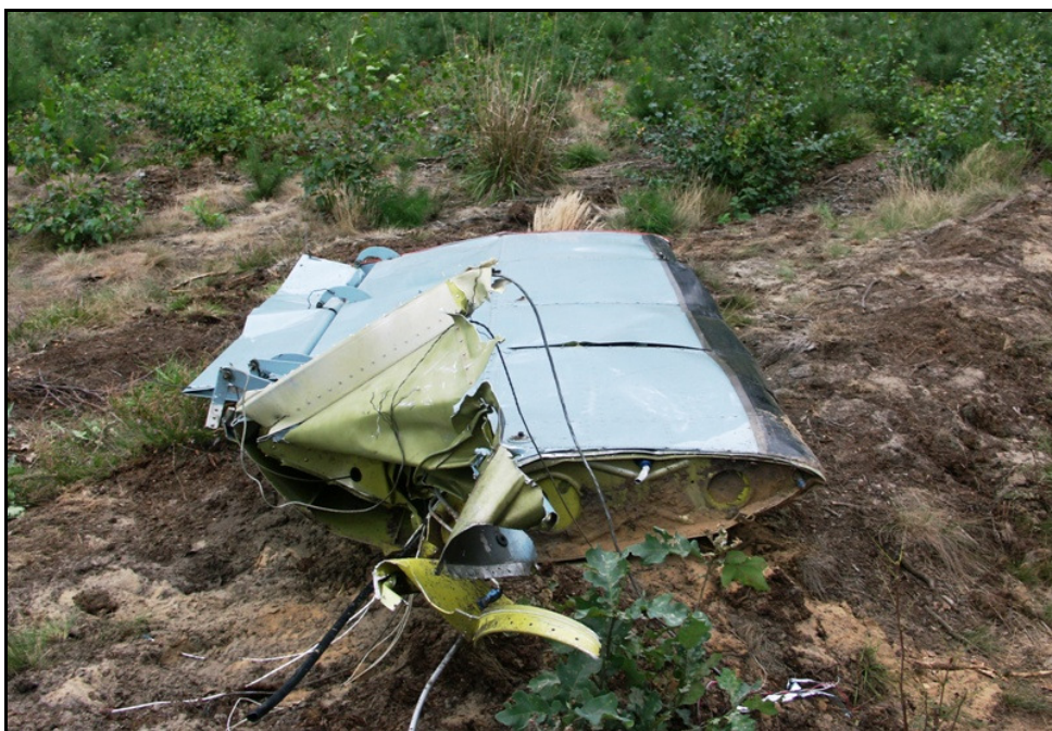
Fot. 22. Urwane skrzydło prawe (oznacz. B na fot. 2)
