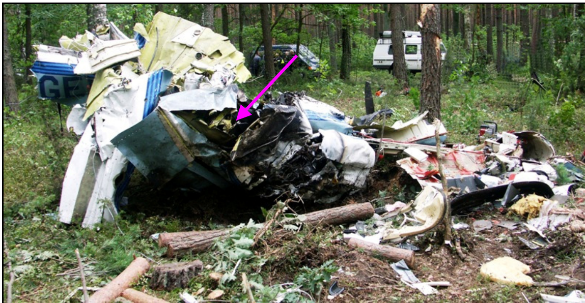
Fot. 11. Widok na wrak samolotu od strony prawego silnika; strzałka wskazuje miejsce po urwanym prawym skrzydle
