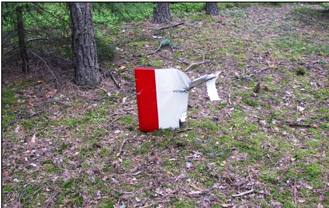
Fot. 15. Fragment steru kierunku, widok z boku (oznacz. D na fot. 2)
