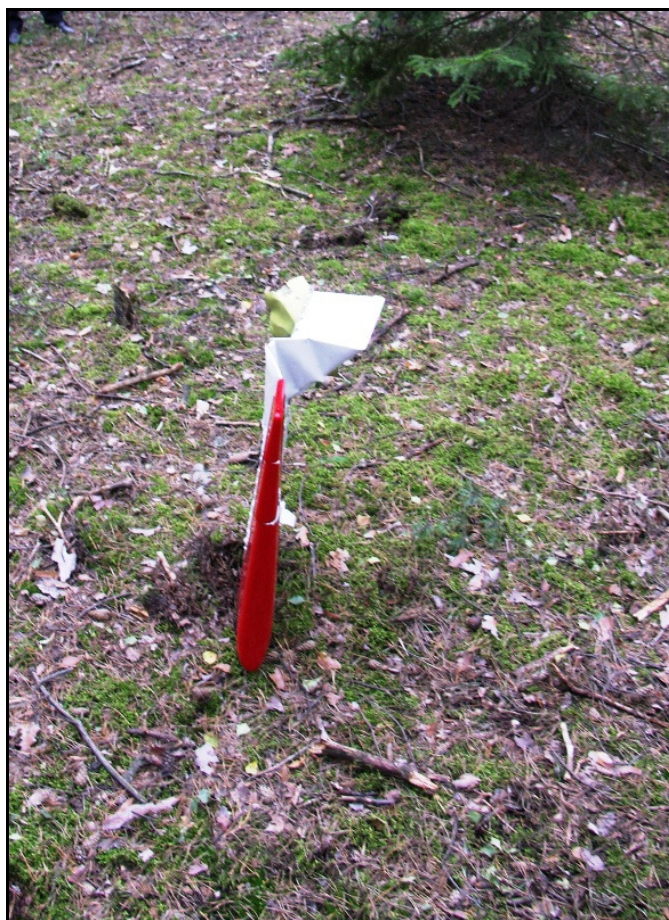
Fot. 16. Fragment steru kierunku, widok od strony krawędzi natarcia
