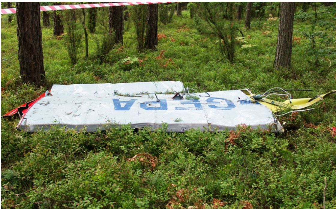
Fot. 17. Urwane lewe skrzydło w miejscu upadku (oznacz. C na fot. 2)
