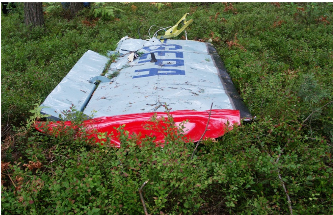
Fot. 18. Urwane skrzydło lewe, widok od strony kołpaka
