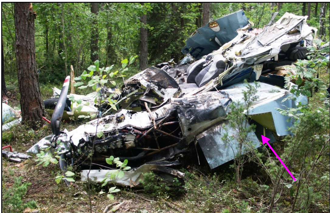
Fot. 10. Widok na wrak samolotu od strony lewego silnika; strzałka wskazuje miejsce po urwanym lewym skrzydle
