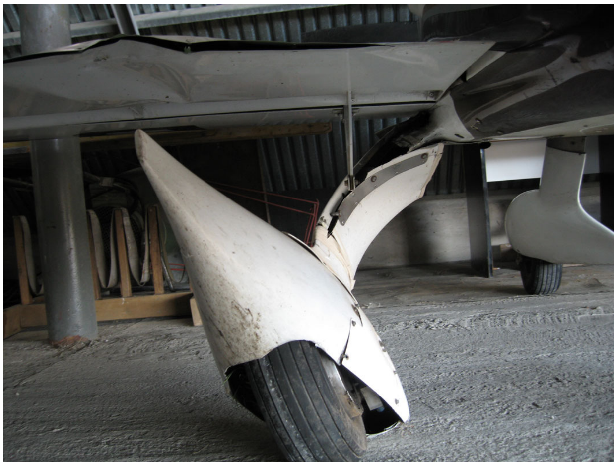
8 – Uszkodzenia lewego podwozia głównego i lewej kłapy, widok od spodu.
