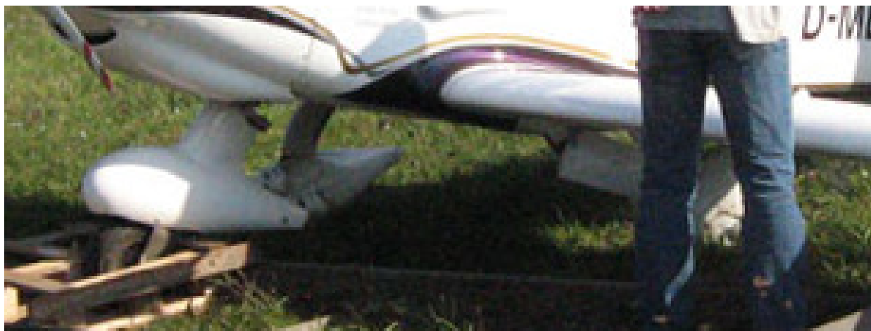
9 – Samolot na miejscu wypadku, przygotowany do odholowania. Widoczne uszkodzenie lewego podwozia głównego i przemieszczenie owiewki koła prawego podwozia głównego..
