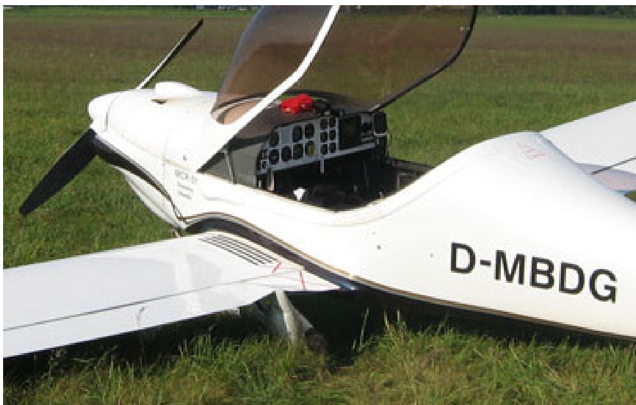
6 – Samolot na miejscu wypadku; na zbliżeniu widoczne uszkodzenie lewej kłapy i lewego podwozia głównego.
