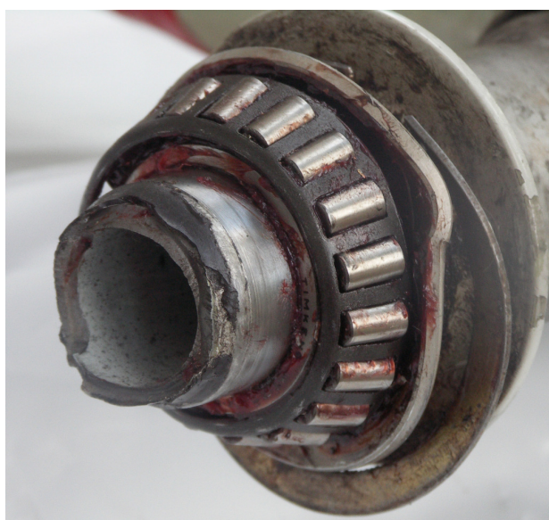
Fot.10a i 10b – Przełom zakończenia osi w różnym oświetleniu, widoczne resztki gumowej opaski ochronnej.
