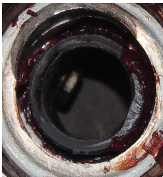
Fot.8 – Zbliżenie przełomu odłamanej części osi pozostającej wewnątrz oderwanego koła.
