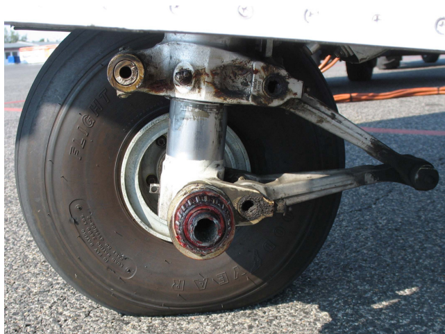
Fot.5 – Podwozie przednie z odłamanym zakończeniem osi lewego koła.
