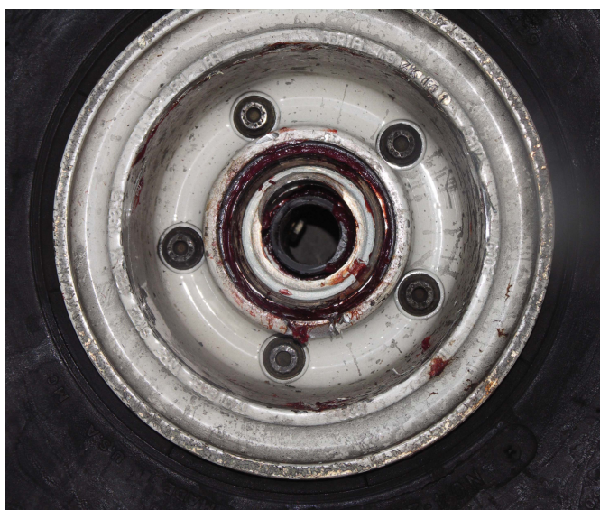
Fot.7 – Oderwane koło podwozia, wewnątrz widoczna część odłamanej osi.
