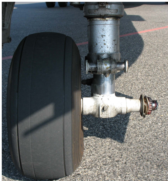
Fot.5 – Podwozie przednie z odłamanym zakończeniem osi lewego koła.
