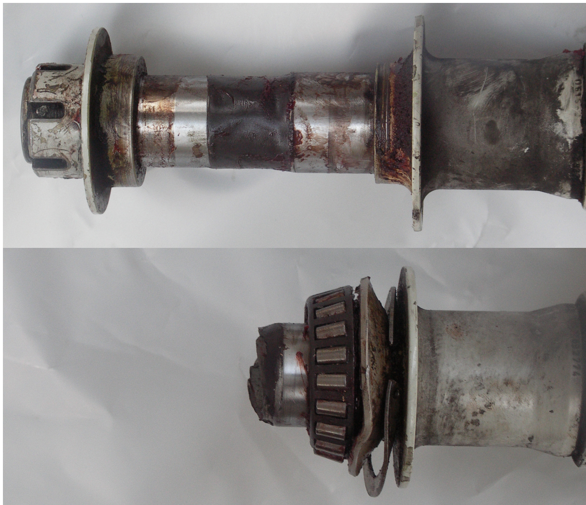
Fot.9a i 9b – Zakończenia osi kół podwozia przedniego samolotu ATR72 po zdemontowaniu kół – u góry bez widocznych uszkodzeń, u dołu złamane w miejscu przewężenia przekroju, elementy łożyskowania pozostawione.
