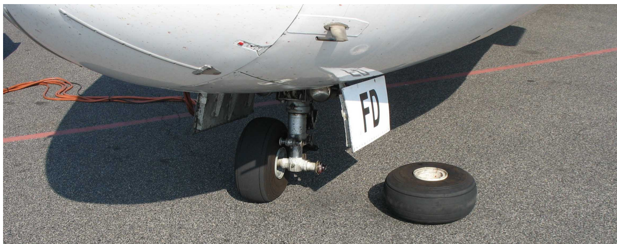
Fot.3 – Po wypadku – uszkodzone podwozie przednie i oderwane lewe koło.
