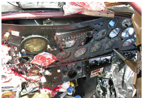
Fot.21 i Fot.22 – Zniszczona tablica przyrządów.
