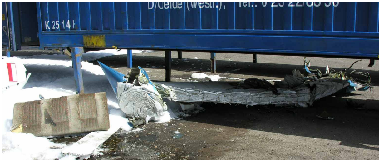
Fot.13 – Szczątki lewego skrzydła – widać zniszczony nosek i „sprasowany” zbiornik paliwa na końcówce.
