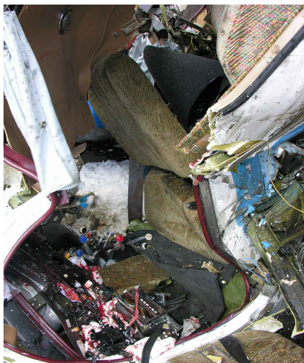
Fot.17 i 18 – Szczątki przedniej części kadłuba, kabiny i oderwany lewy silnik.
