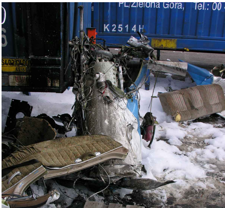
Fot.17 i 18 – Szczątki przedniej części kadłuba, kabiny i oderwany lewy silnik.
