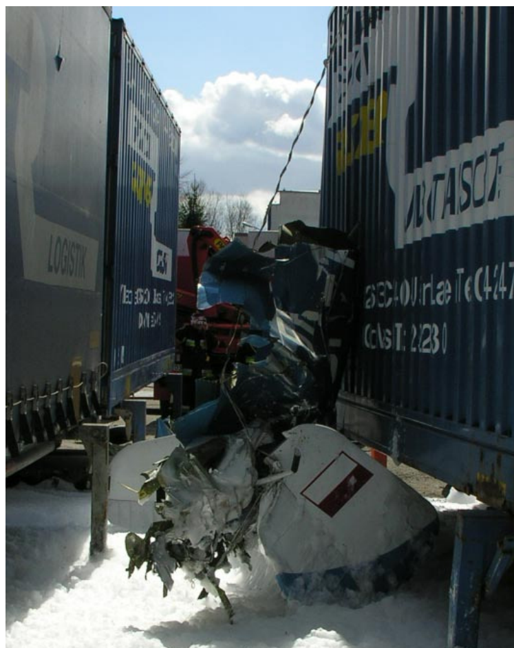
Fot.8, Fot.9 i Fot.10 - Ogólna sytuacja w miejscu wypadku na ziemi, z przeciwnej strony, niż pokazana na Fot.5, Fot.6 i Fot.7 – widoczne szczątki tylnej części kadłuba i usterzenia oraz prawego skrzydła (na Fot.10).
