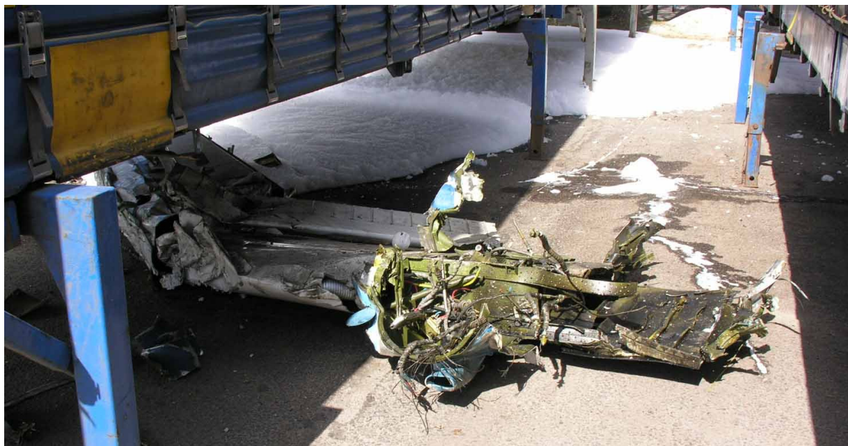
Fot.14 – Szczątki lewego skrzydła z resztkami gondoli silnika.
