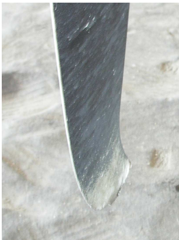
Fot.9 i Fot.10 – Uszkodzona końcówka drugiej łopaty śmigła i jej przeswity w stosunku do podłoża.
