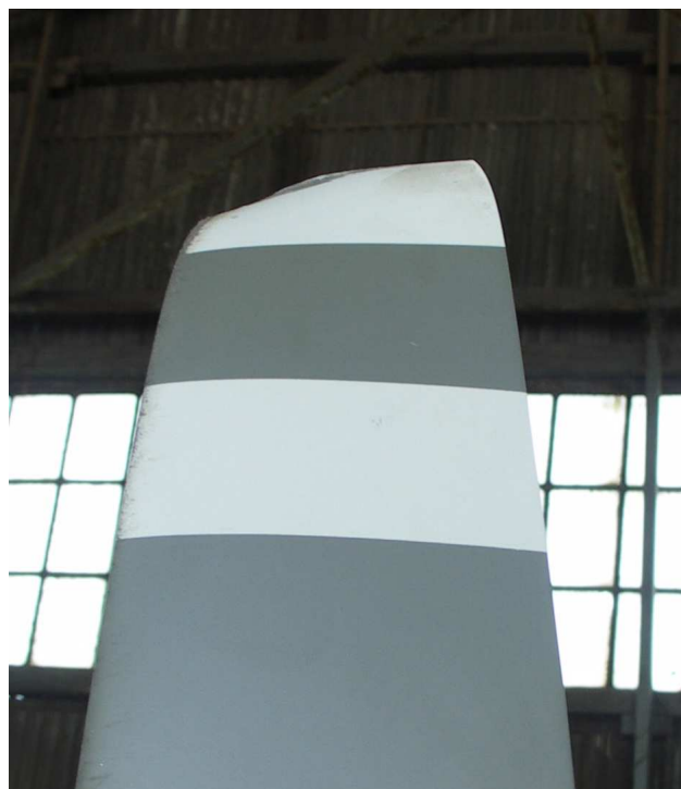
Fot.7 i Fot.8 – Końcówka łopaty śmigła uszkodzona w kolizji z nawierzchnia asfaltową.
