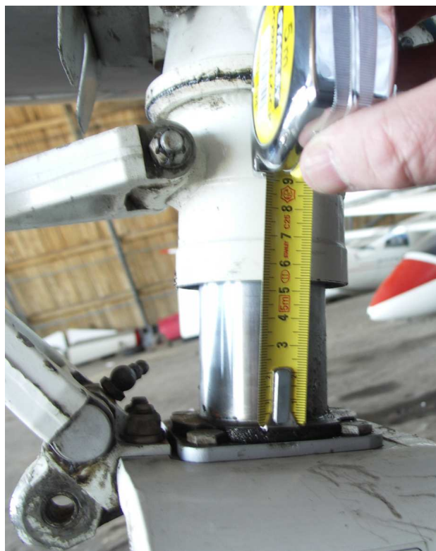
Fot.12 – Pomiar wystawania „dobitego” amortyzatora.
