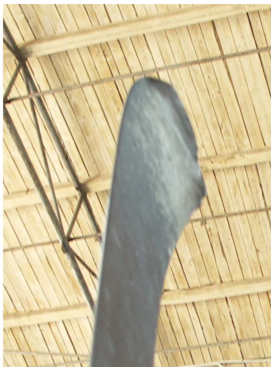
Fot.7 i Fot.8 – Końcówka łopaty śmigła uszkodzona w kolizji z nawierzchnia asfaltową.
