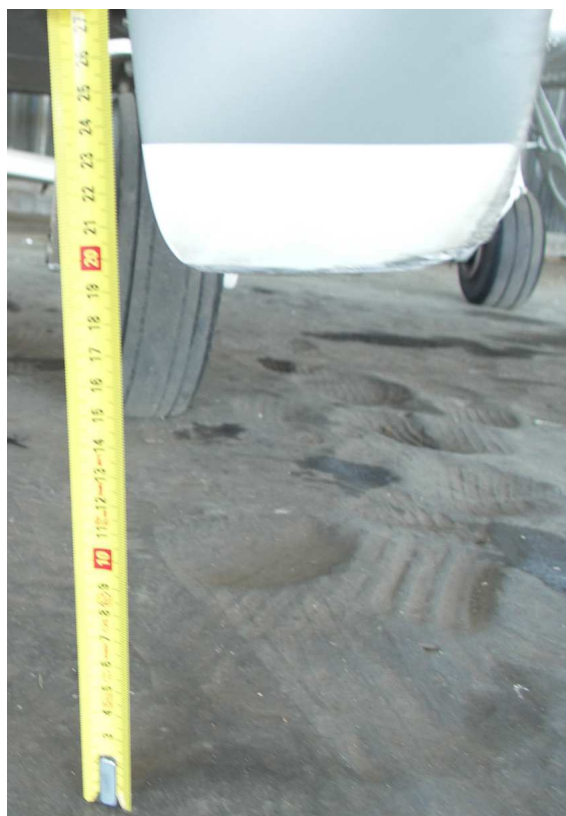
Fot.9 i Fot.10 – Uszkodzona końcówka drugiej łopaty śmigła i jej przeswity w stosunku do podłoża.
