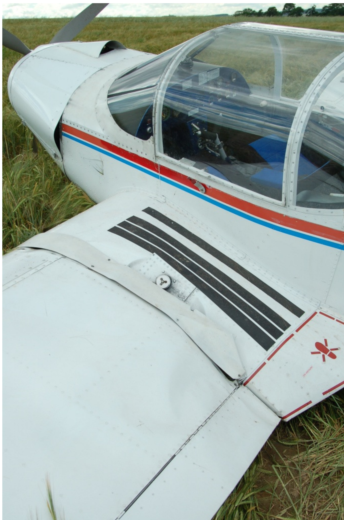
10 – Widok na uszkodzenia górnej powierzchni lewego skrzydła w zbliżeniu.
