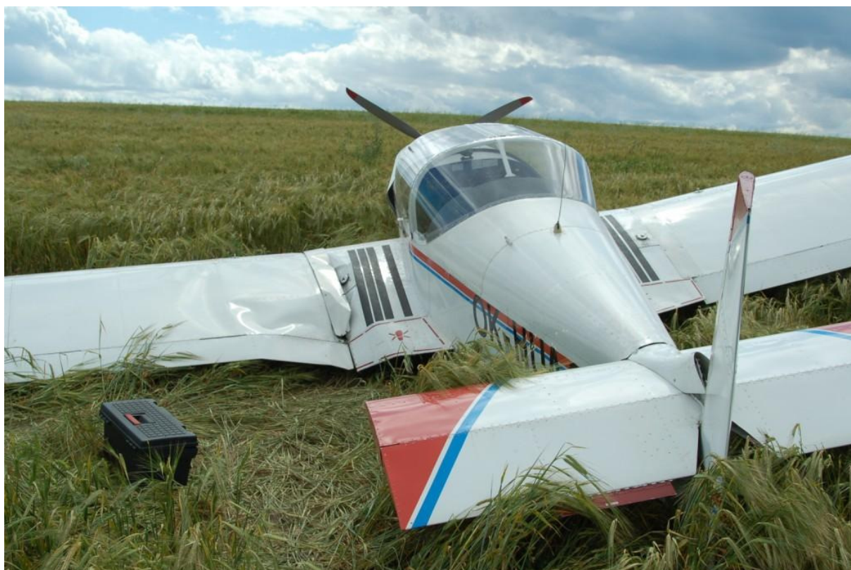
7 – Samolot na miejscu wypadku, widoczne uszkodzenia lewego skrzydła i lewej kłapy.
