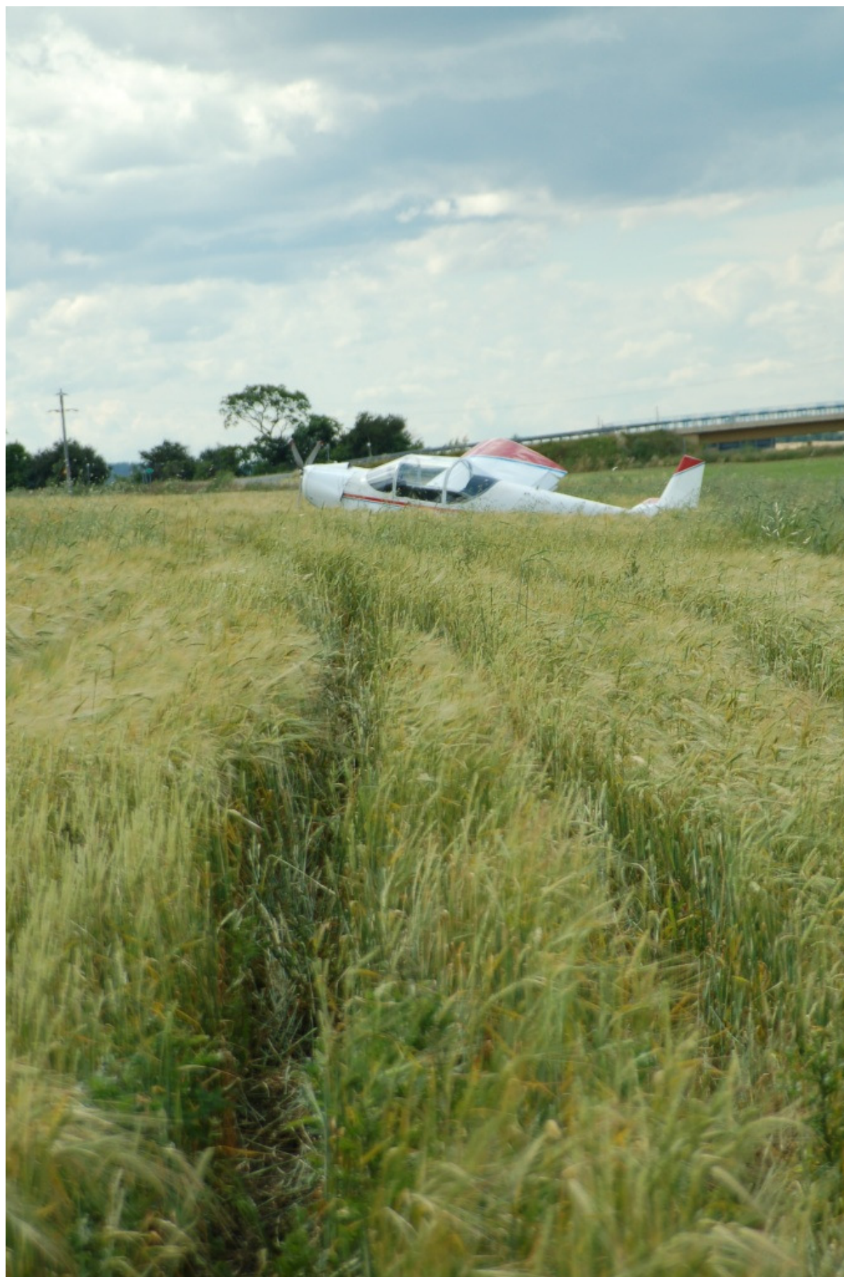
5 – Ślad wyłamanego lewego podwozia głównego w zbożu.
