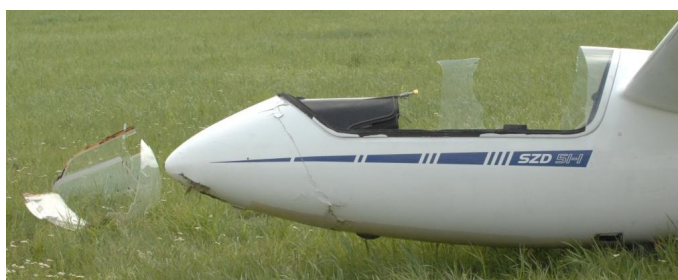
3 i 4 – Przednia część kadłuba szybowca z lewej i prawej strony. Widoczne uszkodzenia struktury i zniszczenia oszklenia osłony kabiny
