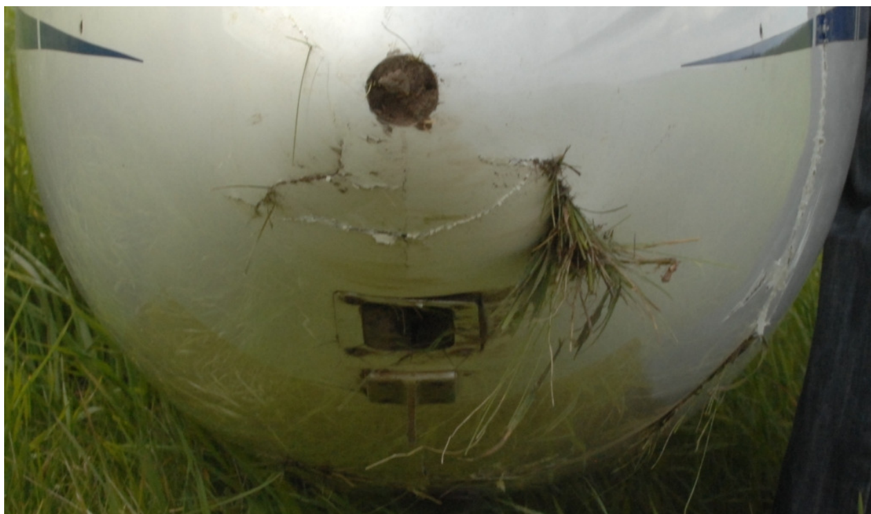
6, 7 i 8 – Uszkodzenia przedniej części kadłuba szybowca pokazane na zbliżeniach.
