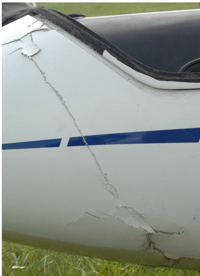
6, 7 i 8 – Uszkodzenia przedniej części kadłuba szybowca pokazane na zbliżeniach.
