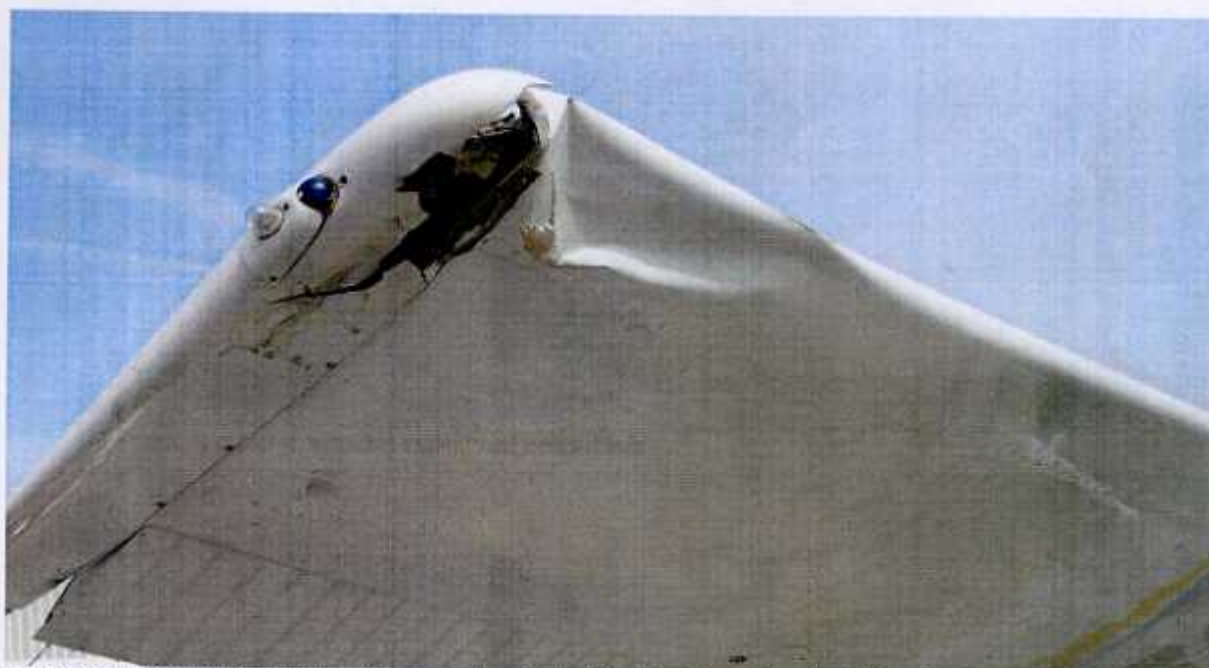
17 - Uszkodzenia prawego skrzydła – widoczna zniszczona końcówka i zafalowania pokryw dolnych.
