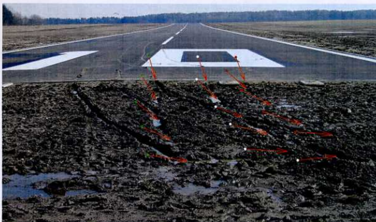
9 – Ślady kół samolotu pozostawione w rozmiękłym gruncie po zjechaniu z pasa asfaltowego: znaczniki zielone – prawe koło, znaczniki białe – przednie koło, znaczniki czerwone – lewe koło.
