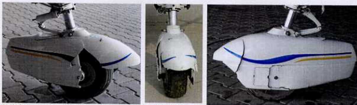
12, 13 i 14 – Podwozie przednie, widoczne uszkodzenia owiewki koła.
