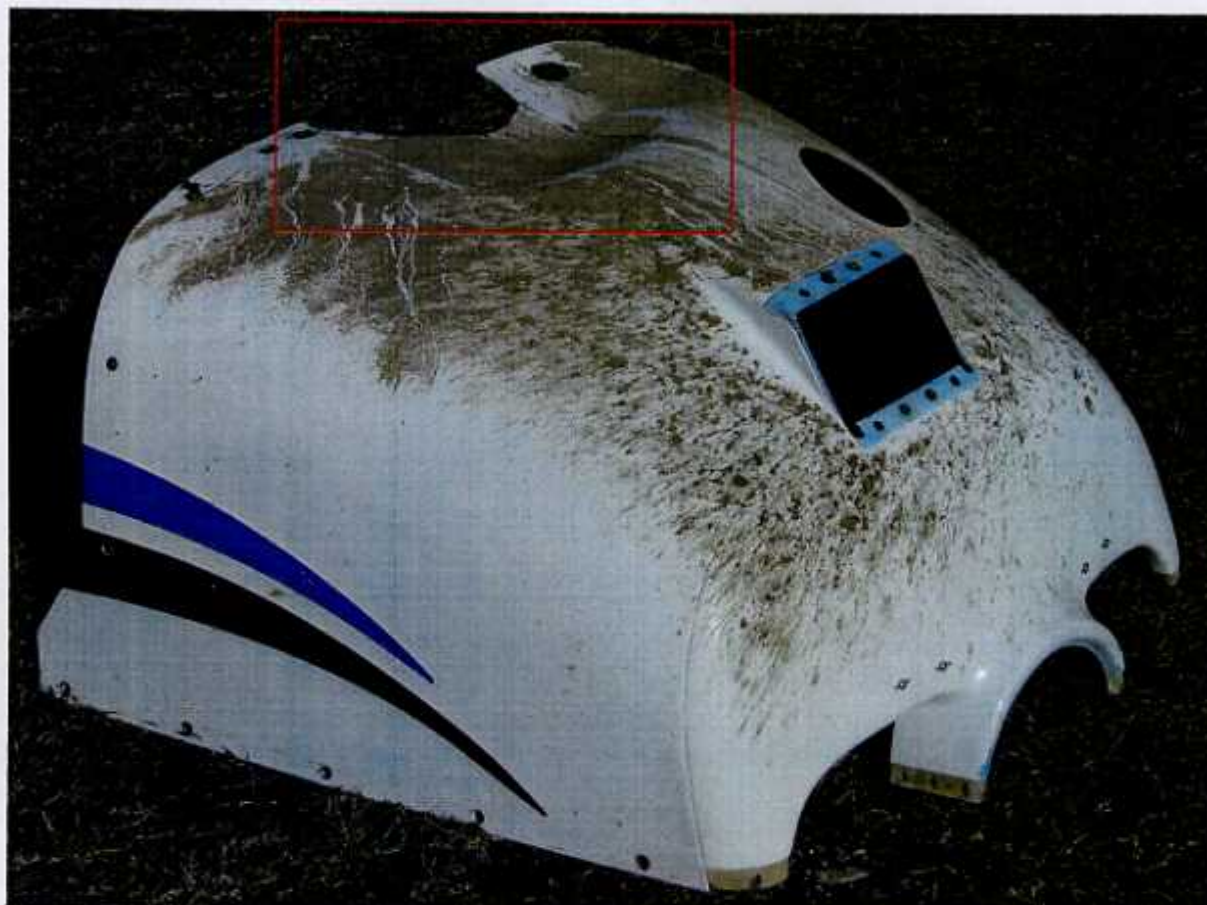
28 – Dolna osłona silnika z zaznaczoną strefą wgniecenia.
