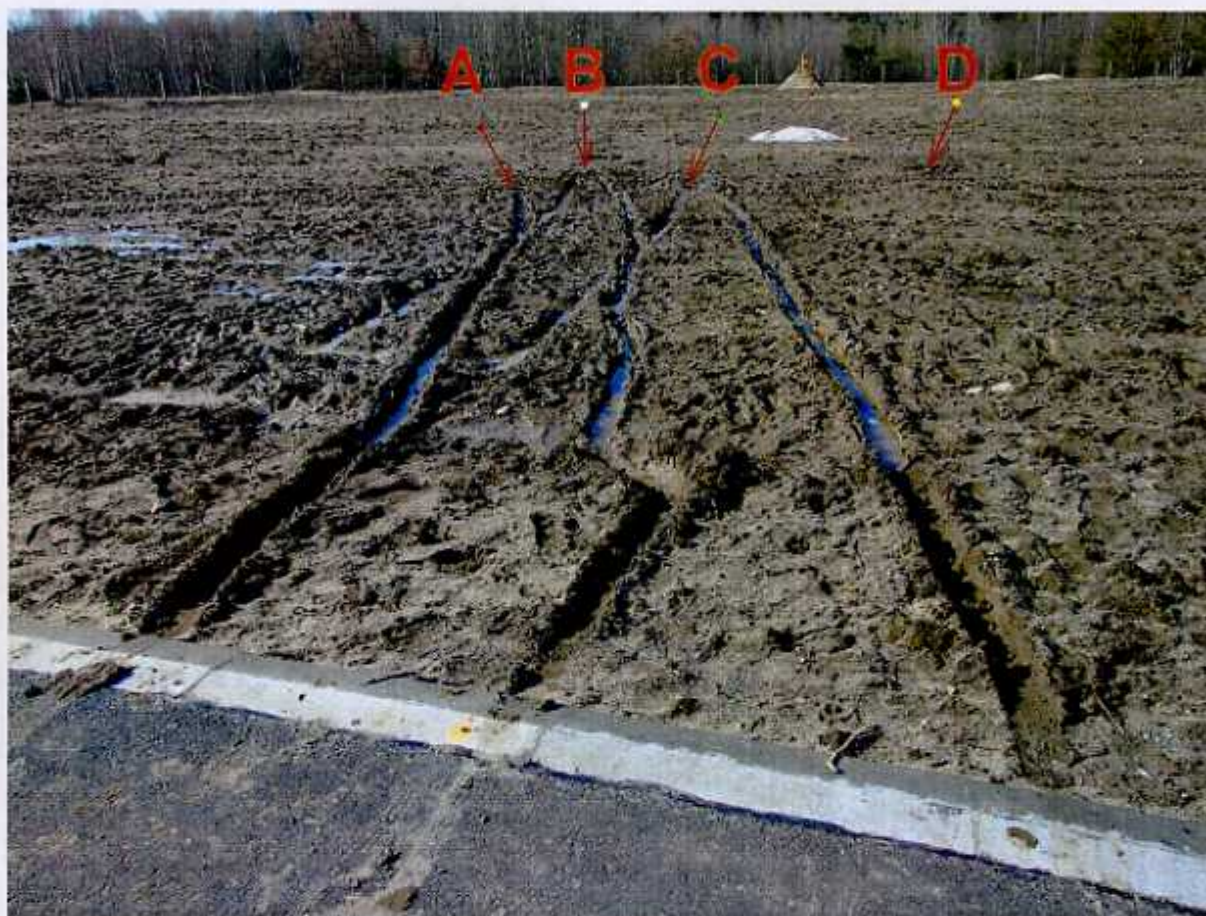
8 – Ślady samolotu po zatrzymaniu w rozmiękłym gruncie: A – lewe koło, B – przednie koło, C – prawe koło, D – miejsce uderzenia końcówką prawego skrzydła w ziemię. Na pierwszym planie głębokie ślady powstałe podczas wyciągania samolotu.
