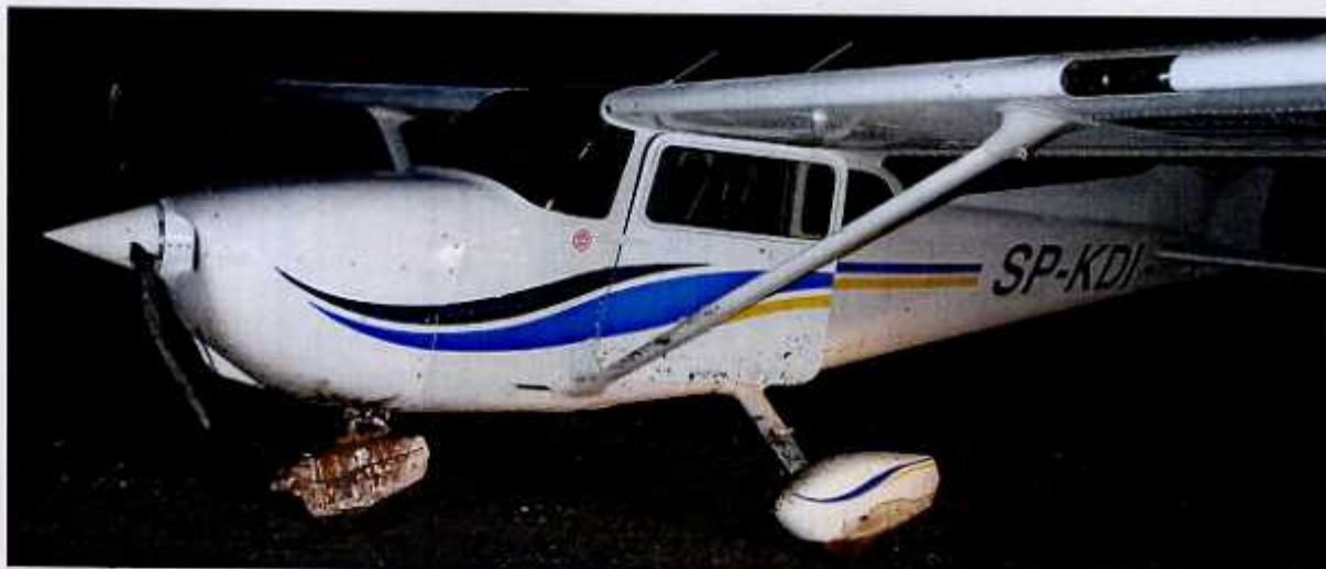
5 i 6 – Samolot po wyciągnięciu z rozmiętkłego gruntu za zachodnim skrajem pasa lotniska Olsztyn-Dajtki – tuż po wypadku i następnego dnia przed południem. Widoczna zgięta łopata śmigła i uszkodzona owiewka koła podwozia przedniego.
