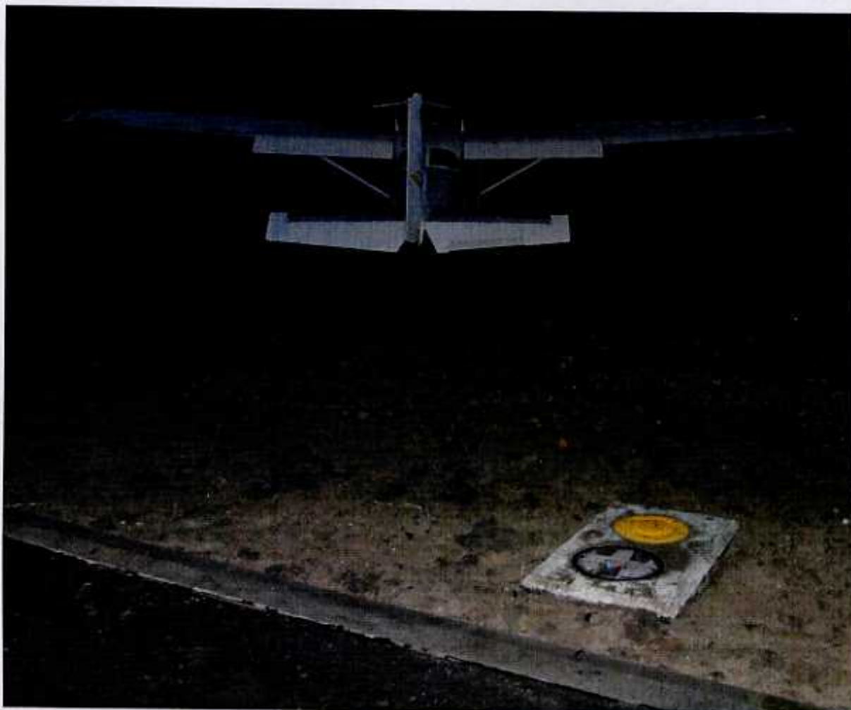
3 i 4 – Samolot tuż po wypadku, po wytoczeniu się w rozmiękły grunt za zachodni skraj pasa startowego lotniska Olsztyn-Dajtki. Widoczne kłapy wychylone na kąt „do lądowania” i trymer steru wysokości, nieco wychylony w położenie „ciężki na nos” (wyraźnie widoczne na zdjęciu 4). Z prawej strony zdjęcia 3 jedna z lamp krańcowych pasa startowego.
