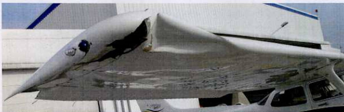
18 - Uszkodzenia prawego skrzydła – widoczna zniszczona końcówka i zafalowania pokryw dolnych.
