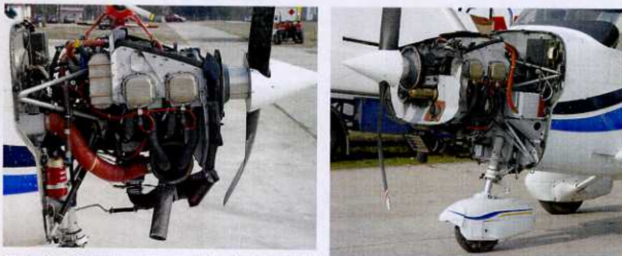
15 i 16 – Zespół napędowy, widoczna zgięta łopata śmigła i uszkodzona owiewka koła podwozia przedniego.
