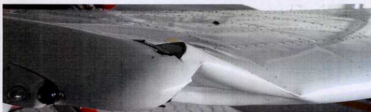
19 - Uszkodzenia prawego skrzydła – widoczna zniszczona końcówka i zafalowania pokryw górnych.
