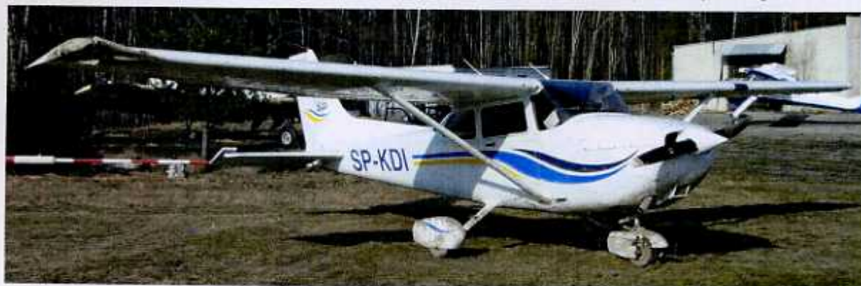
5 i 6 – Samolot po wyciągnięciu z rozmiętkłego gruntu za zachodnim skrajem pasa lotniska Olsztyn-Dajtki – tuż po wypadku i następnego dnia przed południem. Widoczna zgięta łopata śmigła i uszkodzona owiewka koła podwozia przedniego.
