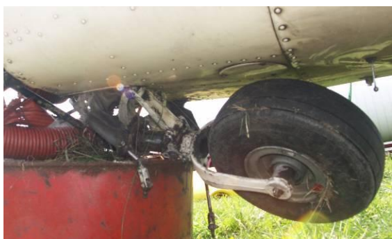
28 – Spód kadłuba; uszkodzona przednia goleń podwozia samolotu (uszkodzenia elementów sterowania gołeni, nożyce, tłumik drgań).
