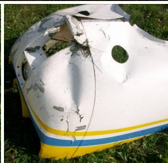
19 ÷ 24 – Widoczne uszkodzenia przedniej części kadłuba (dolnej i górnej maski silnika), łopat śmigła i kołpaka śmigła.
