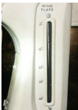
34 – Na słupku brak widocznego położenia wskaźnika wychylenia klap.
