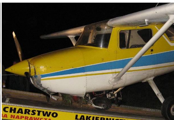
16 – Widoczne uszkodzenia przedniej części kadłuba, łopat śmigła i przedniej nogi podwozia.
