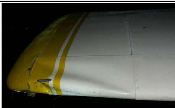
17 – Uszkodzona końcówka prawego skrzydła samolotu.
