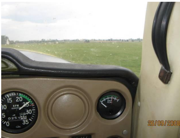
6 – Widok z wnętrza kabiny samolotu SP-KAO podczas startu tuż przed wypadkiem na lotnisku EPRP; w dolnej lewej części zdjęcia widoczne wskazania obrotów silnika - 2550 obr/min i licznika motogodzin – 251,46 godz.
