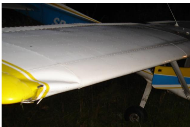
15 – Uszkodzona krawędź natarcia prawej końcówki skrzydła samolotu.
