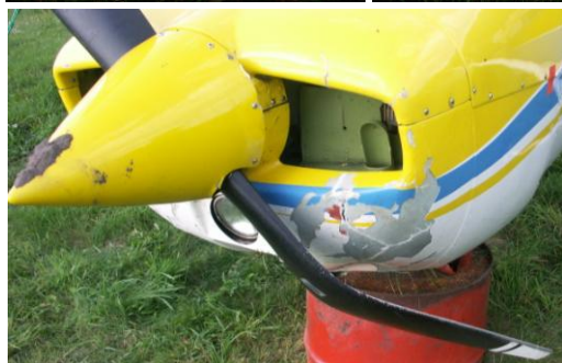
19 ÷ 24 – Widoczne uszkodzenia przedniej części kadłuba (dolnej i górnej maski silnika), łopat śmigła i kołpaka śmigła.
