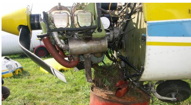
29 – Widok z lewej strony po zdjęciu dolnej i górnej maski silnika; widoczne uszkodzenia podwozia przedniego, łopaty śmigła i konstrukcji łoża silnika.
