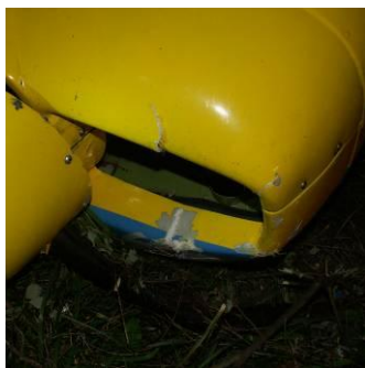
17 – Uszkodzona końcówka prawego skrzydła samolotu.
