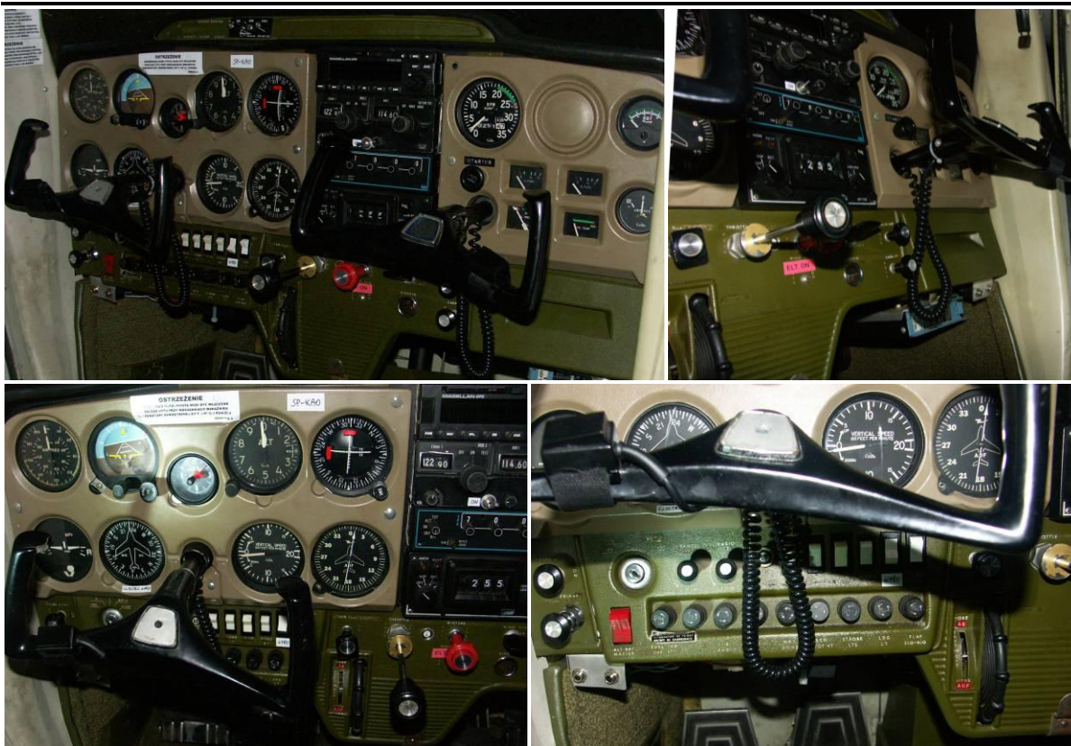
30 ÷ 33 – Widok tablicy przyrządów z kabiny samolotu SP-KAO po wypadku; widoczny obrotowy hamulec cierny dźwigni obrotów silnika oraz położenie wskaźnika trymera steru wysokości.
