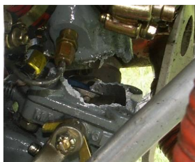
25 ÷ 27 – Odlamanie gaźnika w wyniku wypadku samolotu – uderzenia w krzewy porastające rów na końcu nieużytkowej części lotniska i zarycia przedniej części kadłuba samolotu za rowem po złamaniu podwozia przedniego.
