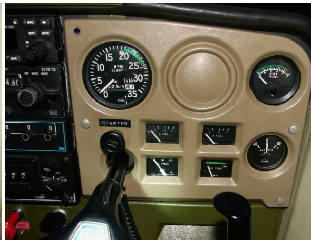
7 – Widok z kabiny samolotu SP-KAO po wypadku (uderzeniu w krzewy porastające głęboki rów na końcu lotniska EPRP); widoczne wskazanie licznika motogodzin – 251,47 godz. (różnica 0,01 godz. wskazania z fot.6).
