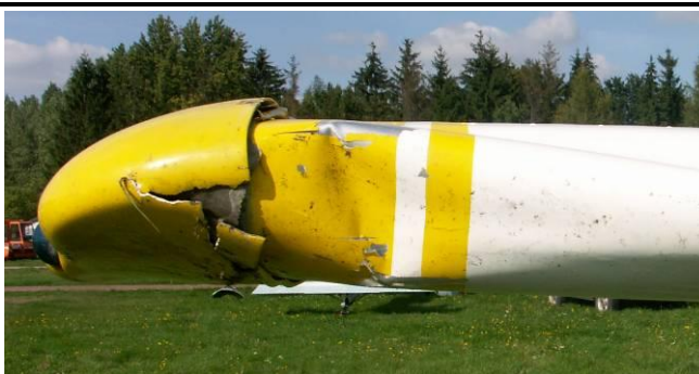
18 – Uszkodzona końcówka prawego skrzydła samolotu – zbliżenie.
