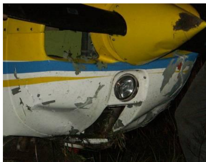
18 – Uszkodzona końcówka prawego skrzydła samolotu – zbliżenie.
