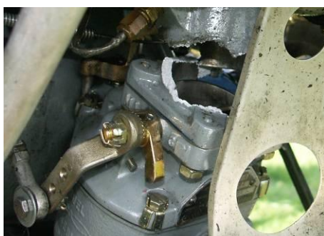
25 ÷ 27 – Odlamanie gaźnika w wyniku wypadku samolotu – uderzenia w krzewy porastające rów na końcu nieużytkowej części lotniska i zarycia przedniej części kadłuba samolotu za rowem po złamaniu podwozia przedniego.
