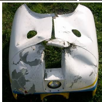
19 ÷ 24 – Widoczne uszkodzenia przedniej części kadłuba (dolnej i górnej maski silnika), łopat śmigła i kołpaka śmigła.
