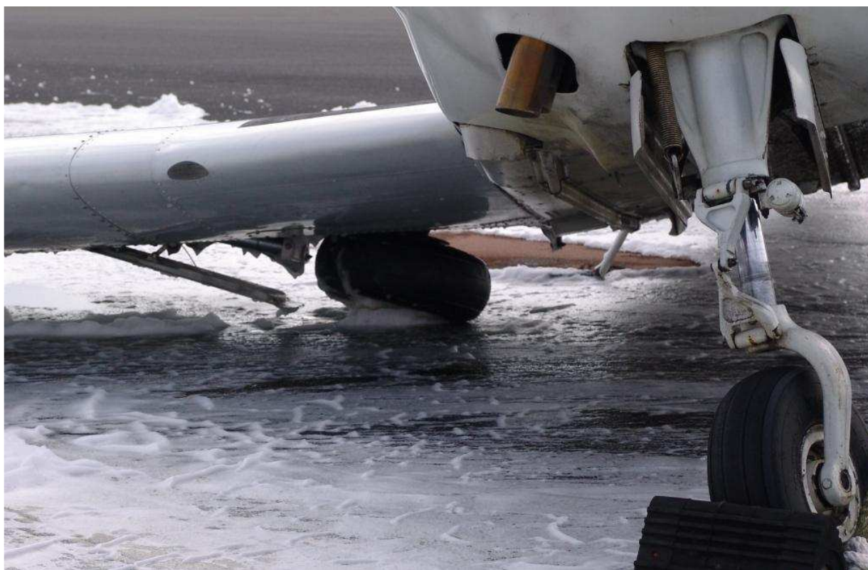
4 – Widok od przodu na złożone wskutek nie zablokowania na zamku prawe podwozie główne samolotu po jego zatrzymaniu na końcu dobiegu.
