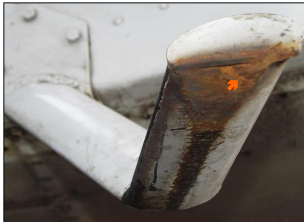
12 i 13 – Uszkodzenia samolotu: starcie spodu stopnia z prawej strony kadłuba.
