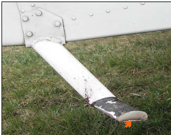
12 i 13 – Uszkodzenia samolotu: starcie spodu stopnia z prawej strony kadłuba.
