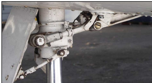
7 i 8 – Widok na wnękę prawego podwozia głównego, prawe podwozie główne, jego zamocowanie w skrzydle oraz mechanizmy układu chowania i wypuszczania z tyłu i z przodu – brak widocznych uszkodzeń.
