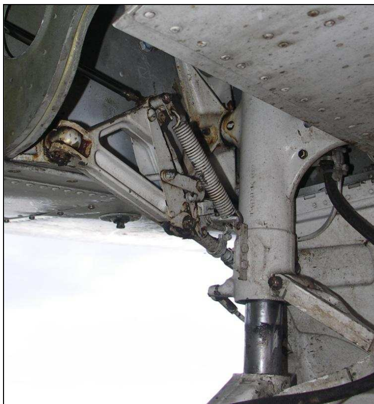
5 i 6 – Widok na wnękę prawego podwozia głównego, prawe podwozie główne, jego zamocowanie w skrzydle oraz mechanizmy układu chowania i wypuszczania – brak widocznych uszkodzeń.
