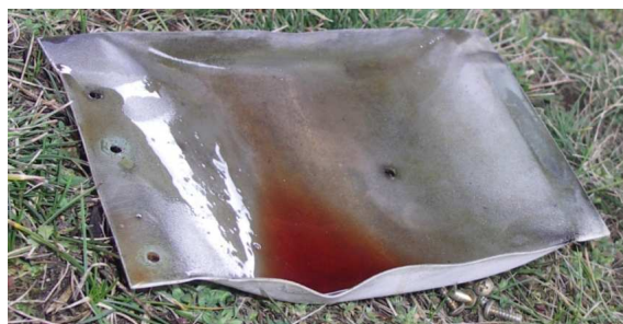
16, 17 i 18 – Owiewka nakrętek sworzni mocowania dźwigara głównego prawego skrzydła przy kadłubie, nakrętki sworzni mocujących z widocznymi kroplami płynu hydraulicznego i zdemonstrowana owiewka nakrętek sworzni mocowania dźwigara głównego prawego skrzydła, wypełniona płynem hydraulicznym z wycieku spowodowanego obluzowaniem końcówki przewodu.
