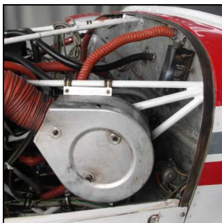
21, 22, 23 – Widok na agregaty silnika z lewej strony (zdjęcie lewe). Zwraca uwagę nieprawidłowe zmontowanie obudowy filtra powietrza (zdjęcie środkowe) i zaawansowana korozja zbiorniczka płynu hamulcowego oraz niektórych części złącznych (zdjęcie prawe).
