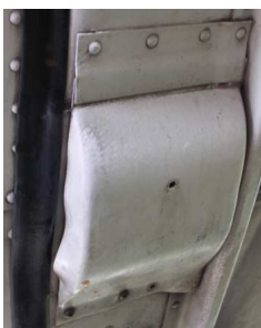
16, 17 i 18 – Owiewka nakrętek sworzni mocowania dźwigara głównego prawego skrzydła przy kadłubie, nakrętki sworzni mocujących z widocznymi kroplami płynu hydraulicznego i zdemonstrowana owiewka nakrętek sworzni mocowania dźwigara głównego prawego skrzydła, wypełniona płynem hydraulicznym z wycieku spowodowanego obluzowaniem końcówki przewodu.
