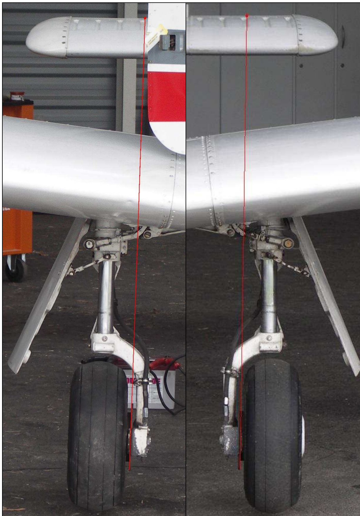
25 i 26 – Widoczna nierównomierność zużycia ogumienia podwozia głównego i jej przyczyna – nie zachowanie geometrii zamocowania goleni podwozia w położeniu „WYPUSZCZONE”. Czerwone linie styczne do płaszczyzn tarcz hamulców stanowią wyraźną wizualizację tego stanu.
