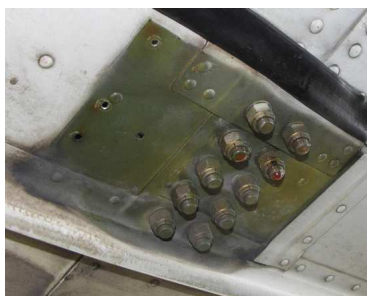
16, 17 i 18 – Owiewka nakrętek sworzni mocowania dźwigara głównego prawego skrzydła przy kadłubie, nakrętki sworzni mocujących z widocznymi kroplami płynu hydraulicznego i zdemonstrowana owiewka nakrętek sworzni mocowania dźwigara głównego prawego skrzydła, wypełniona płynem hydraulicznym z wycieku spowodowanego obluzowaniem końcówki przewodu.
