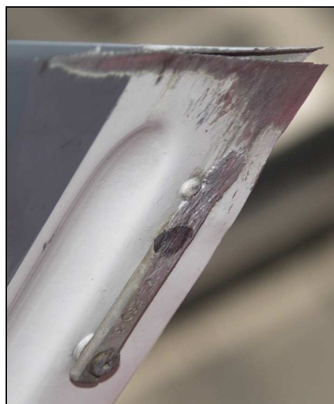
10 i 11 – Uszkodzenia samolotu: starcie kompozytowego i blaszanego elementu końcówki prawego skrzydła przy spływie, starcie końcówki prawej lotki przy spływie z oderwaniem fragmentu rozładowywacza ładunków elektrostatycznych.
