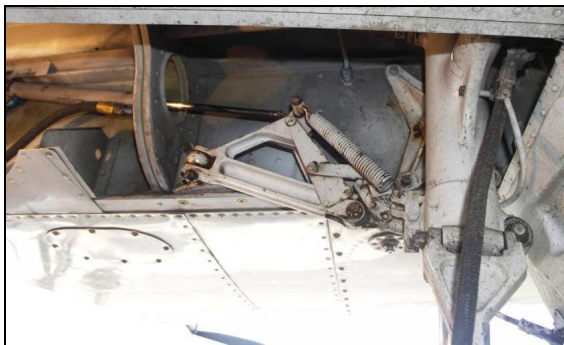
7 i 8 – Widok na wnękę prawego podwozia głównego, prawe podwozie główne, jego zamocowanie w skrzydle oraz mechanizmy układu chowania i wypuszczania z tyłu i z przodu – brak widocznych uszkodzeń.
