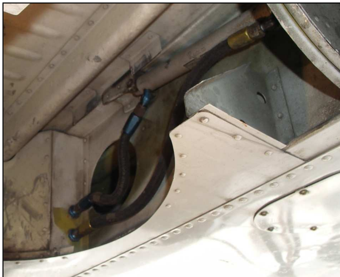
19 i 20 – Odsłonięte miejsca awarii przy prawej burcie kabiny (z lewej) i przewody hydrauliczne we wnęce prawego podwozia głównego (z prawej). Zaznaczone złącze, które uległo rozszczelnieniu.
