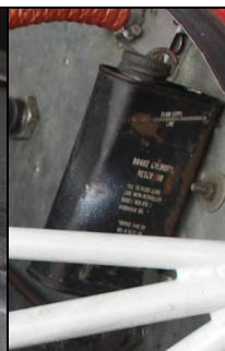
21, 22, 23 – Widok na agregaty silnika z lewej strony (zdjęcie lewe). Zwraca uwagę nieprawidłowe zmontowanie obudowy filtra powietrza (zdjęcie środkowe) i zaawansowana korozja zbiorniczka płynu hamulcowego oraz niektórych części złącznych (zdjęcie prawe).
