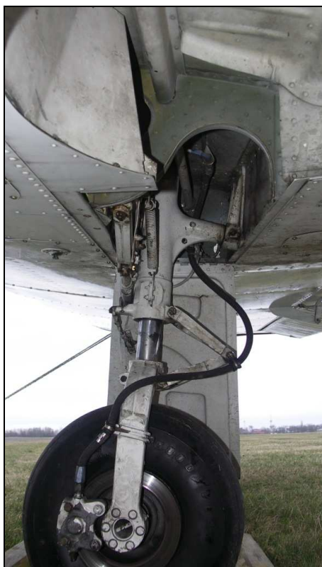
5 i 6 – Widok na wnękę prawego podwozia głównego, prawe podwozie główne, jego zamocowanie w skrzydle oraz mechanizmy układu chowania i wypuszczania – brak widocznych uszkodzeń.
