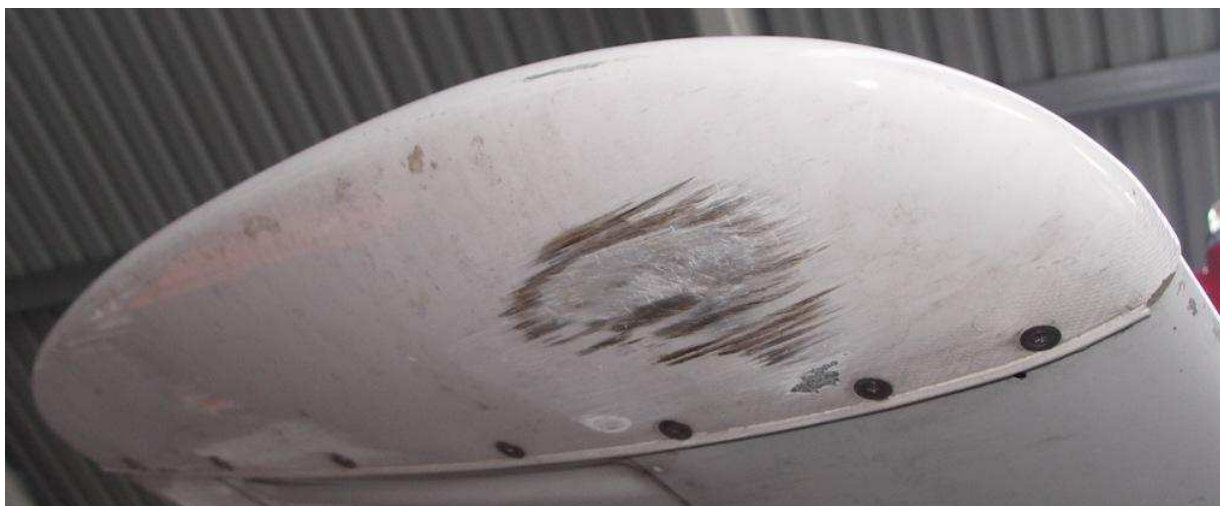
9 – Otarcia powłoki lakierniczej na prawej końcówce usterzenia poziomego.
