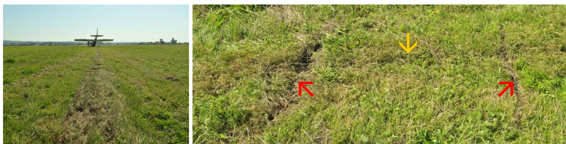
2 i 3 – Miejsce wypadku – ślad lądowania i ślady łopat śmigła (strzałki czerwone) na śladzie koła podwozia przedniego (strzałka żółta).
