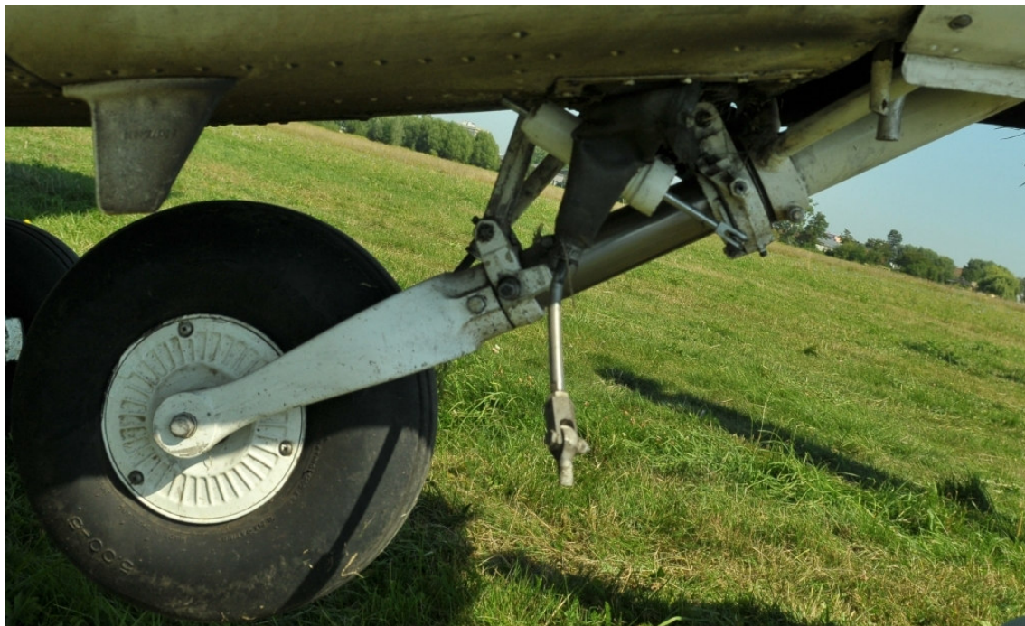
12 – Wyłamane przednie podwozie, zbliżenie z prawej strony po uniesieniu kadłuba.
