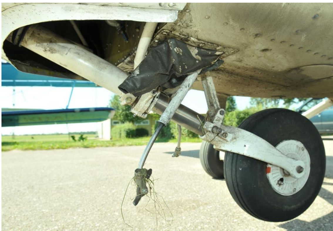
13 – Wyłamane przednie podwozie, zbliżenie z lewej strony po uniesieniu kadłuba.
