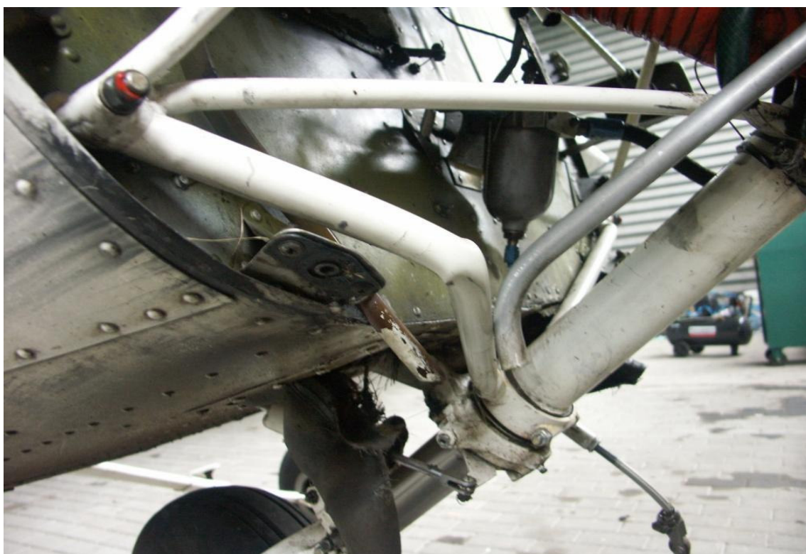
21 – Dolna część przegrody ogniowej po prawej stronie kadłuba. Widoczne uszkodzenia łoża silnika i podwozia.
