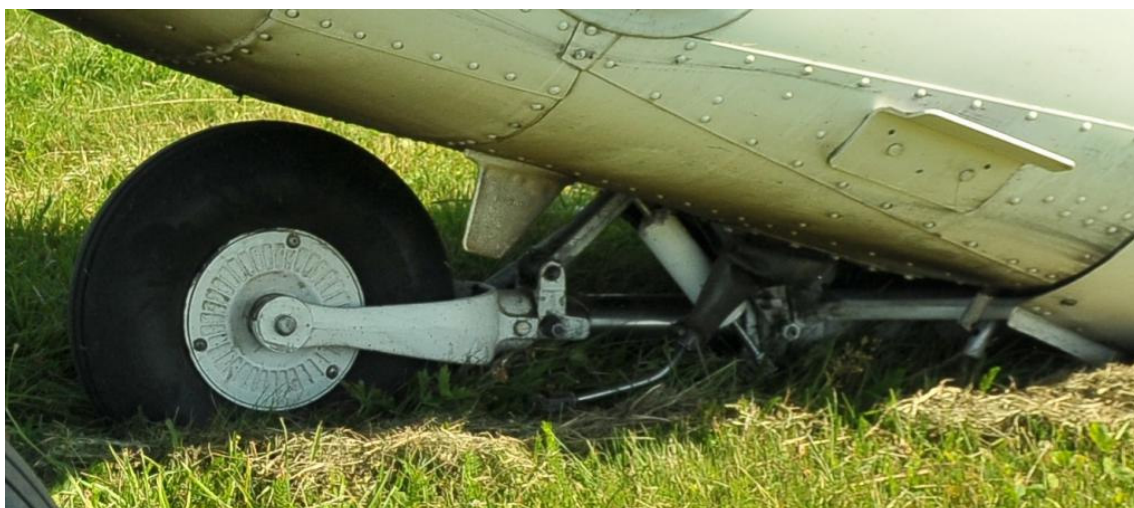
11 – Wylamane przednie podwozie, zbliżenie z prawej strony przed uniesieniem kadłuba. Widoczne nożyce gołen wbit w pokrycie kadłuba.
