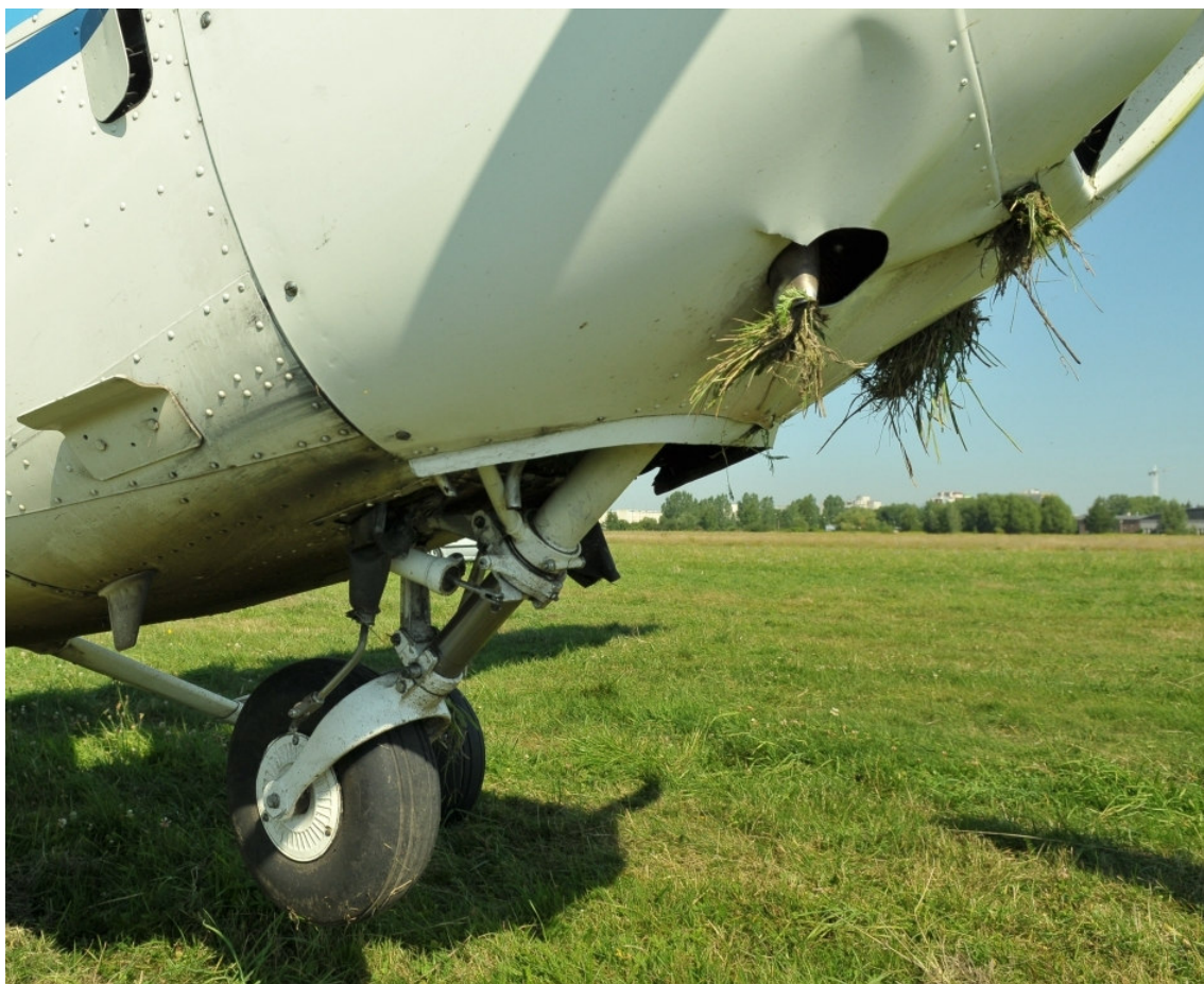
9 – Przednia część samolotu z prawej strony po uniesieniu kadłuba – widoczne uszkodzenia przedniego podwozia i osłon silnika.
