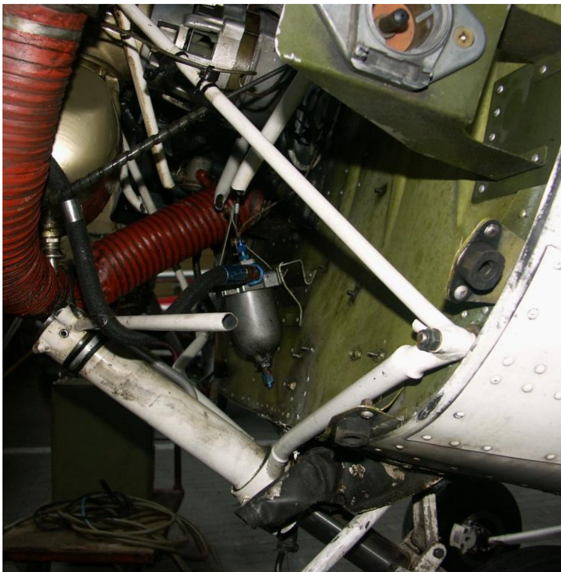
14 – Lewa strona komory silnika po zdjęciu osłon. Widoczne wytłamane podwozie przednie i zniszczenia łoża silnika.
