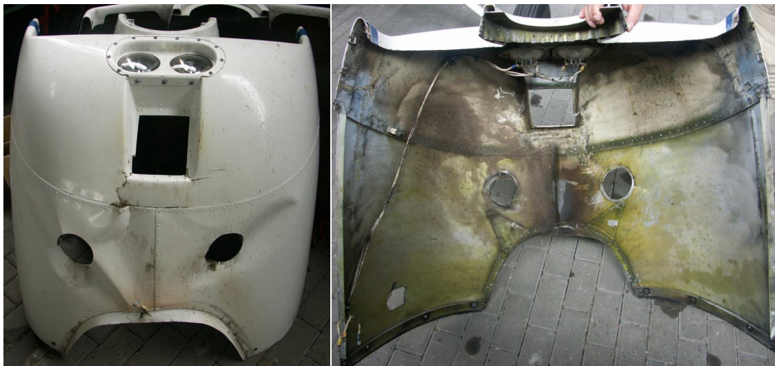
22 i 23 – Uszkodzona dolna osłona silnika od strony zewnętrznej i wewnętrznej.
