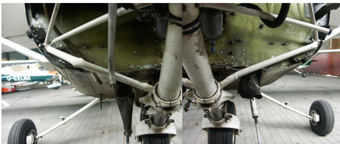
19 i 20 – Widok na prawą i lewą stronę dolnej części przegrody ogniowej. Widoczne uszkodzenia łoża silnika i podwozia przedniego.
