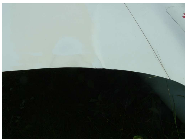
Rys. 13 Uszkodzenie skrzydła przy kadłubie.
