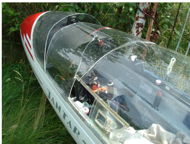
Rys. 12 Widoczne uszkodzenia oszklenia kabiny
