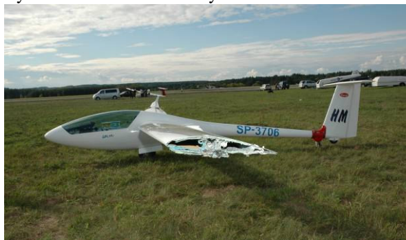
Rys. 8 Widok na uszkodzone skrzydła szybowca.
