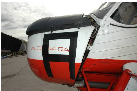
Rys. 3 Przód samolotu – widoczne „wybudowanie” silnika.
