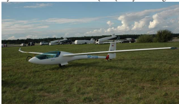
Rys. 7 Szybowiec Lak 19T po wypadku – widoczny brak doczepnej końcówki skrzydła lewego
