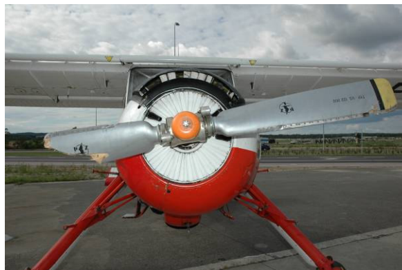
Rys. 2 Widok na samolot od przodu – widoczne uszkodzenia łopat śmigła
