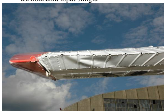
Rys.4 Widok na uszkodzoną końcówkę skrzydła lewego.
