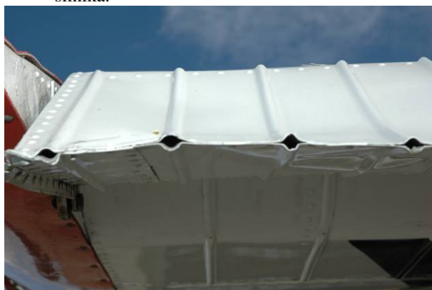
Rys.5 Widok na zdeformowaną lotkę skrzydła lewego.
