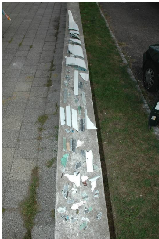
Rys. 9 Widok na rozczłonkowane części pozostałe po doczepnej końcówce skrzydła
