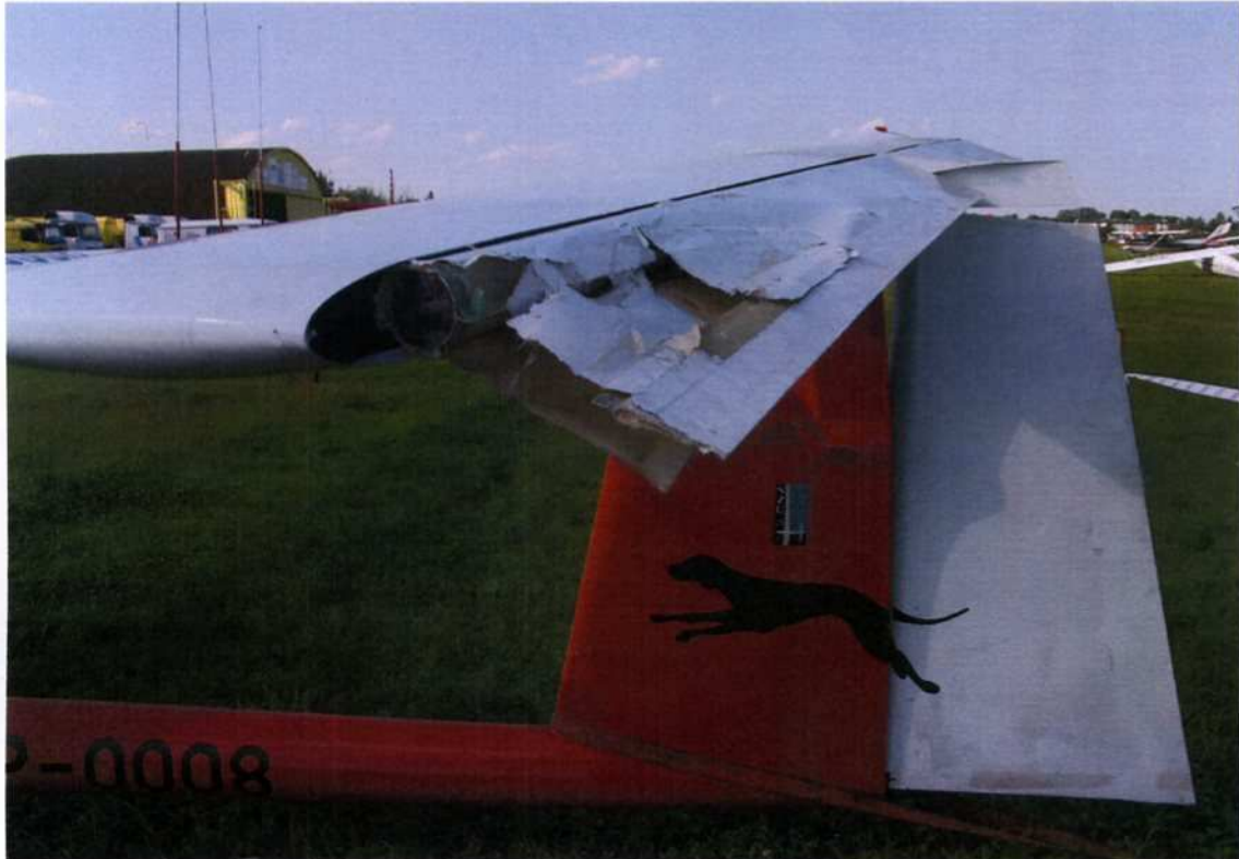
Fot. 2 Widok uszkodzeń usterzeń poziomego i pionowego
