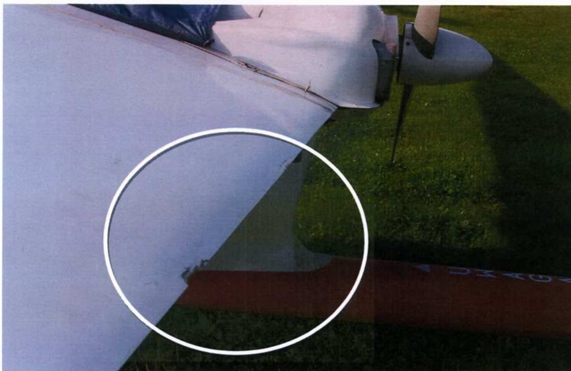
Fot. 3 Uszkodzenia krawędzi spływu skrzydła lewego.
