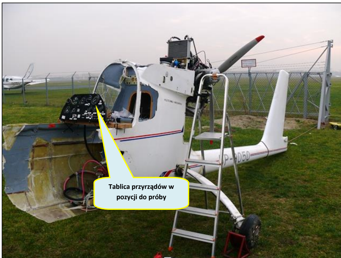
Ilustracja 1. Motoszybowiec po wypadku przygotowany do próby zużycia paliwa.
