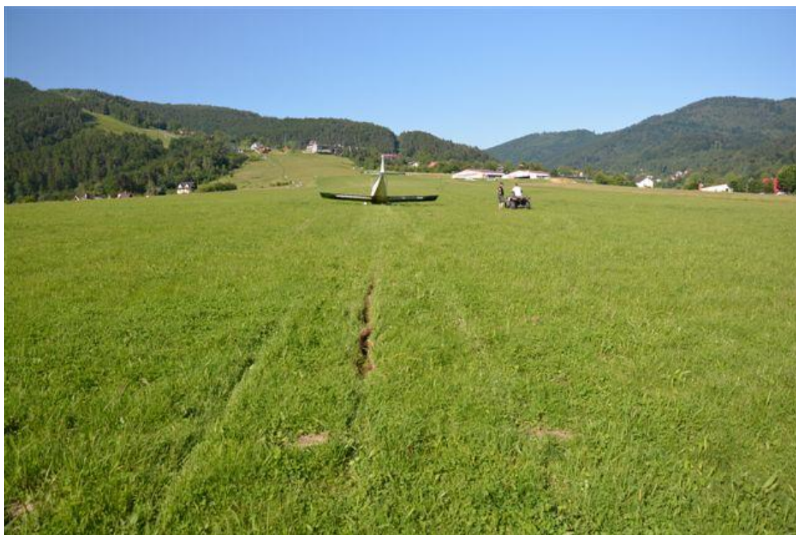
Rys.5. Samolot po dobiegu – widoczna głęboka bruzda po przednim kole. [foto pilot]
