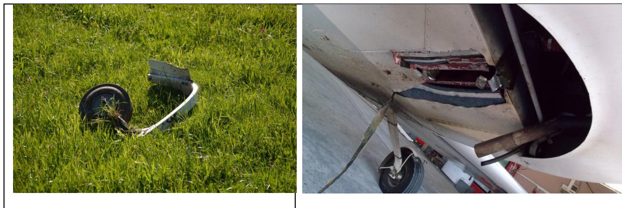
Rys.1. Zdjęcie po lewej – wyrwane z dolnej części poszycia kadłuba podwozie przednie. Zdjęcie po prawej – uszkodzone dolne poszycie kadłuba. [foto PKBWL]
