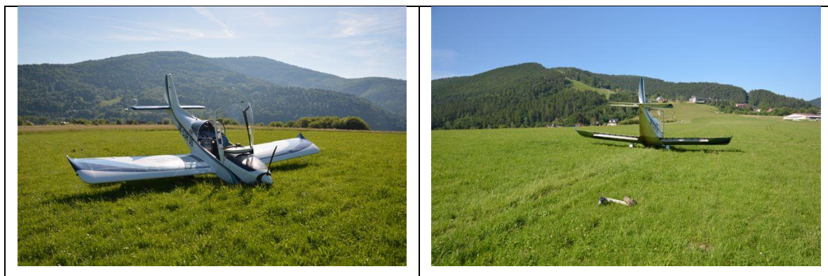
Rys.4. Samolot po zakończonym dobiegu – zdjęcie po lewej. Na zdjęciu po prawej widoczna oderwana goleń przedniego podwozia wraz z kołem. [foto pilot]
