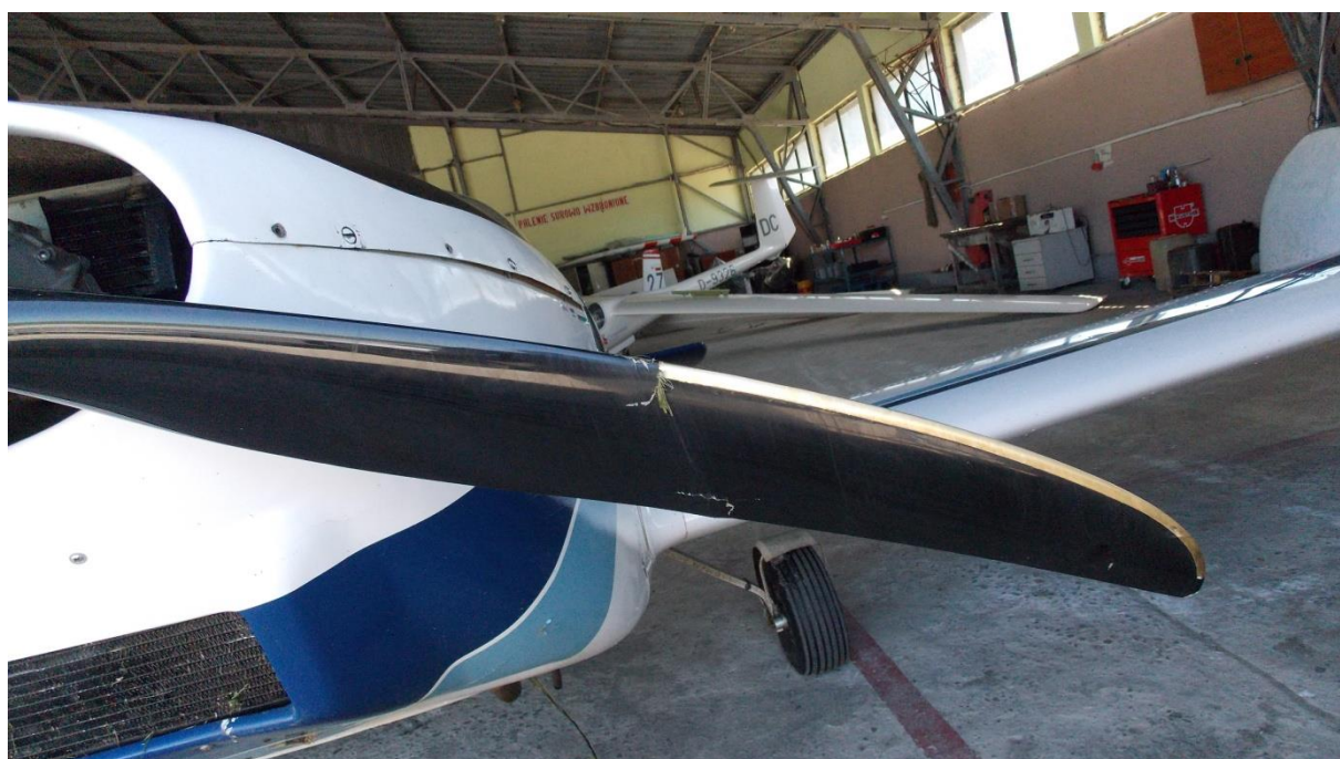
Rys.2. Uszkodzona łopata śmigła. [foto PKBWL]
