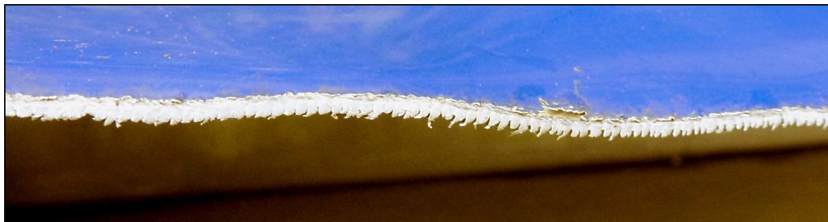
60 – Samolot Reims-Cessna F152 SP-APL na miejscu wypadku. Widok krawędzi rozcięcia blachy pokrycia usterzenia.
