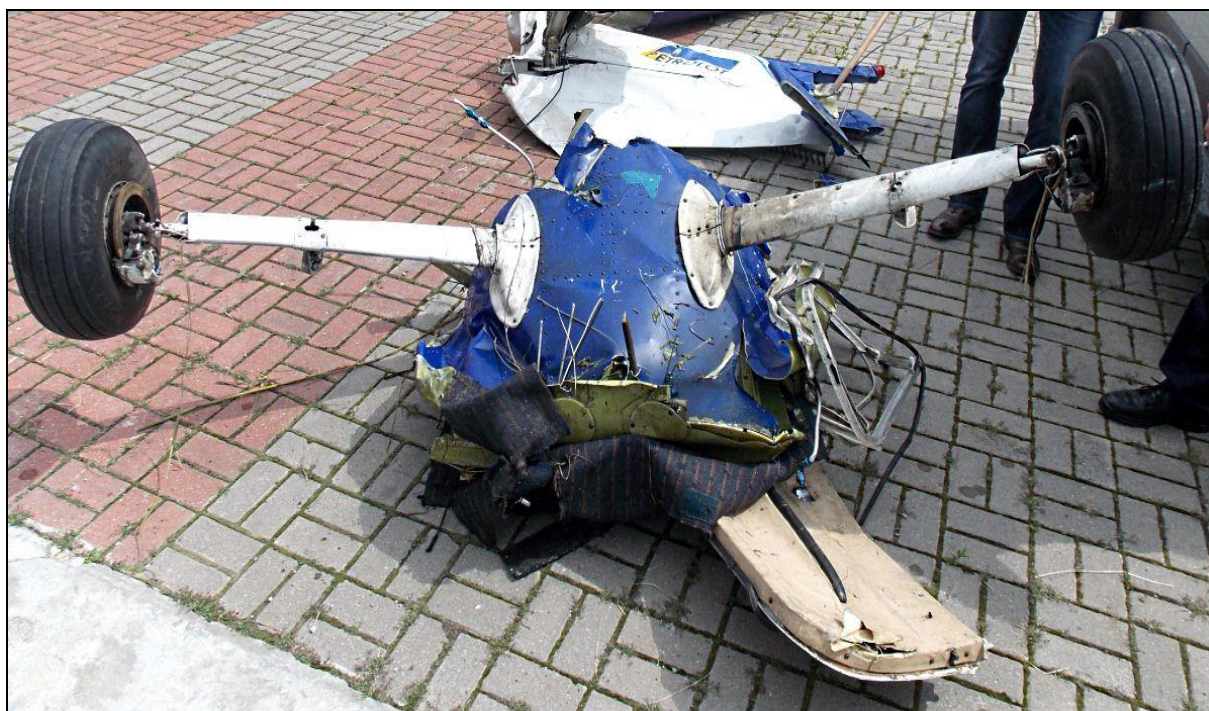
65 – Wycięty fragment kadłuba z podwoziem głównym.
