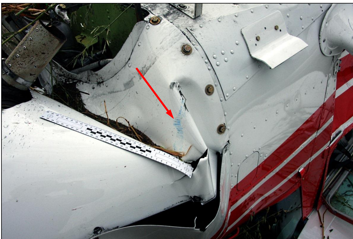
21 – Samolot SP-KGK na miejscu awaryjnego lądowania – zbliżenie na przednią część kadłuba z prawej strony od przodu. Dobrze widoczne uszkodzenia dolnej osłony silnika i wskazany strzałką niewątpliwy ślad kolizji z usterzeniem samolotu SP-APL – resztką niebieskiej farby. [foto: KGP Radom]
