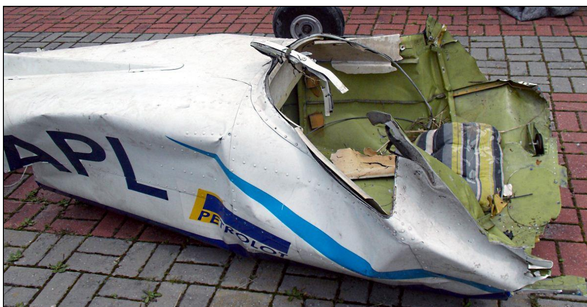
73 – Fragment tylnej części kadłuba. Został on odcięty od kabinowej części kadłuba przez straż pożarną podczas wydobywania wraku.
