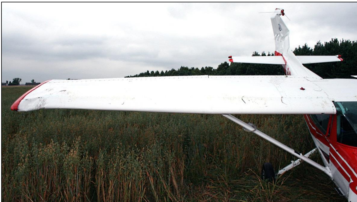
24 – Samolot SP-KGK na miejscu awaryjnego lądowania po podniesieniu i postawieniu na podwoziu głównym – widoczne lokalne uszkodzenia górnej powierzchni prawego skrzydła. [foto: KGP Radom]
