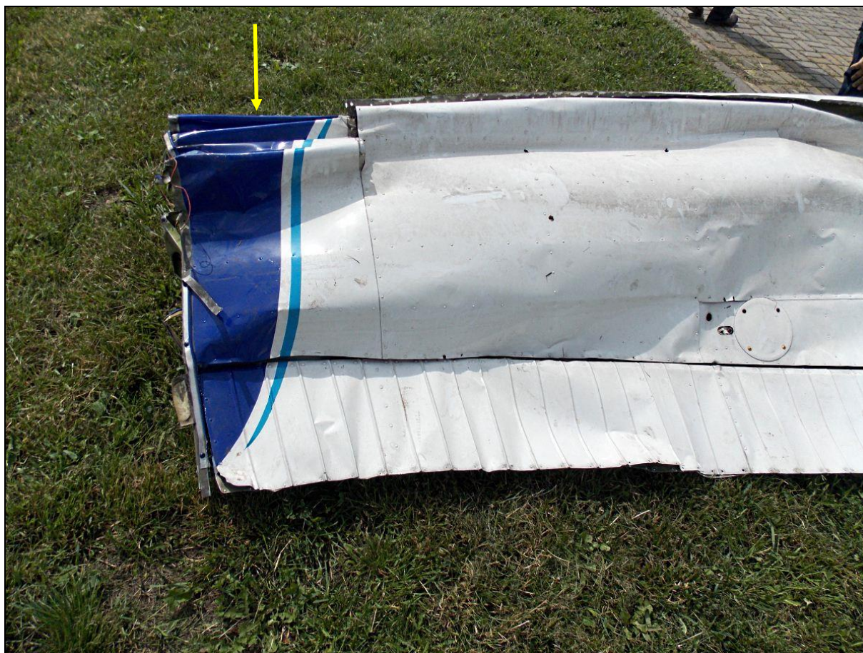
79 – Końcówka prawego skrzydła od dołu. Widoczna lotka i charakterystyczne „zmarszczki” na części noskowej, spowodowane uderzeniem w podatne pokrycie.
