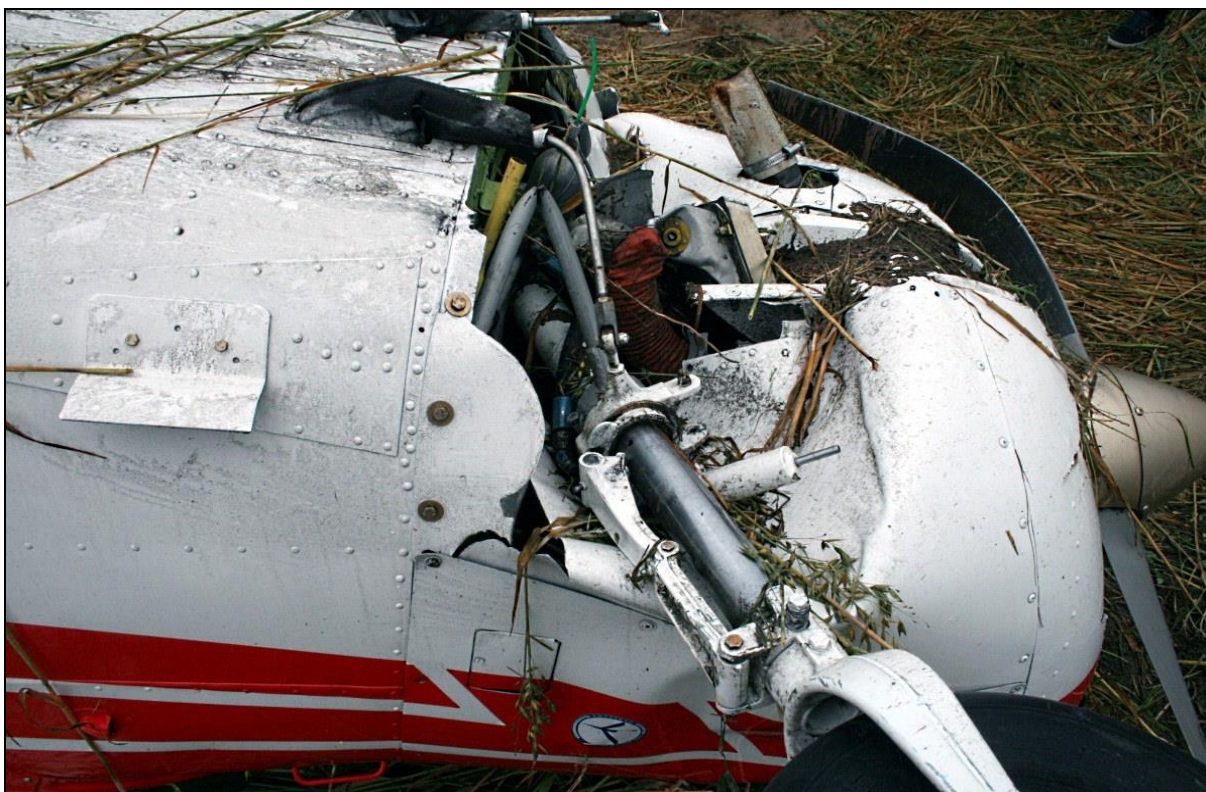
18 – Samolot SP-KGK na miejscu awaryjnego lądowania – zbliżenie na przednią część kadłuba z lewej strony. Dobrze widoczna zniszczona dolna osłona silnika, wyłamane podwozie przednie i zniszczone śmigło. [foto: KGP Radom]
