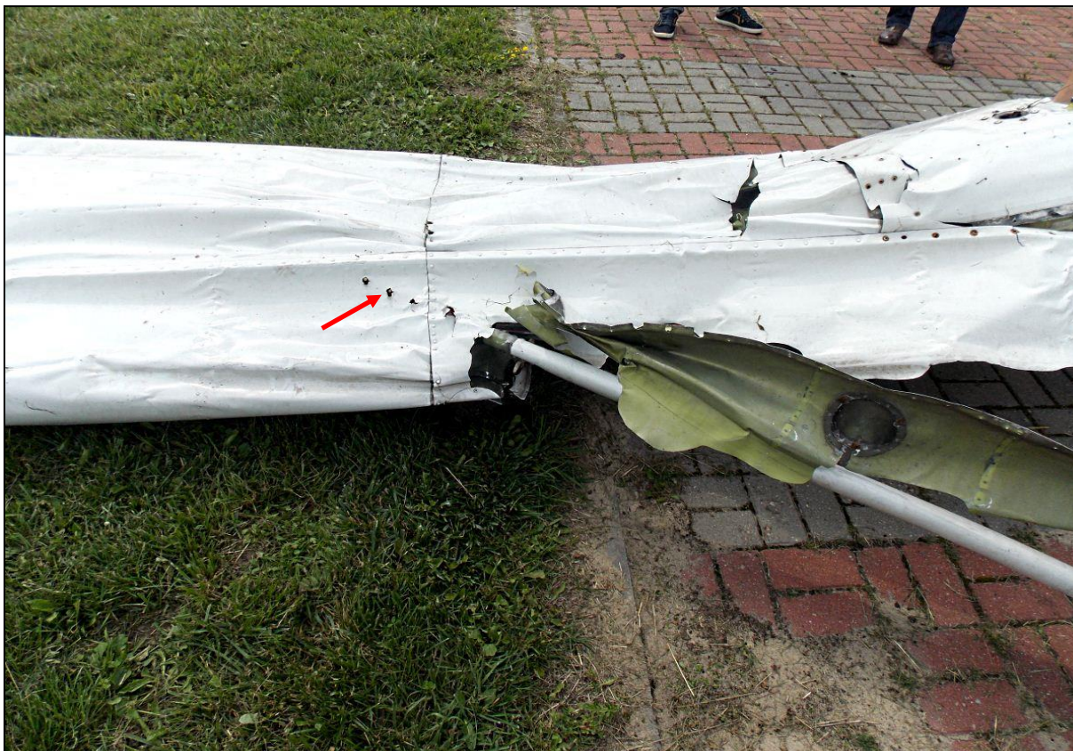
86 – Środkowa część prawego skrzydła od góry. Widoczne zamocowanie zastrzału, którego śruby przebiły blachę pokryciową noska (czerwona strzałka) oraz charakterystyczne „zmarszczki” na części noskowej i kesonie, spowodowane uderzeniem w podatną nawierzchnię.
