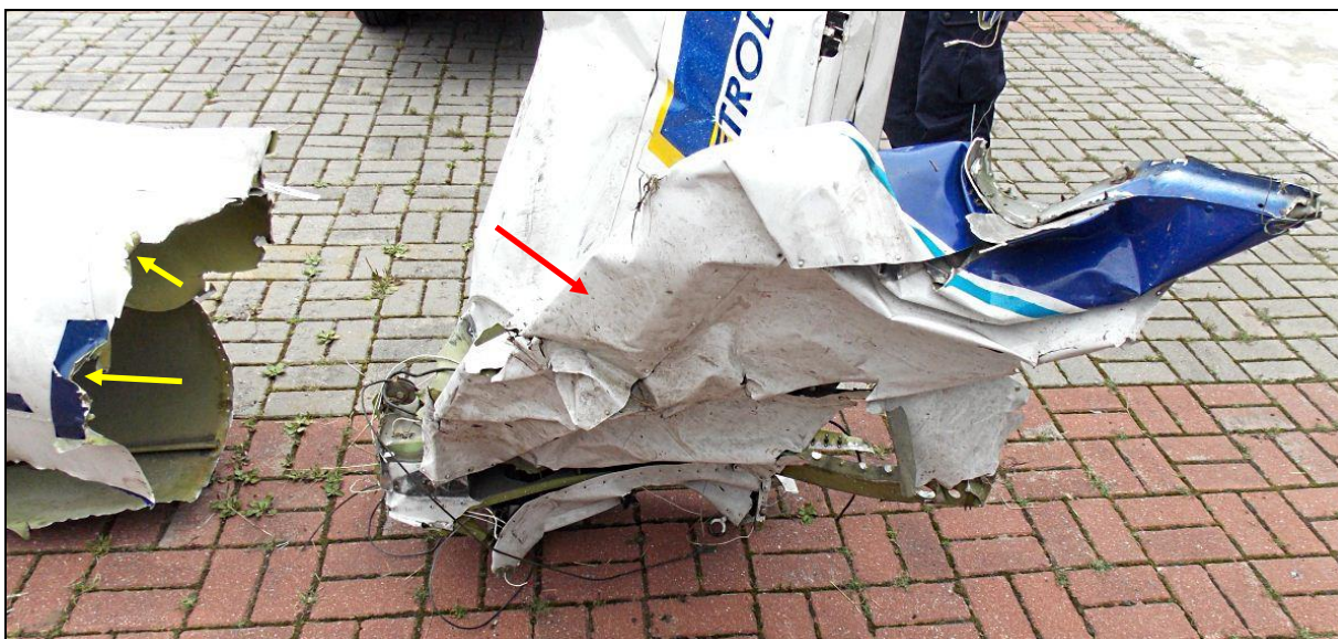
70 – Odnaleziona część usterzenia i fragment tylnej części kadłuba. Czerwoną strzałką wskazana charakterystycznie zniszczona lewa połówka usterzenia poziomego, żółtymi – sposób wywinięcia krawędzi blach pokrycia tylnej części kadłuba w miejscu jej odcięcia śmigłem samolotu SP-KGK.
