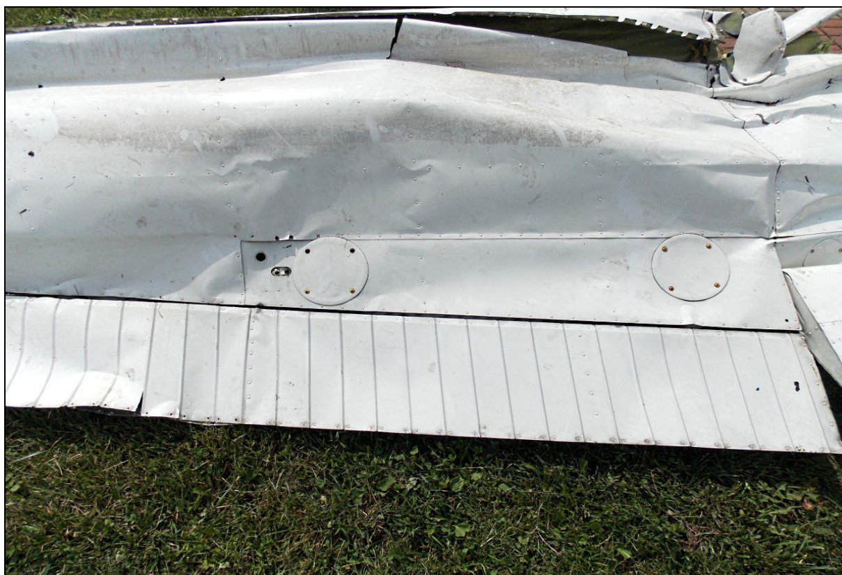
80 – Środkowa część prawego skrzydła od dołu. Widoczna lotka i charakterystyczne „zmarszczki” na części noskowej i kesonie, spowodowane uderzeniem w podatne pokrycie.
