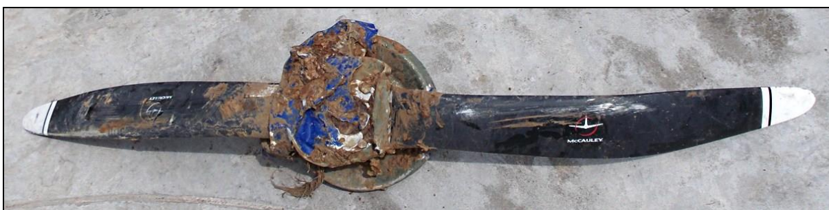
92 – Zniszczone śmigło od strony zewnętrznej. Na łopatach brak śladów kontaktu z twardymi przedmiotami.
