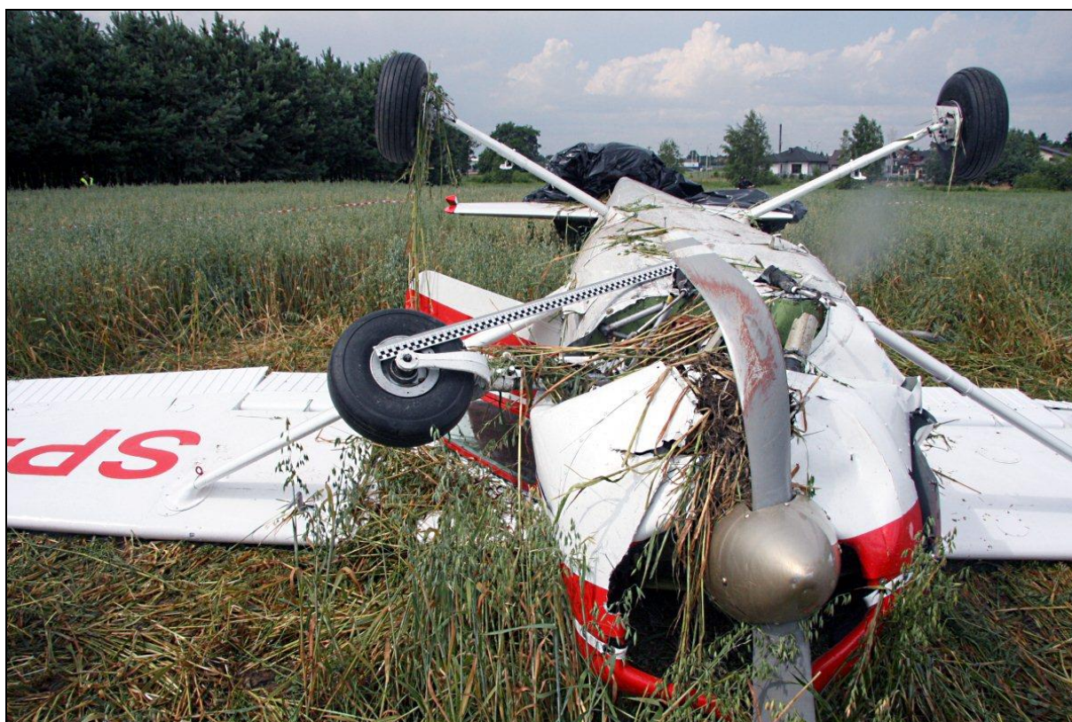
11 – Samolot SP-KGK na miejscu awaryjnego lądowania – zbliżenie na przednią część kadłuba, silnik i śmigło. Dobrze widoczne wyłamane podwozie przednie. Śmigło w położeniu takim, jak bezpośrednio po lądowaniu [foto: KGP Radom]
