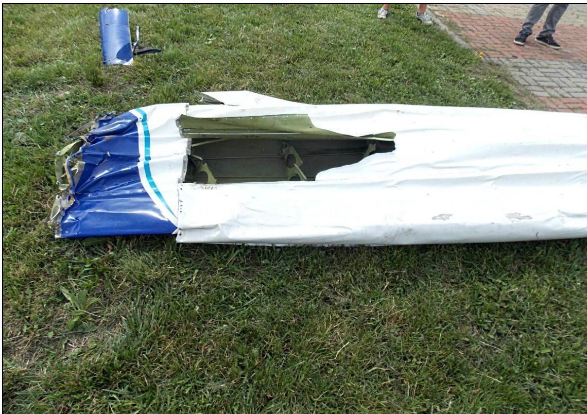
85 – Końcówka prawego skrzydła od góry. Widoczne rozdarcie blachy pokryciowej i charakterystyczne „zmarszczki” na części noskowej i kesonie, spowodowane uderzeniem w podatną nawierzchnię.
