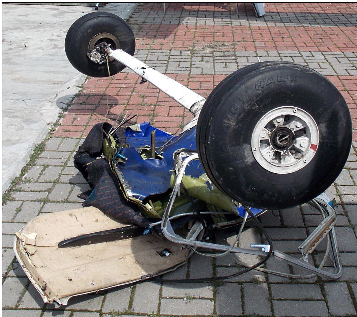
66 – Wycięty fragment kadłuba z podwoziem głównym.
