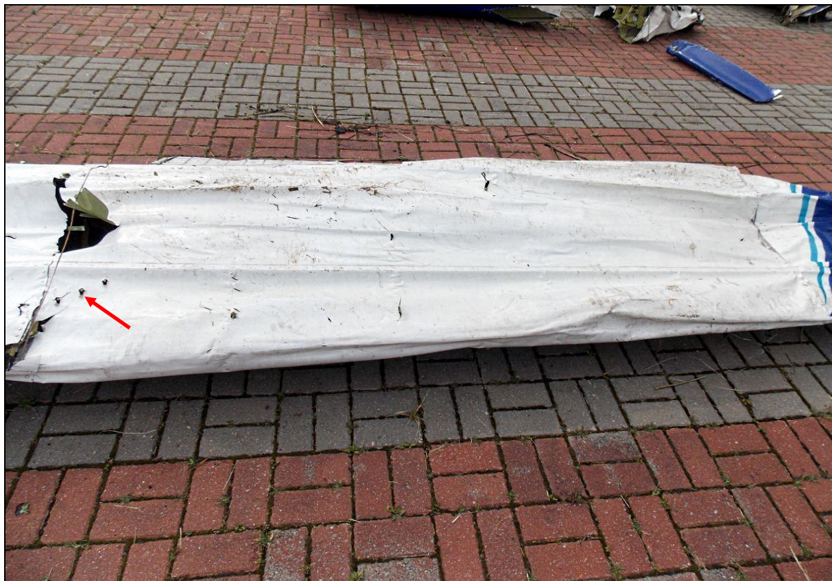
89 – Końcówka lewego skrzydła od góry. Widoczne rozdarcie blachy pokryciowej i charakterystyczne „zmarszczki” na części noskowej i kesonie, spowodowane uderzeniem w podatną nawierzchnię.
