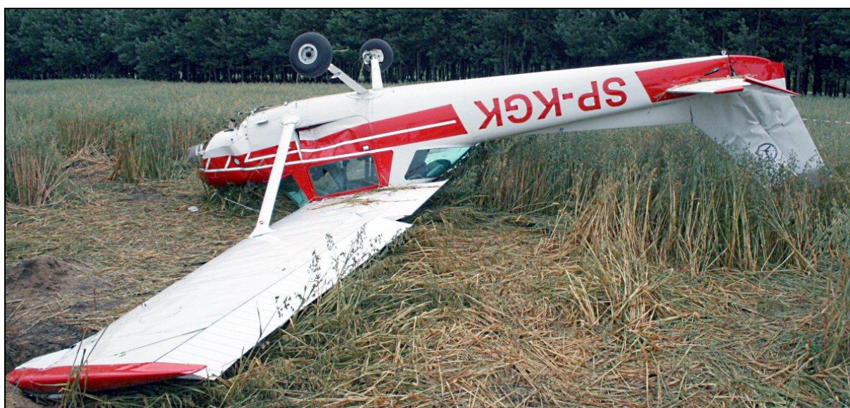
15 – Samolot SP-KGK na miejscu awaryjnego lądowania – zbliżenie z prawej strony. Dobrze widoczne uszkodzenia usterzenia pionowego. [foto: KGP Radom]
