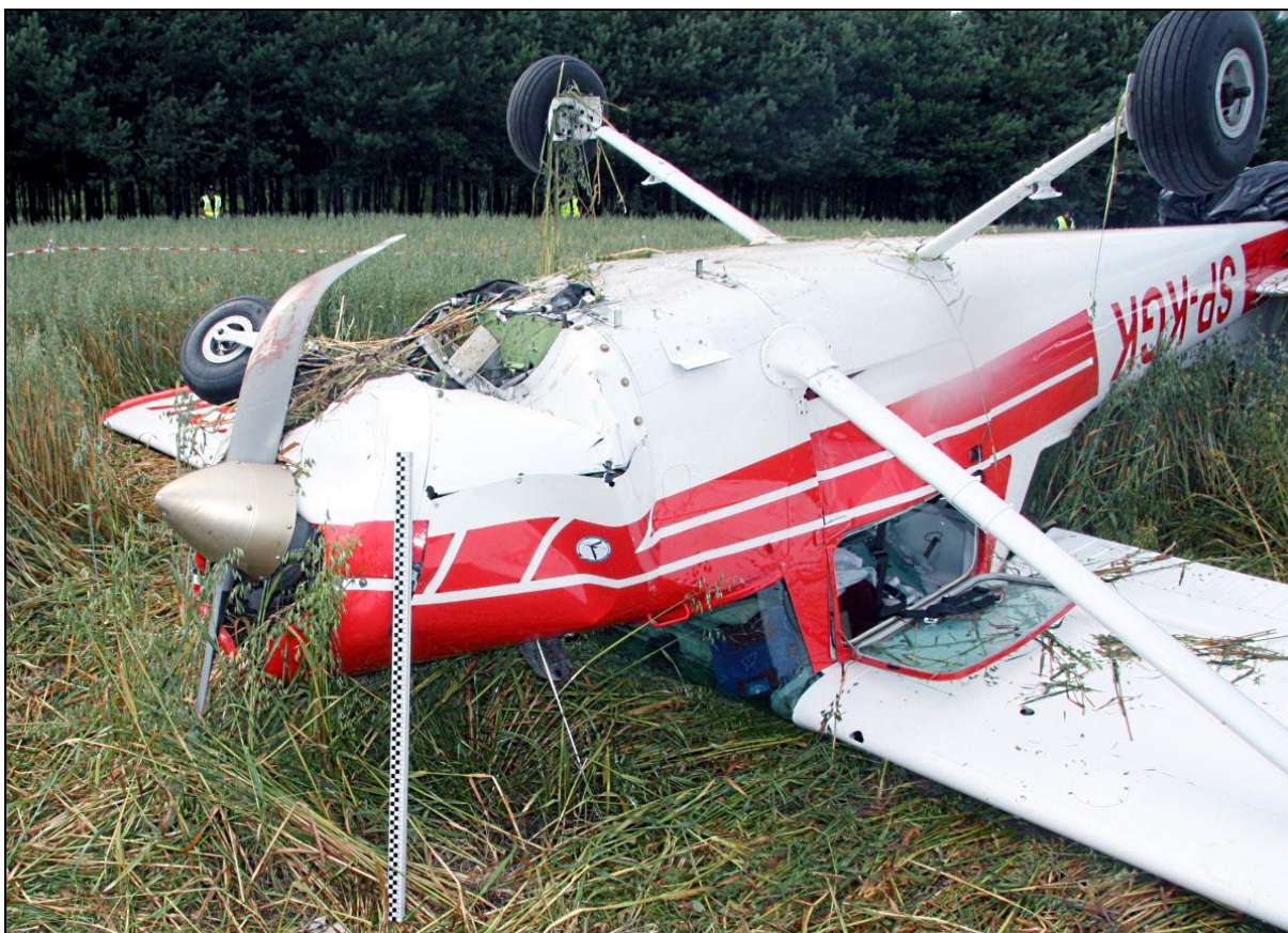
20 – Samolot SP-KGK na miejscu awaryjnego lądowania – zbliżenie na przednią część kadłuba z prawej strony od przodu. Dobrze widoczna zniszczona dolna osłona silnika, wyłamane podwozie przednie i zniszczone śmigło. [foto: KGP Radom]
