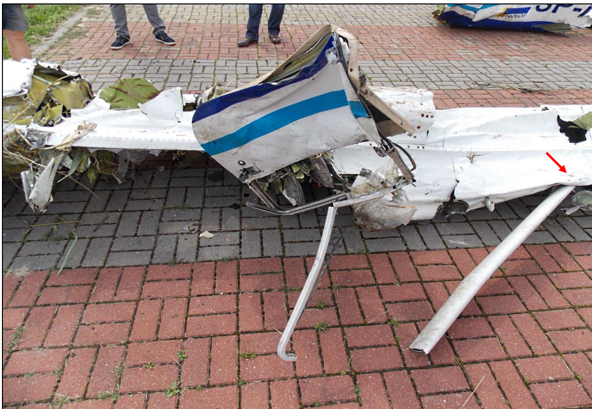
88 – Nasadowa część lewego skrzydła od góry. Widoczne zamocowanie zastrzału, którego śruby przebiły blachę pokryciową noska (czerwona strzałka), rozdarcie blachy oraz charakterystyczne „zmarszczki” na części noskowej i kesonie, spowodowane uderzeniem w podatną nawierzchnię.
