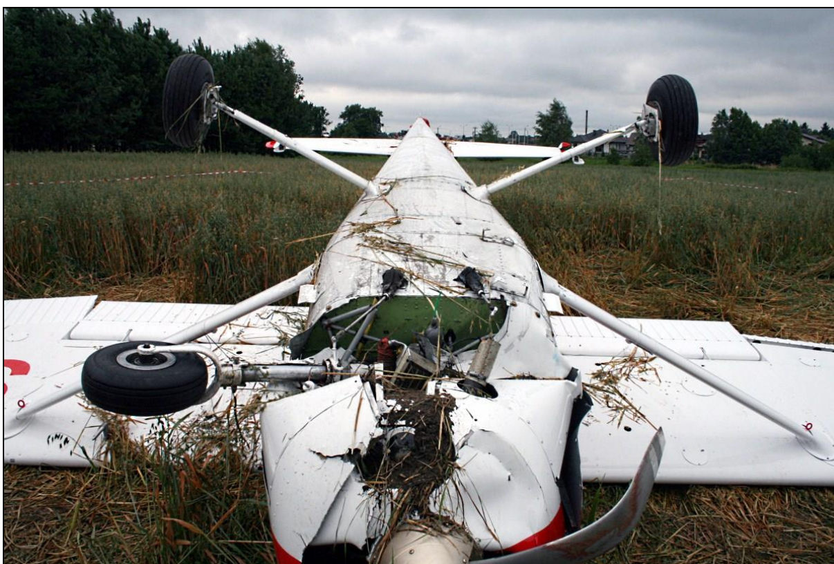
13 – Samolot SP-KGK na miejscu awaryjnego lądowania – zbliżenie na przednią część kadłuba, silnik i śmigło. Dobrze widoczne wyłamane podwozie przednie. Śmigło obrócone o ok. 90° [foto: KGP Radom]
