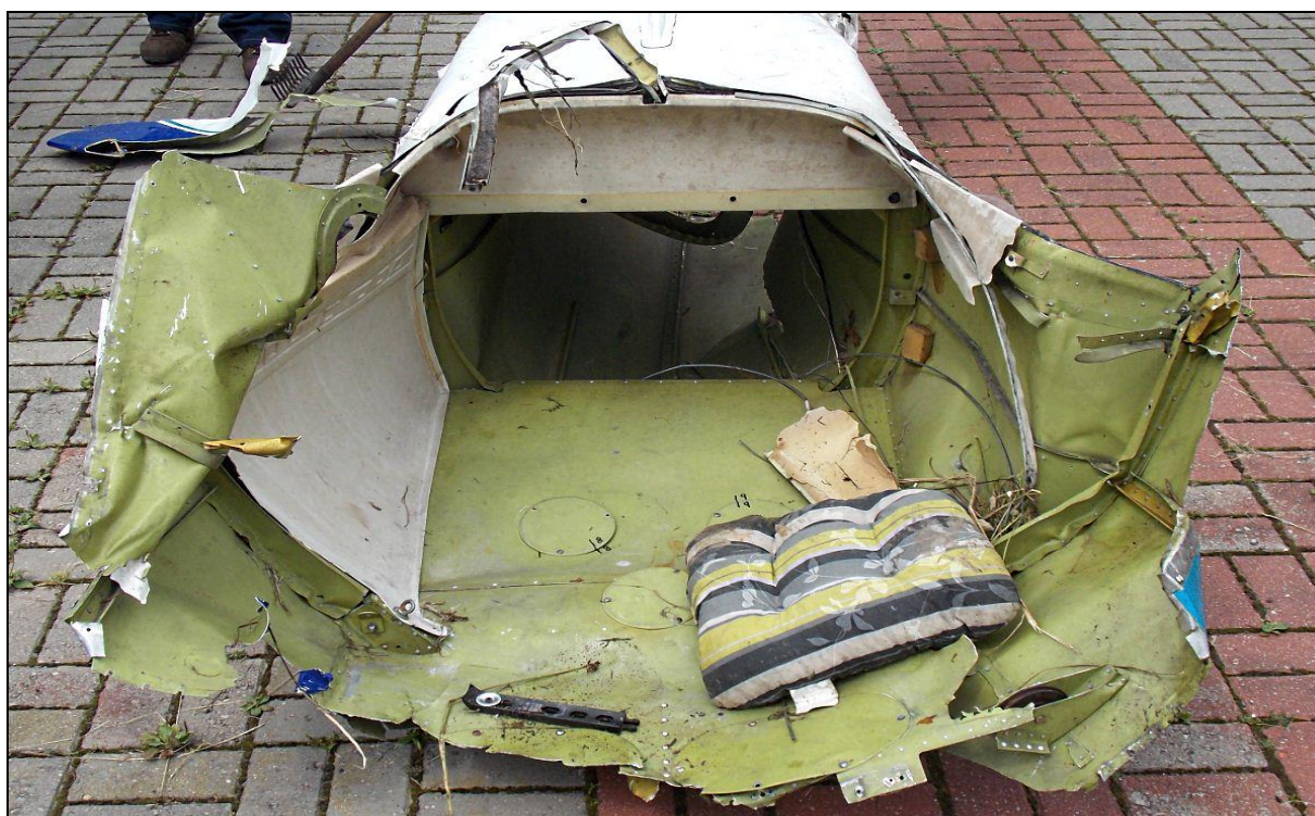
74 – Fragment tylnej części kadłuba. Został on odcięty od kabinowej części kadłuba przez straż pożarną podczas wydobywania wraku.
