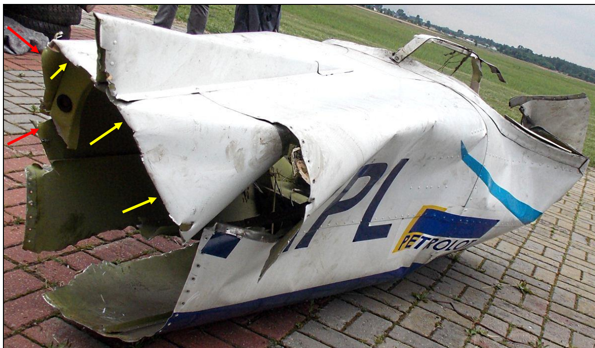
72 – Fragment tylnej części kadłuba. Strzałkami pokazany sposób wywinięcia krawędzi blach pokrycia tylnej części kadłuba w miejscu jej odcięcia śmigłem samolotu SP-KGK – żółtymi ku środkowi od strony grzbietu i czerwonymi na zewnątrz po lewej stronie kadłuba.
