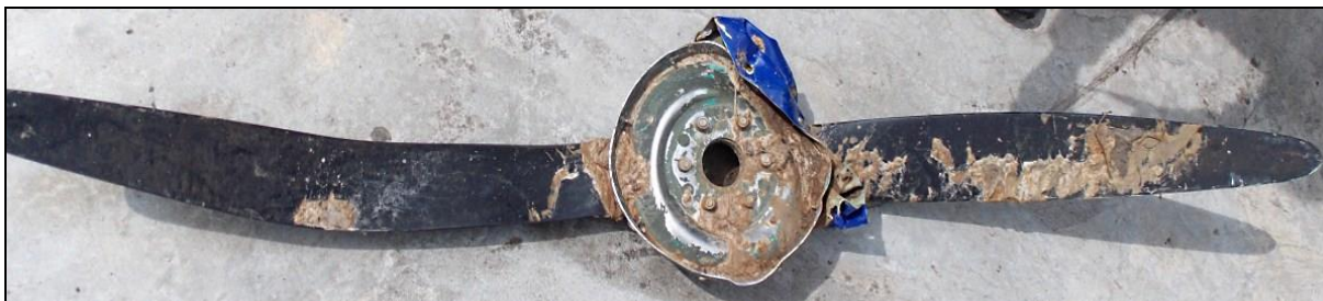
91 – Zniszczone śmigło od strony wewnętrznej. Na łopatach brak śladów kontaktu z twardymi przedmiotami.
