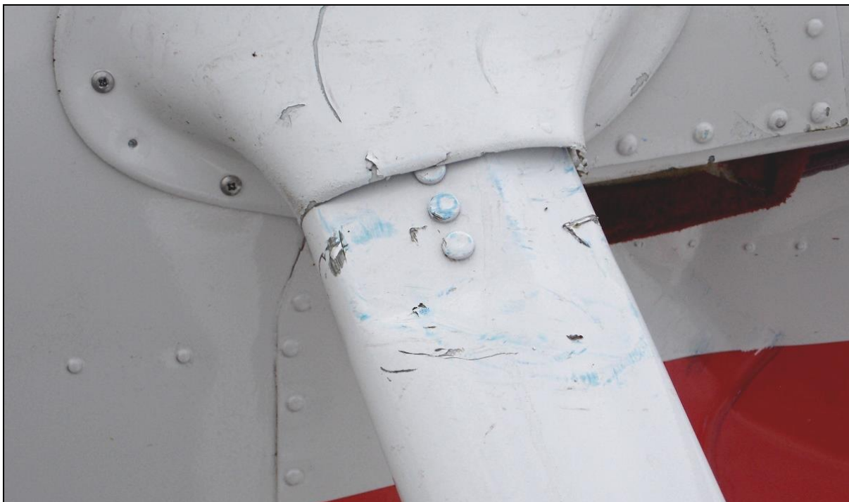
22 – Samolot SP-KGK na miejscu awaryjnego lądowania. Widoczne ślady niebieskiej farby z samolotu SP-APL u nasady prawego zastrzału skrzydła przy kadłubie. [foto: PKBWL]
