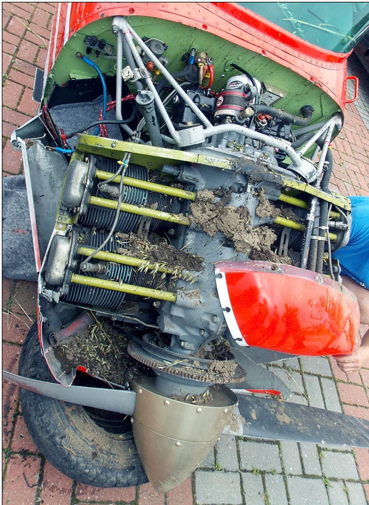
29 – Zespół napędowy – widoczne wyłamane łożo silnika, uszkodzone osłony i zniszczone śmigło.
