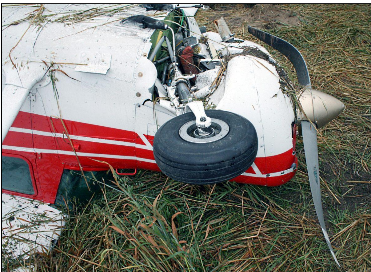
17 – Samolot SP-KGK na miejscu awaryjnego lądowania – zbliżenie na przednią część kadłuba z lewej strony. Dobrze widoczna zniszczona dolna osłona silnika, wyłamane podwozie przednie i zniszczone śmigło. [foto: KGP Radom]
