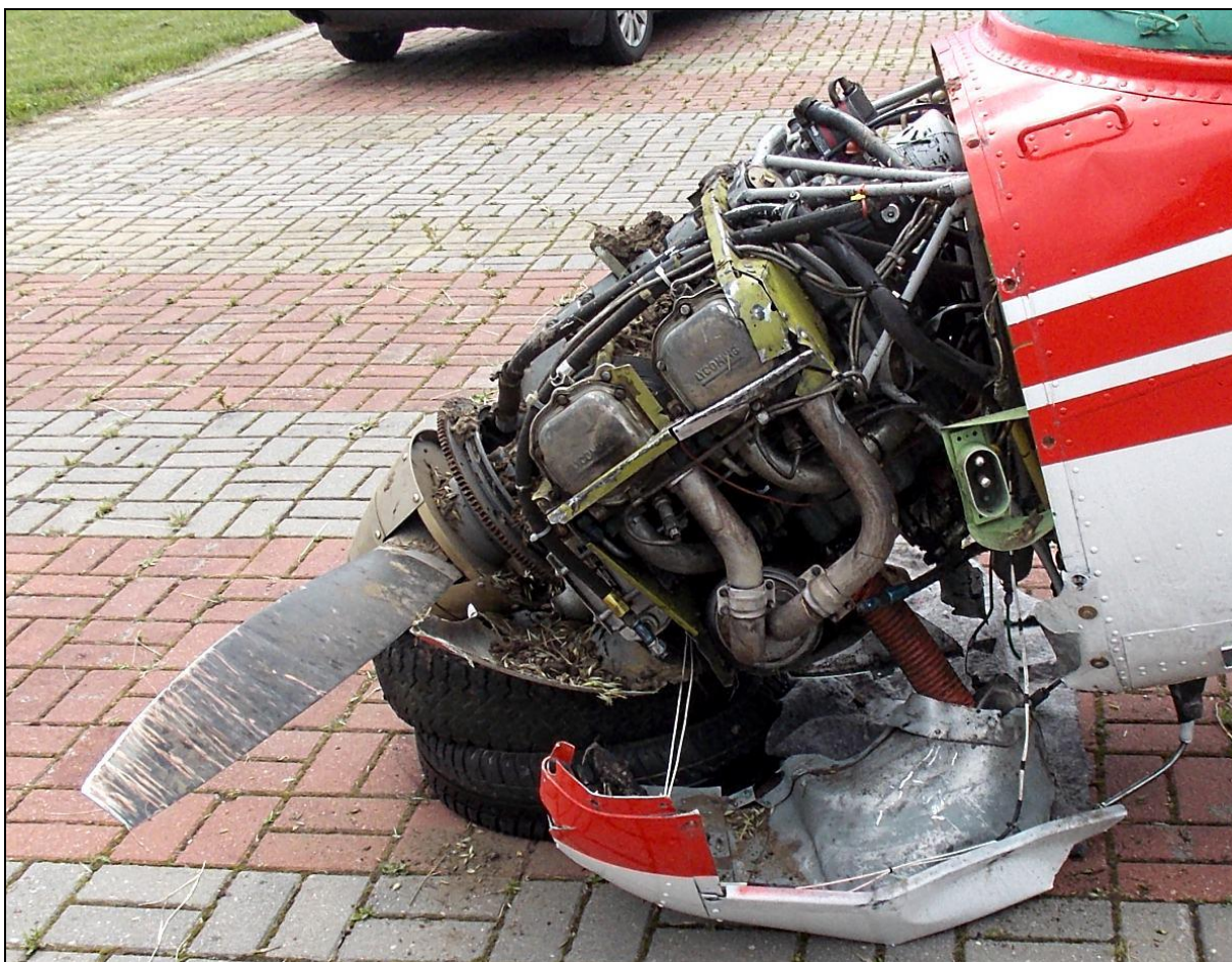
30 – Zespół napędowy z lewej strony - widoczne wylamane łożo silnika, uszkodzone osłony i zniszczone śmigło.
