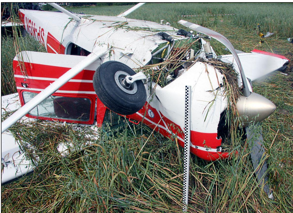
19 – Samolot SP-KGK na miejscu awaryjnego lądowania – zbliżenie na przednią część kadłuba z lewej strony od przodu. Dobrze widoczna zniszczona dolna osłona silnika, wyłamane podwozie przednie i zniszczone śmigło. [foto: KGP Radom]
