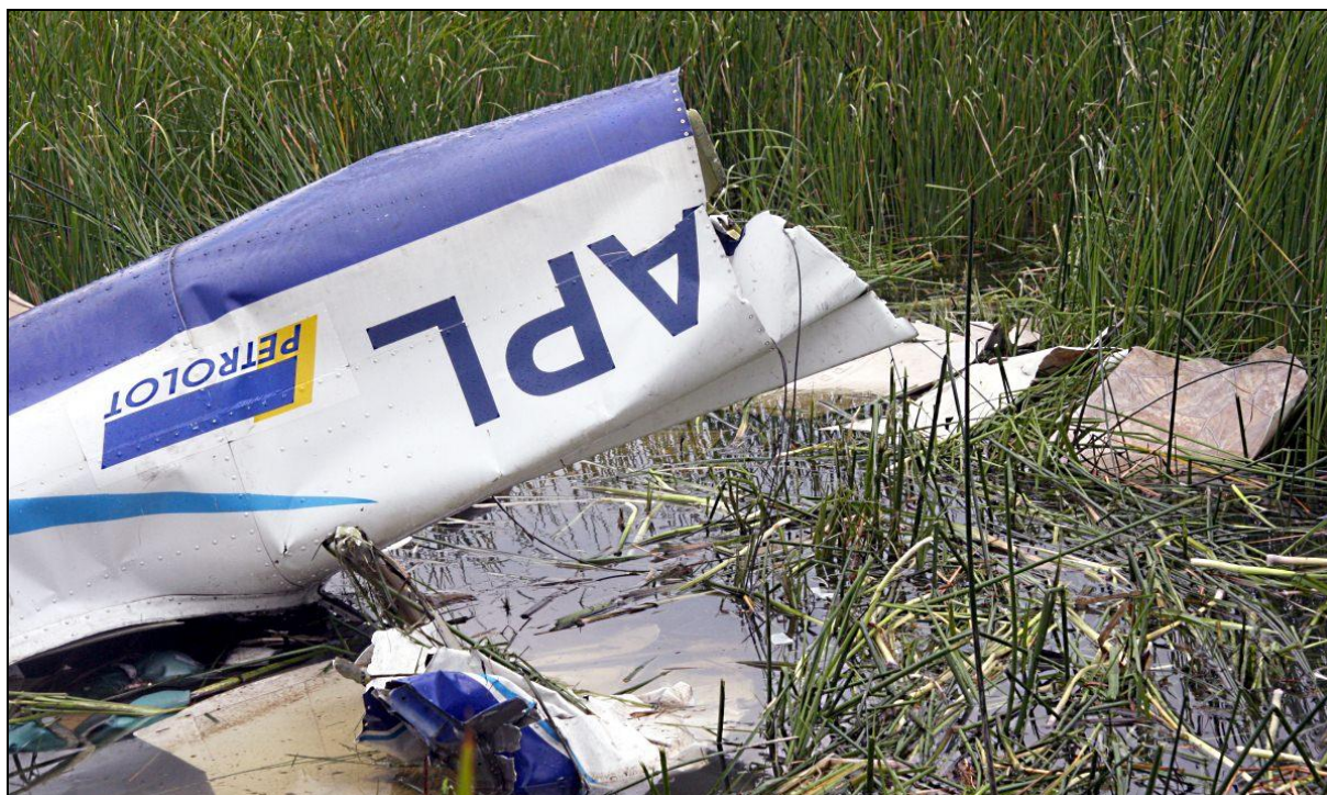
55 – Samolot Reims-Cessna F152 SP-APL na miejscu wypadku. Widok kadłuba w miejscu odcięcia jego tylnej części przez śmigło samolotu SP-KGK. [foto: KGP Radom]
