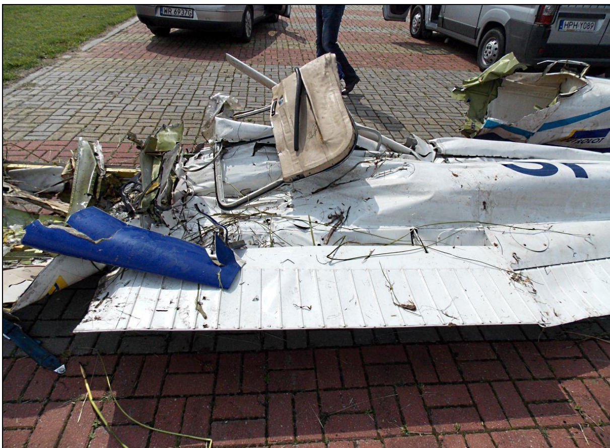
83 – Nasadowa część lewego skrzydła od dołu. Widoczny zastrzał, kłapa i charakterystyczne „zmarszczki” na części noskowej i kesonie, spowodowane uderzeniem w podatną nawierzchnię.
