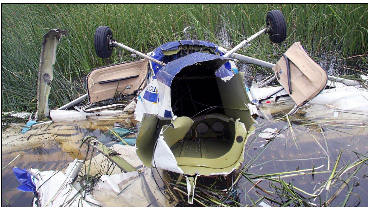
57 – Samolot Reims-Cessna F152 SP-APL na miejscu wypadku. Widok od tyłu na kadłub w miejscu jego odcięcia przez śmigło samolotu SP-KGK. [foto: KGP Radom]
