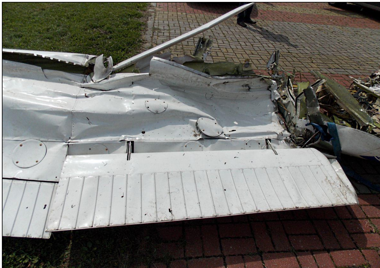
81 – Nasadowa część prawego skrzydła od dołu. Widoczny zastrzał, kłapa i charakterystyczne „zmarszczki” na części noskowej i kesonie, spowodowane uderzeniem w podatną nawierzchnię.
