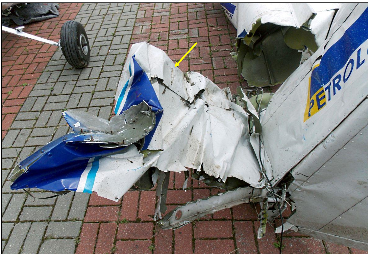
69 – Odnaleziona część usterzenia i fragment tylnej części kadłuba. Żółtą strzałką wskazana charakterystycznie zniszczona lewa połówka usterzenia poziomego.
