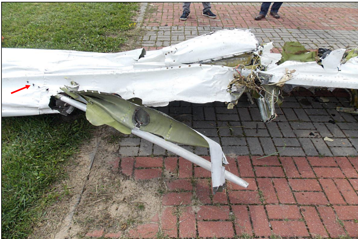
87 – Nasadowa część prawego skrzydła od góry. Widoczne zamocowanie zastrzału, którego śruby przebiły blachę pokryciową noska (czerwona strzałka) oraz charakterystyczne „zmarszczki” na części noskowej i kesonie, spowodowane uderzeniem w podatną nawierzchnię.
