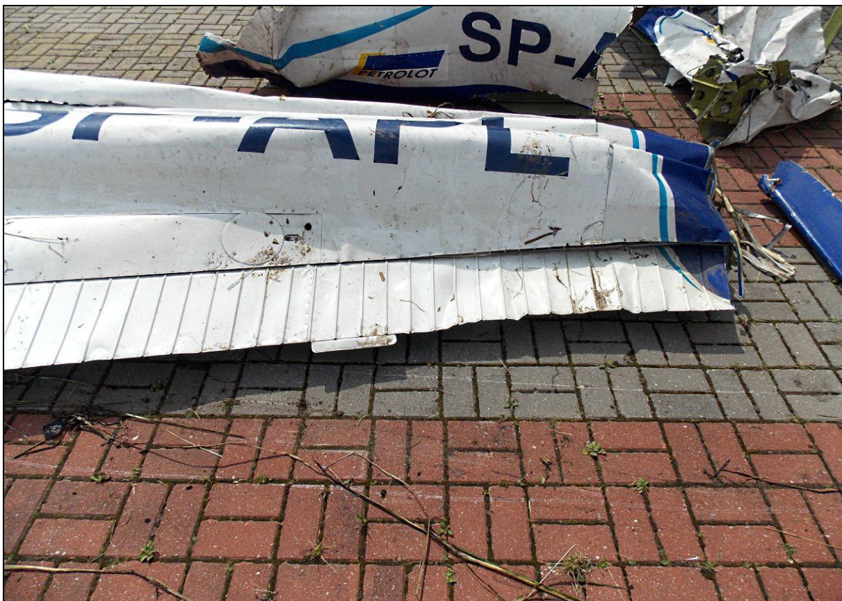
84 – Końcówka lewego skrzydła od dołu. Widoczna lotka i charakterystyczne „zmarszczki” na części noskowej i kesonie, spowodowane uderzeniem w podatną nawierzchnię.
