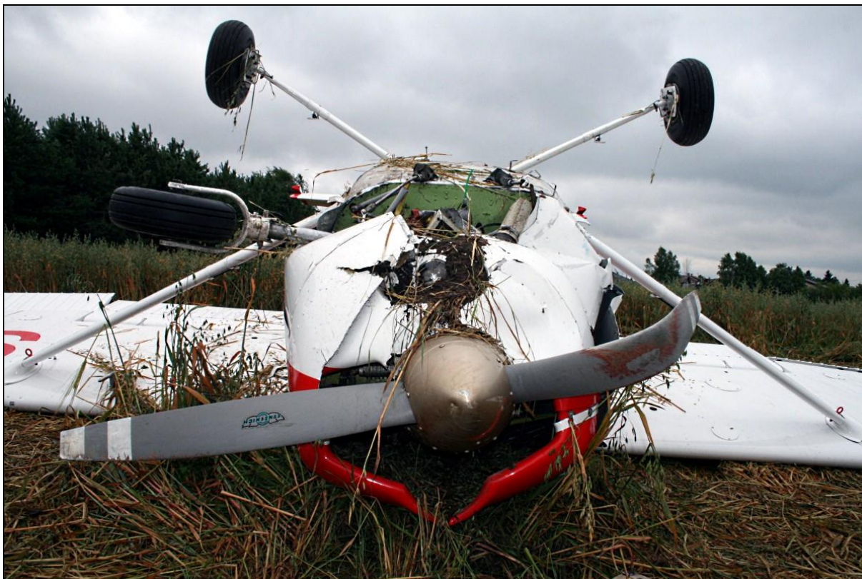
12 – Samolot SP-KGK na miejscu awaryjnego lądowania – zbliżenie na przednią część kadłuba, silnik i śmigło. Dobrze widoczne wyłamane podwozie przednie. Śmigło obrócone o ok.90° [foto: KGP Radom]
