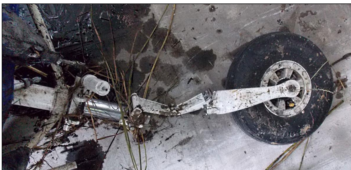
67 – Zniszczone podwozie przednie.
