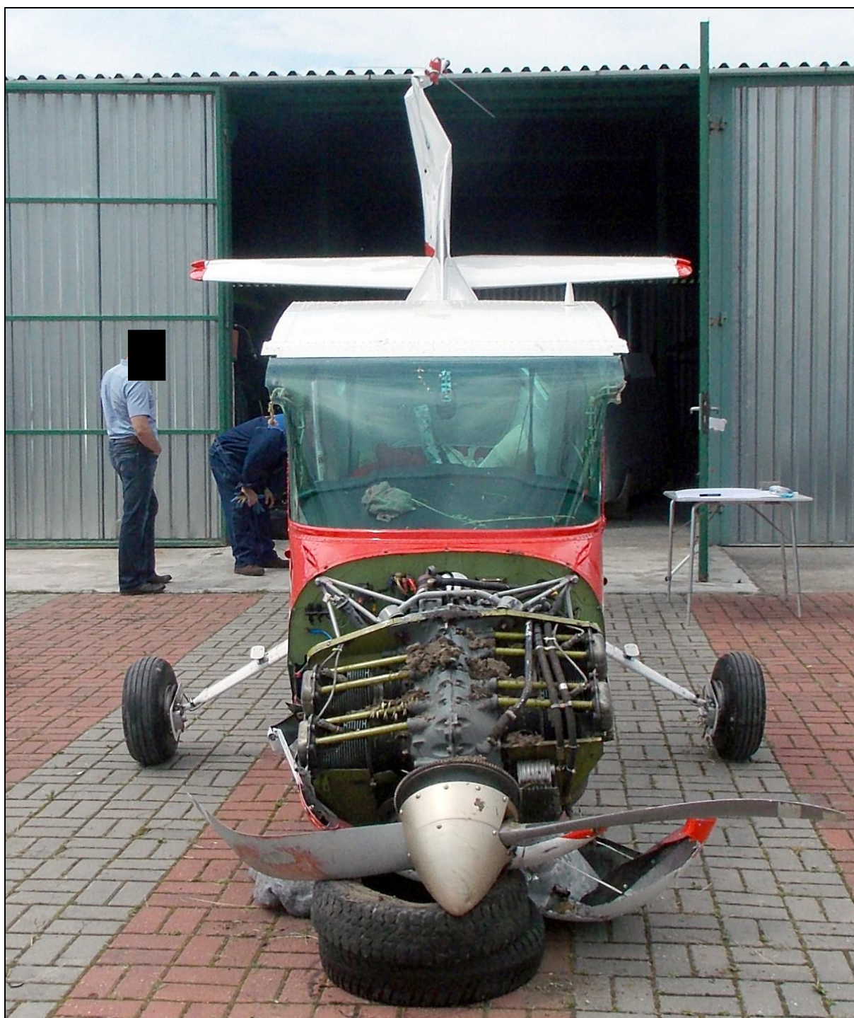
28 – Widok na kadłub od przodu – widoczne odkształcenie łoża silnika i zniszczenie śmigła.
