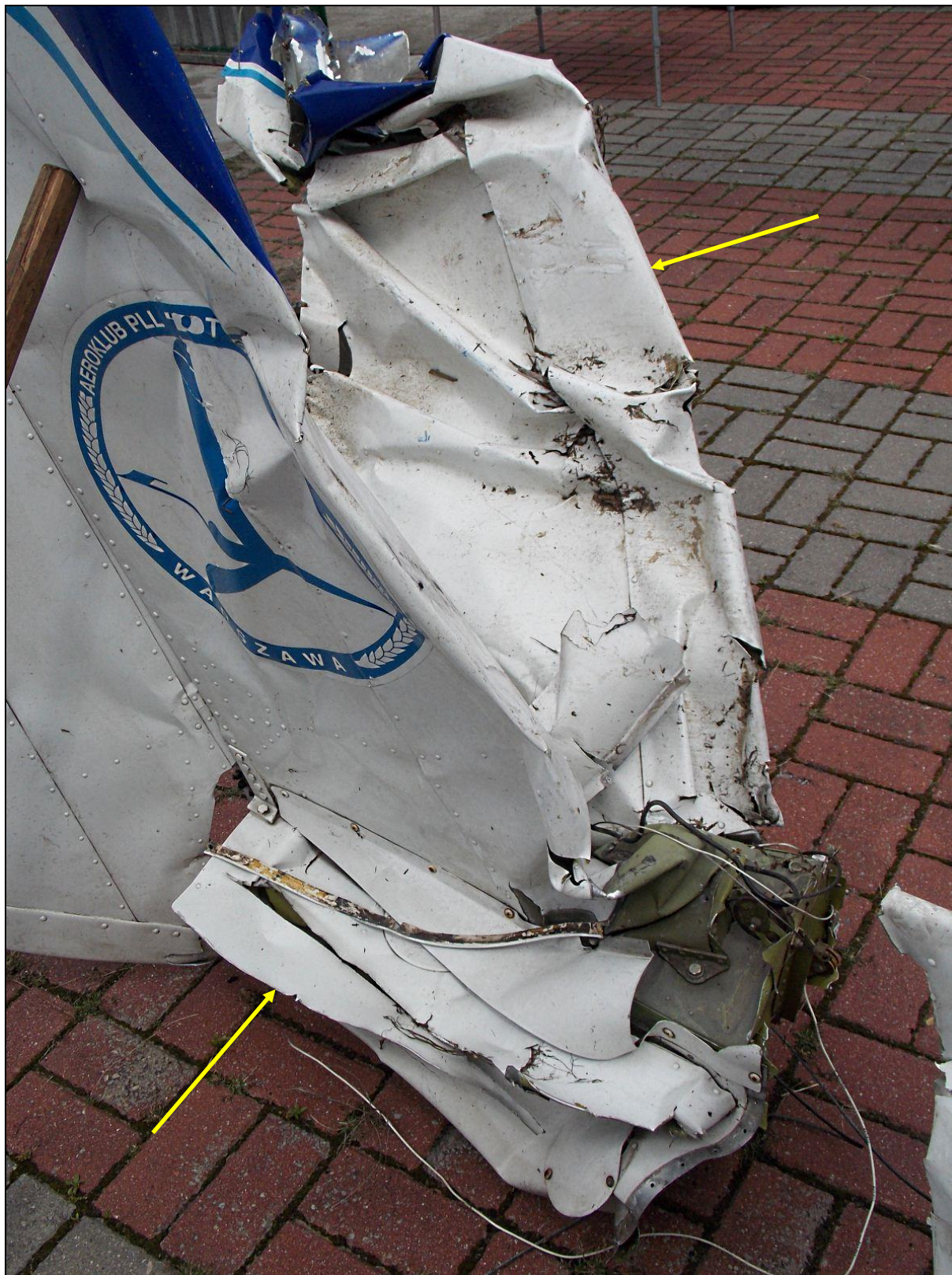
77 – Zbliżenie zniszczonego usterzenia i końcowego fragment kadłuba. Żółtymi strzałkami pokazana zniszczona lewa połowka usterzenia poziomego i resztkę prawej jego połowki, pozostała przy końcowej części kadłuba.
