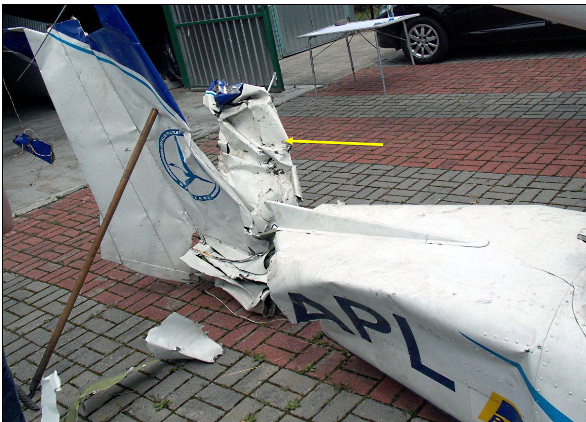
68 – Odnaleziona część usterzenia i fragment tylnej części kadłuba. Żółtą strzałką wskazana charakterystycznie zniszczona lewa połówka usterzenia poziomego. Prawej połówki usterzenia poziomego brak – nie odnaleziona.
