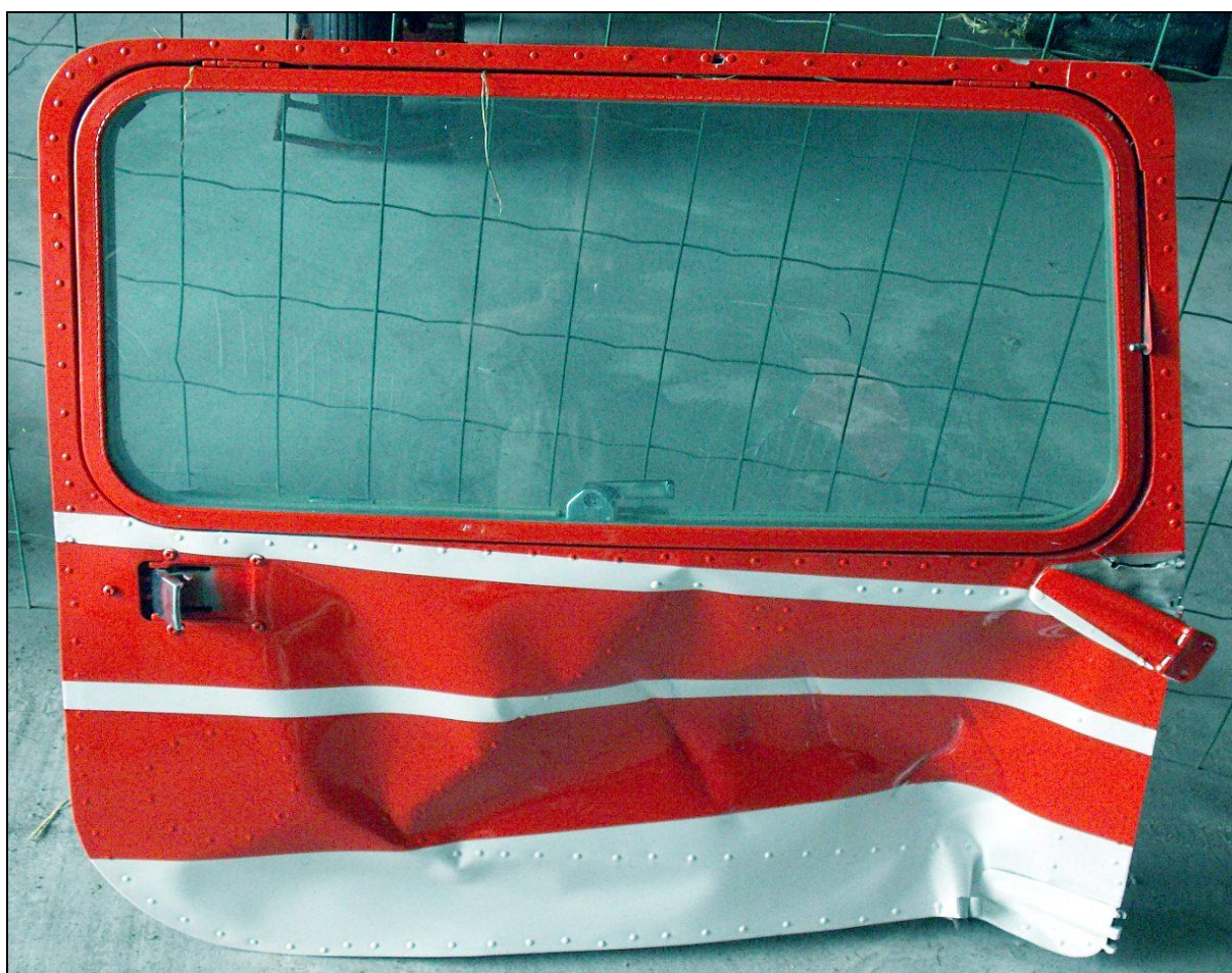
34 – Uszkodzone podczas zderzenia prawe drzwi kabiny.
