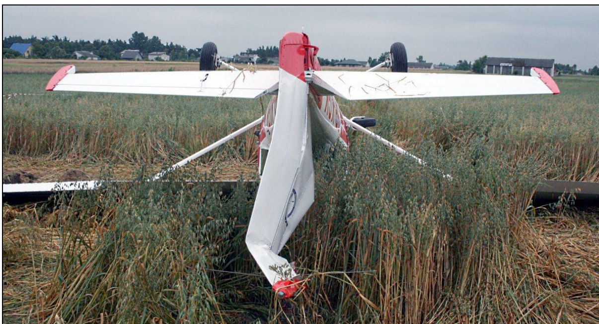
23 – Samolot SP-KGK na miejscu awaryjnego lądowania – widok od tyłu. Widoczne uszkodzenia usterzenia pionowego. [foto: KGP Radom]
