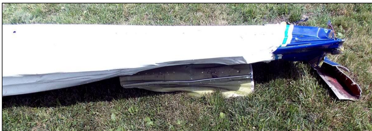
90 – Końcówka leżącego spodem do góry prawego skrzydła od strony noska. Widoczne rozdarcie górnej blachy pokryciowej.
