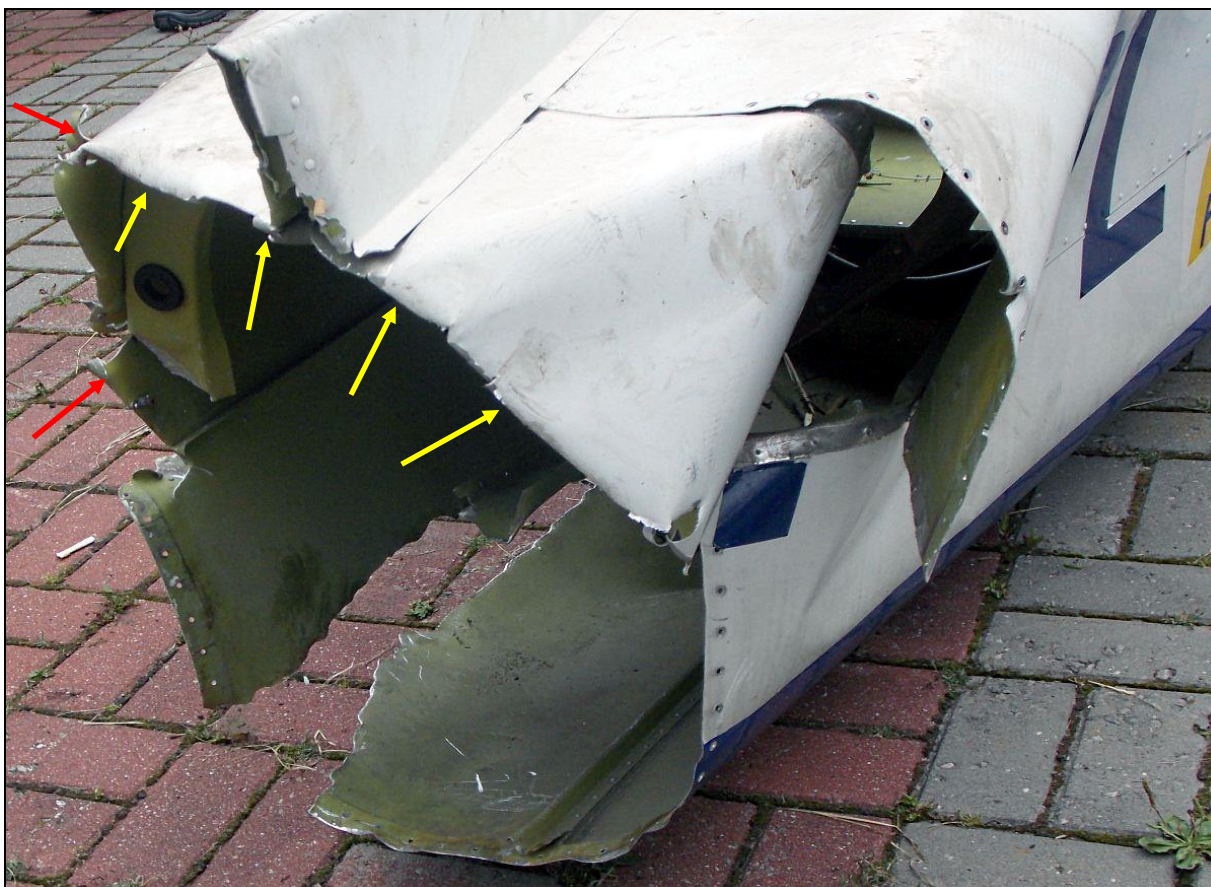
71 – Fragment tylnej części kadłuba. Strzałkami pokazany sposób wywinięcia krawędzi blach pokrycia tylnej części kadłuba w miejscu jej odcięcia śmigłem samolotu SP-KGK – żółtymi ku środkowi od strony grzbietu i czerwonymi na zewnątrz po lewej stronie kadłuba.
