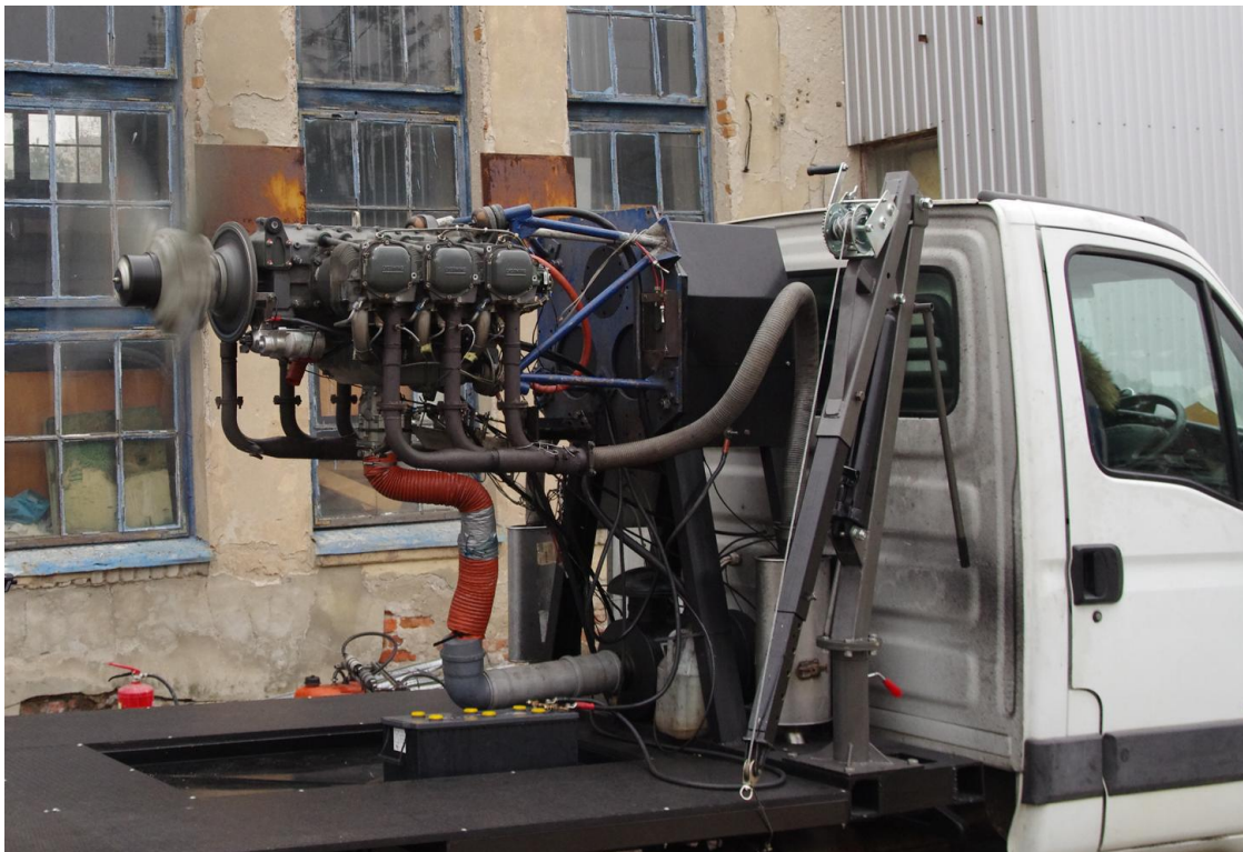
Rys. 21. Silnik zabudowany na stanowisku do hamowania podczas próby.
