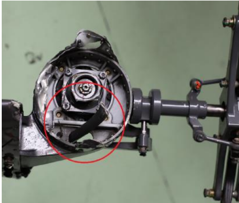
Rys. 1. Przerwanie popychacza sterowania śmigłem ogonowym w okolicach przekładni śmigła ogonowego. Widoczny dalsza część układu sterowania za przerwanym popychaczem.
