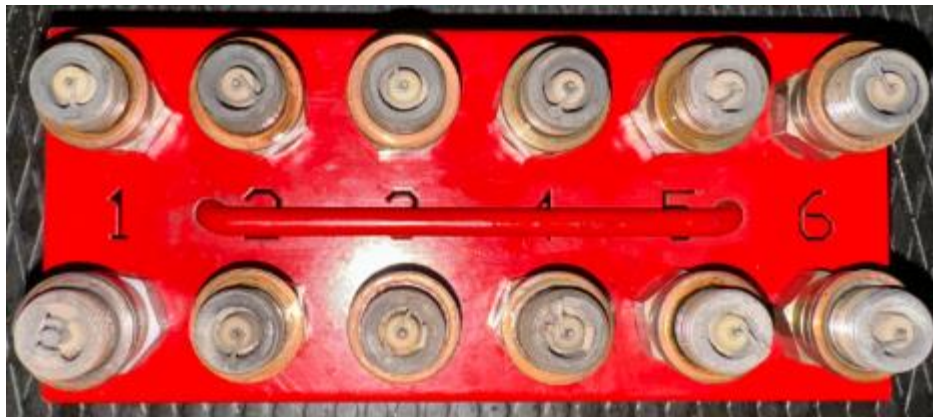
Rys. 18. Świece zapłonowe zdemontowane po próbie funkcjonalnej silnika.
