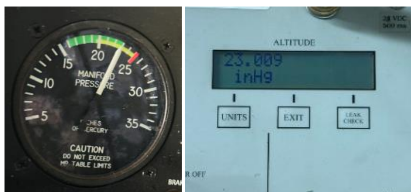
Rys. 19, 20. Przykład sprawdzenia wskazań wskaźnika ciśnienia ładowania.
