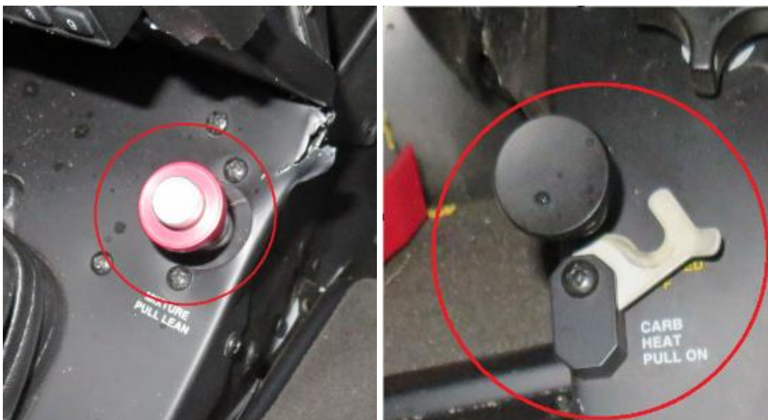
Rys. 2, 3. Dźwignia sterowania składem mieszanki w pozycji „pełni bogata” oraz odblokowany podgrzew gaźnika.
