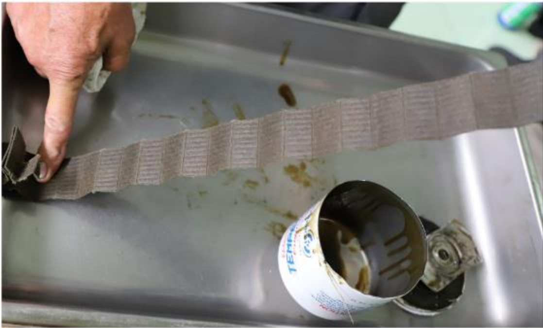
Rys. 16. Filtr oleju podczas sprawdzenia.
