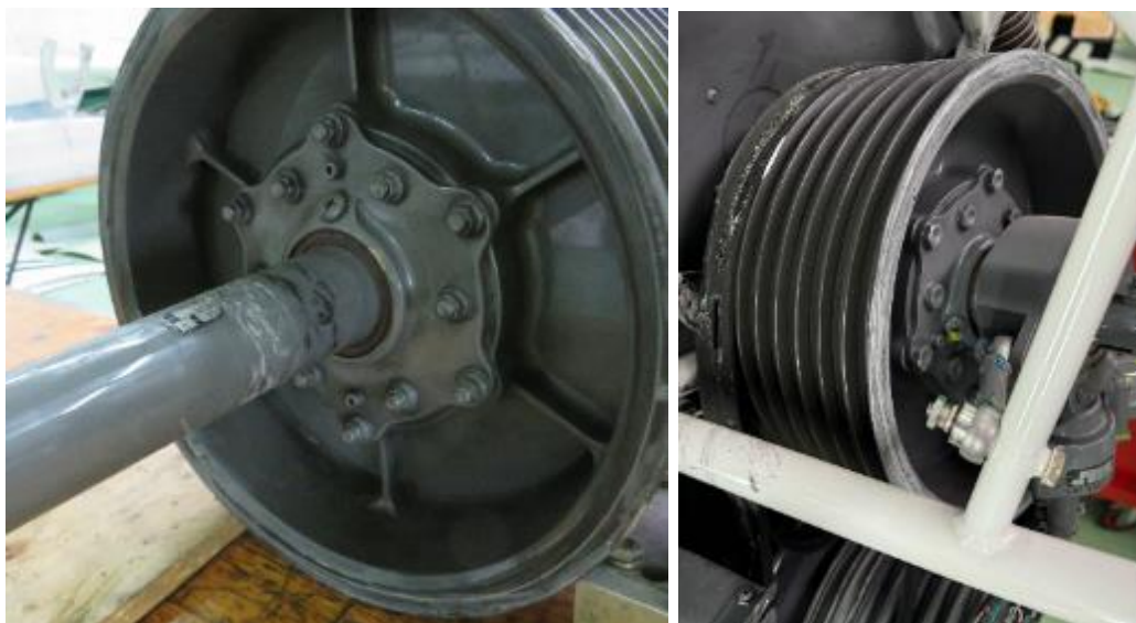
Rys. 6, 7. Wał sprzęgła oraz sprzęgło ze śladami świadczącymi, iż obracało się podczas niszczenia śmigłowca.
