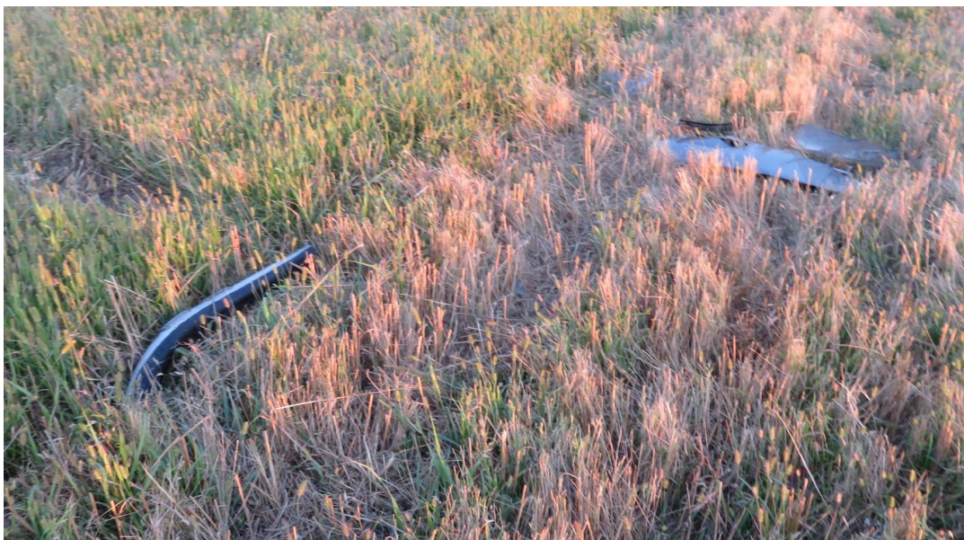
Rys. 17. Odseparowana lewa część płozy oraz lewe przednie drzwi.
