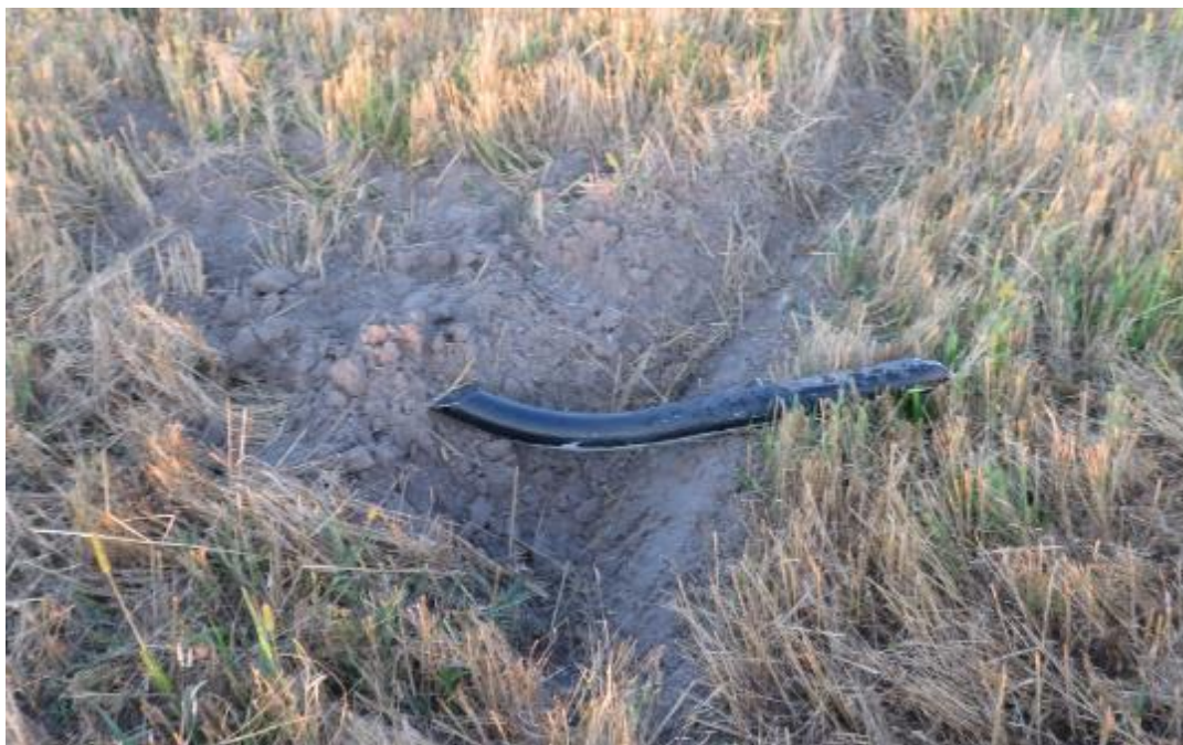
Rys. 16. Odseparowana prawa część płozy.
