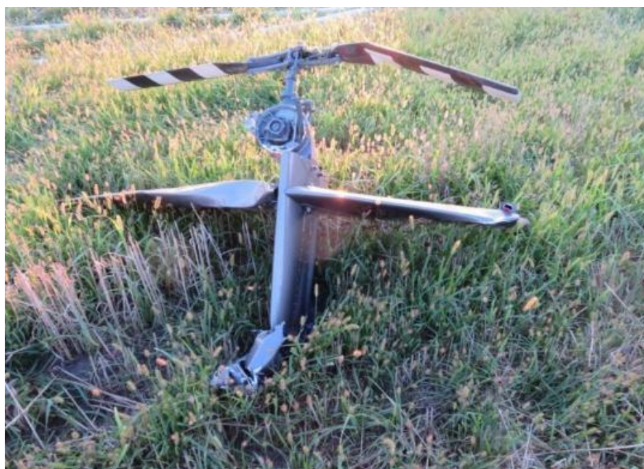
Rys. 14. Odseparowana przekładnia śmigła ogonowego wraz ze śmigłem ogonowym oraz statecznikami.
