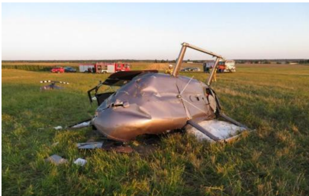
Rys.15. Widoczne uszkodzenia dolnej części kadłuba.
