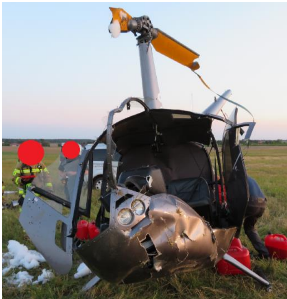
Rys.13. Zdeformowana kabina śmigłowca.
